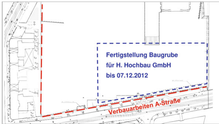
Abb. 8.15 Lageplanskizze der Baugrube für die H. Hochbau GmbH
