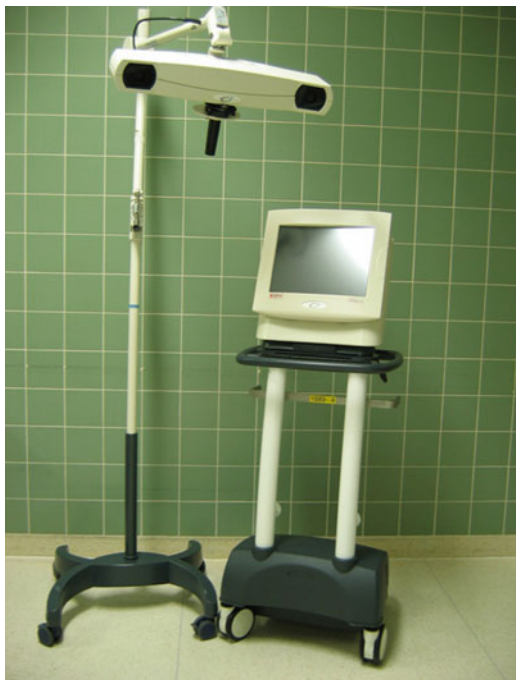
■ Abb. 4.3 Navigationsgerät mit Rechneinheit und Infrarotkamera. © BrainLAB
