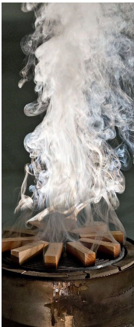
Holzschwelbrand. Im Brennraum des Prüflabors steigt der weiße Rauch von Buchenholz hoch zur Decke.
