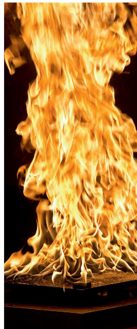
Flüssigkeitsbrand. Dichter, dunkler Rauch bildet sich, wenn der Kohlenwasserstoff Heptan verbrennt.
