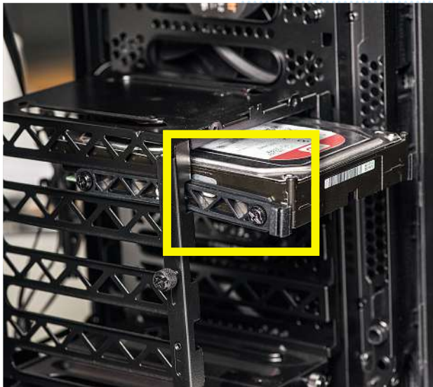
3,5-Zoll-HDDs schieben Sie mit angebrachter Laufwerkschiene in den Schacht – die Anschlüsse voraus
