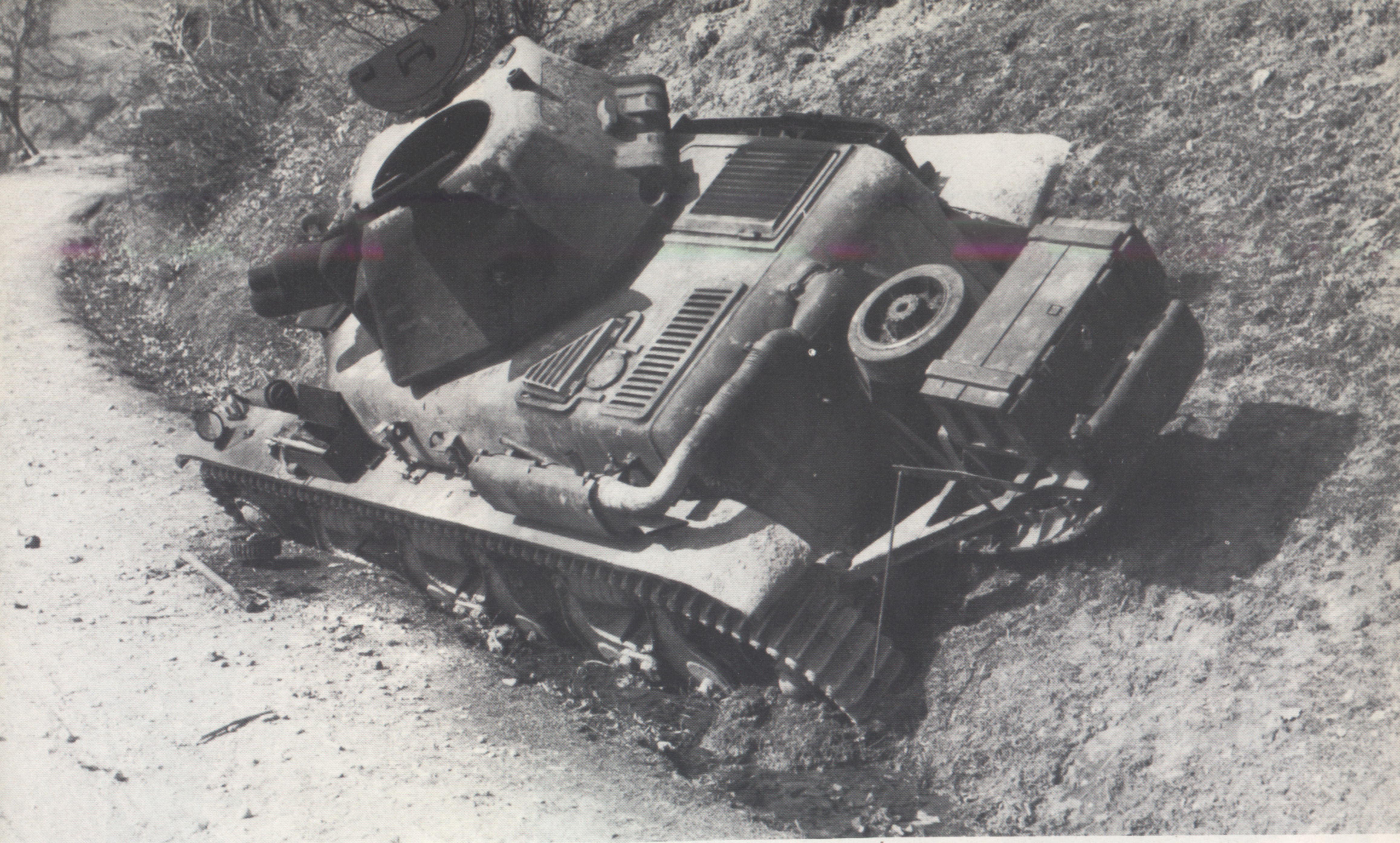
Auf dem Balkan kamen mit der Pz.Kp. z.b.V. 12 insgesamt 25 R 35 zum Einsatz. Bei den Panzern dieser Kompanie wurden die Turmkuppeln entfernt und durch eine zweiteilige Luke ersetzt. Die Türme haben noch die alten wulstartigen Binokulare eingebaut. (BA)
