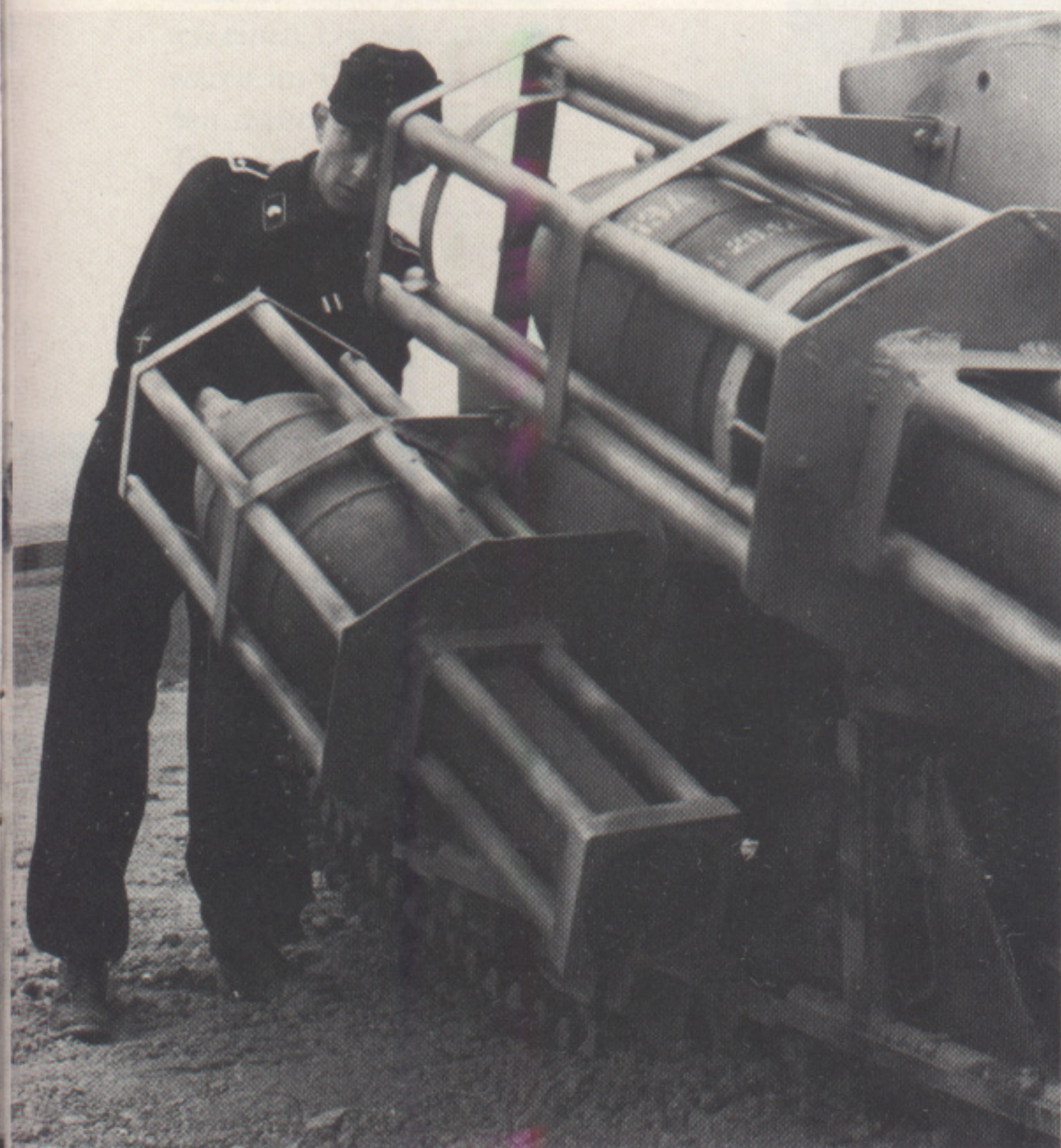
Dieses Photo zeigt sehr gut die Abschußgestelle für die Wurfkörper-Geschosse. Ein Waffenfeldwebel schraubt die Zünder in die Wurfkörper. (BA)
