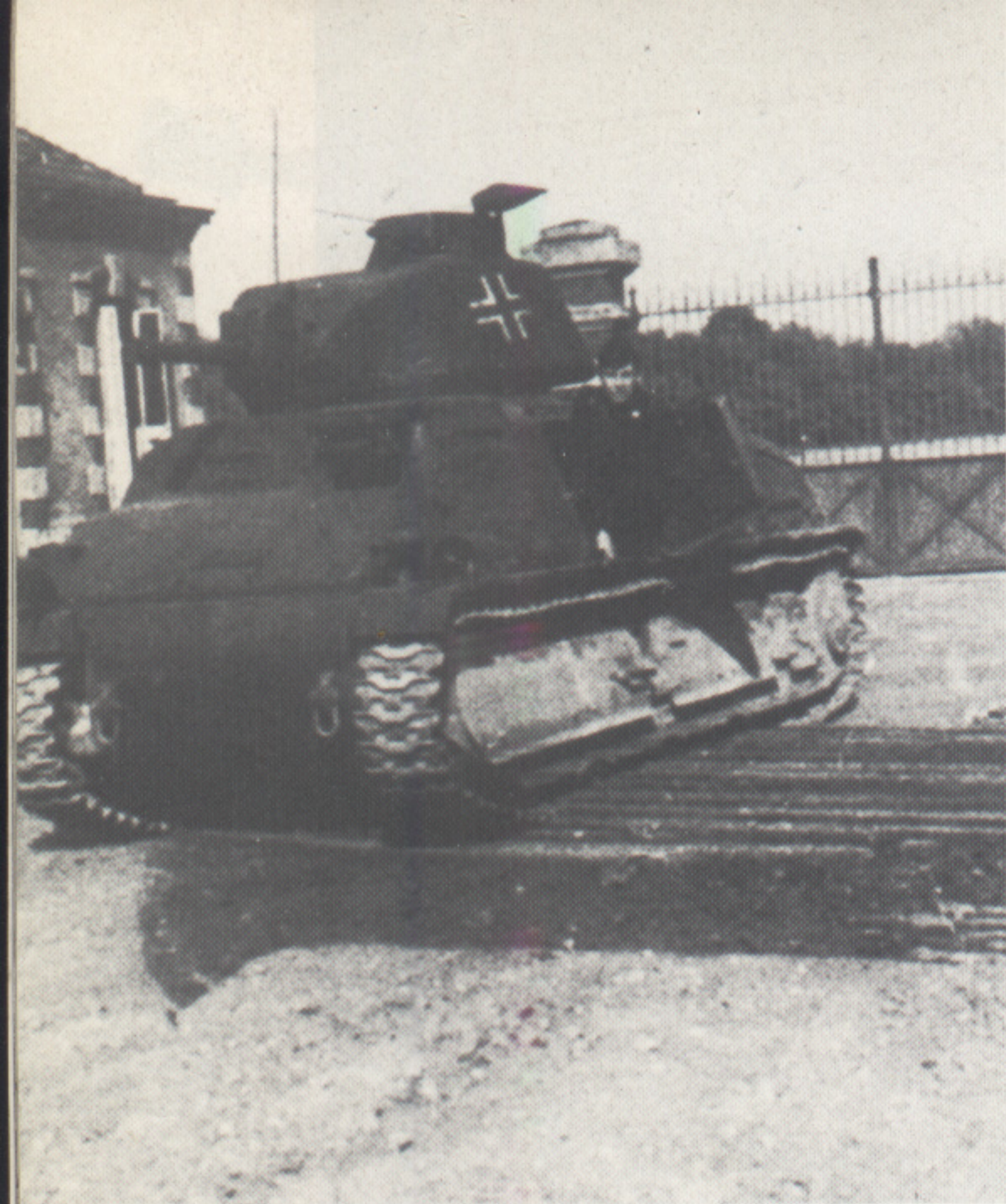
Um dem Kommandanten das Führen des Panzers durch bessere Sicht zu erleichtern, wurden auch die Turmkuppeln der S 35 gekappt und mit einer zweiteiligen Luke versehen. An der linken Seite die große Einstiegstür für Fahrer und Ladeschützen. (AB)
