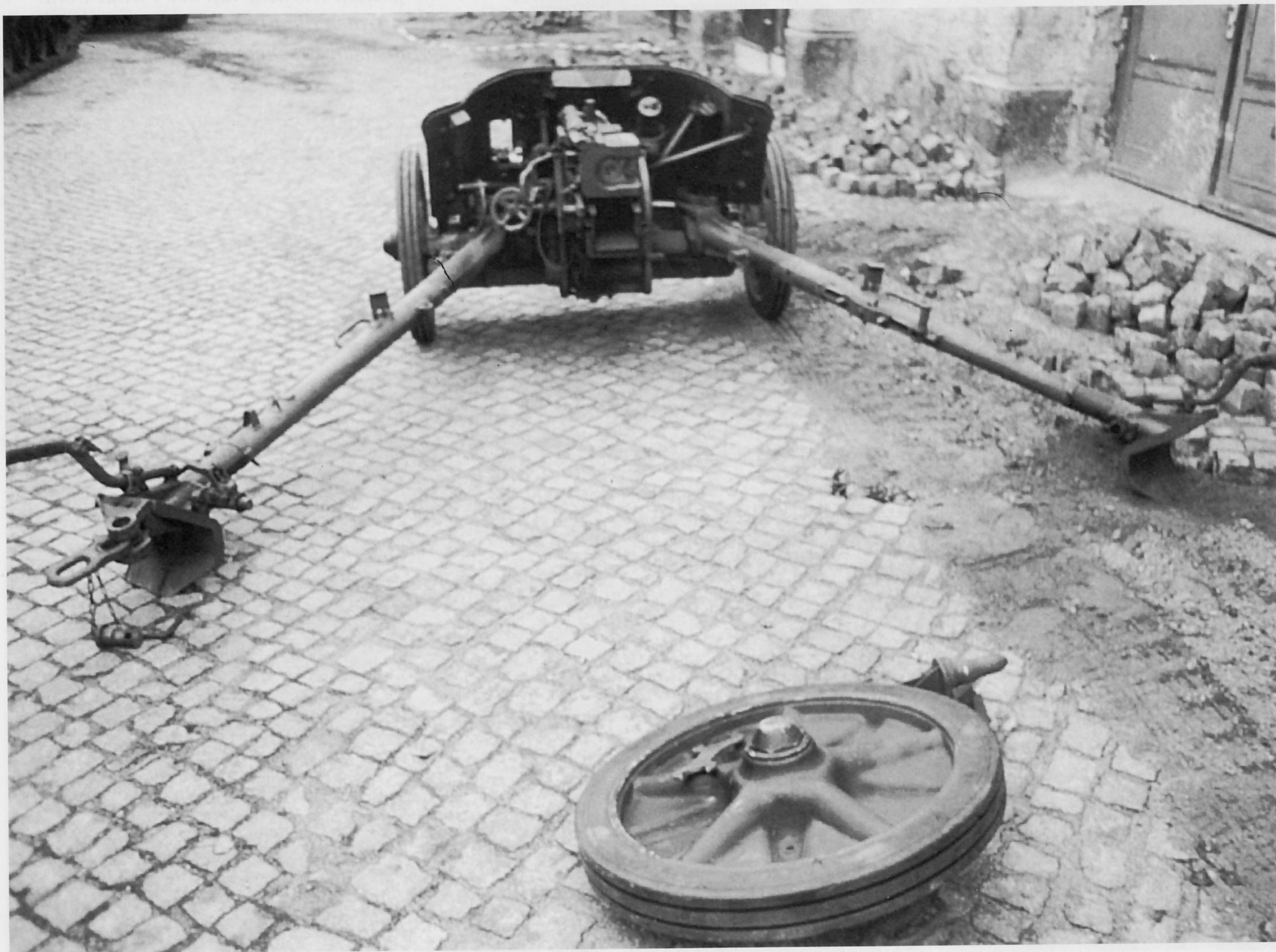
Das Geschütz in Feuerstellung mit abgespreizten Holmen und dahinter abgelegtem Spornrad. In Schießstellung wurden die Holme einzeln mit der Achse verriegelt. Das Schutzschild war schußsicher und bot der Bedienung Schutz vor dem Beschuß mit Infanteriemunition aus allen Entfernungen.
