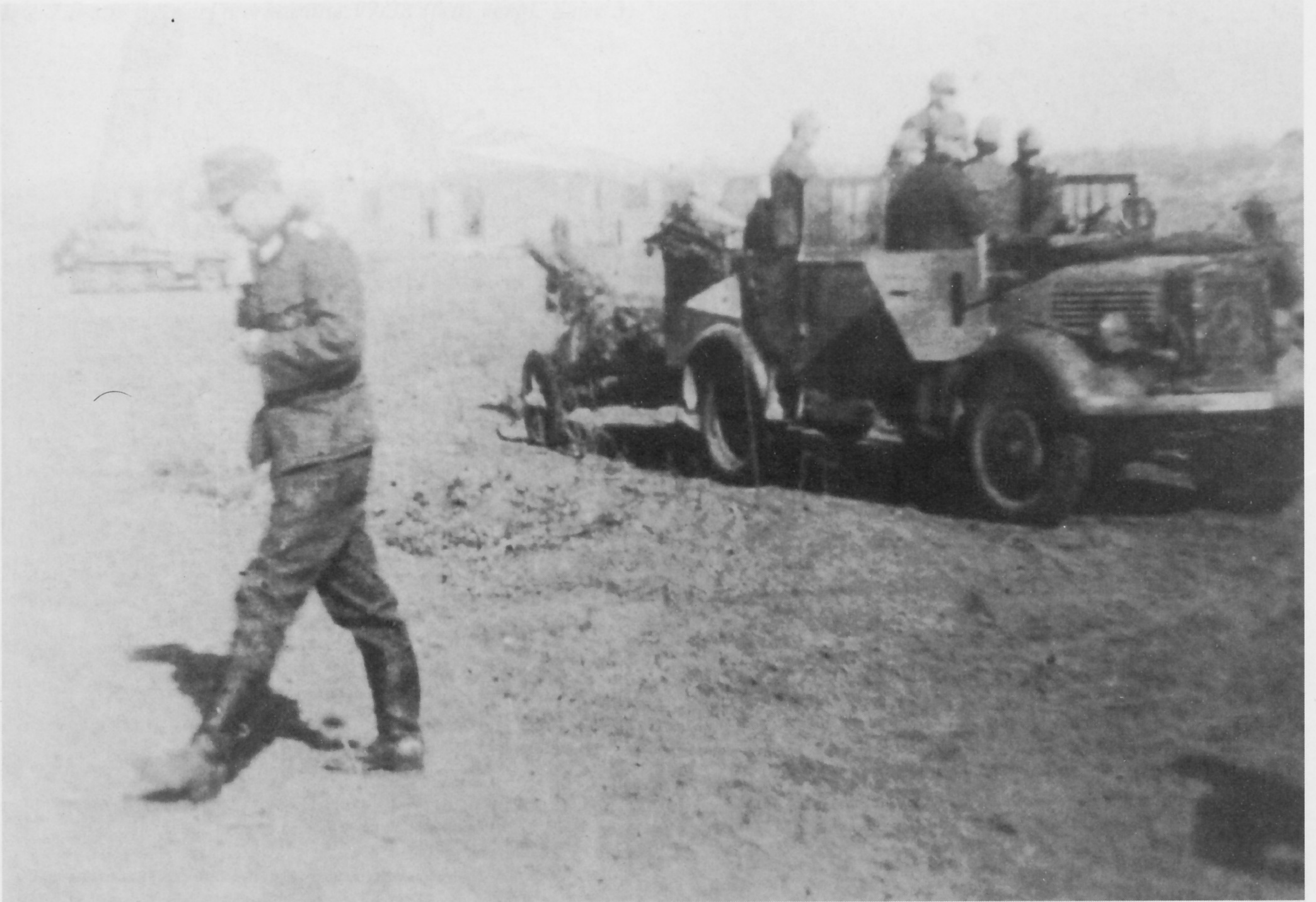
Neben den bereits erwähnten Halb- und Vollkettenzugmitteln traten im Kriegsverlauf verschiedene Kraftfahrzeuge als Zugfahrzeuge für die 5-cm-Panzerjägerkanone 38 in Erscheinung. Dazu gehörte der schwere geländegängige Personenkraftwagen Mercedes Benz L 1500 A (im Bild) und der französische Laffly-Licorce V 15 R, ein erbeutetes Fahrzeug mit vergleichbaren Leistungen.
