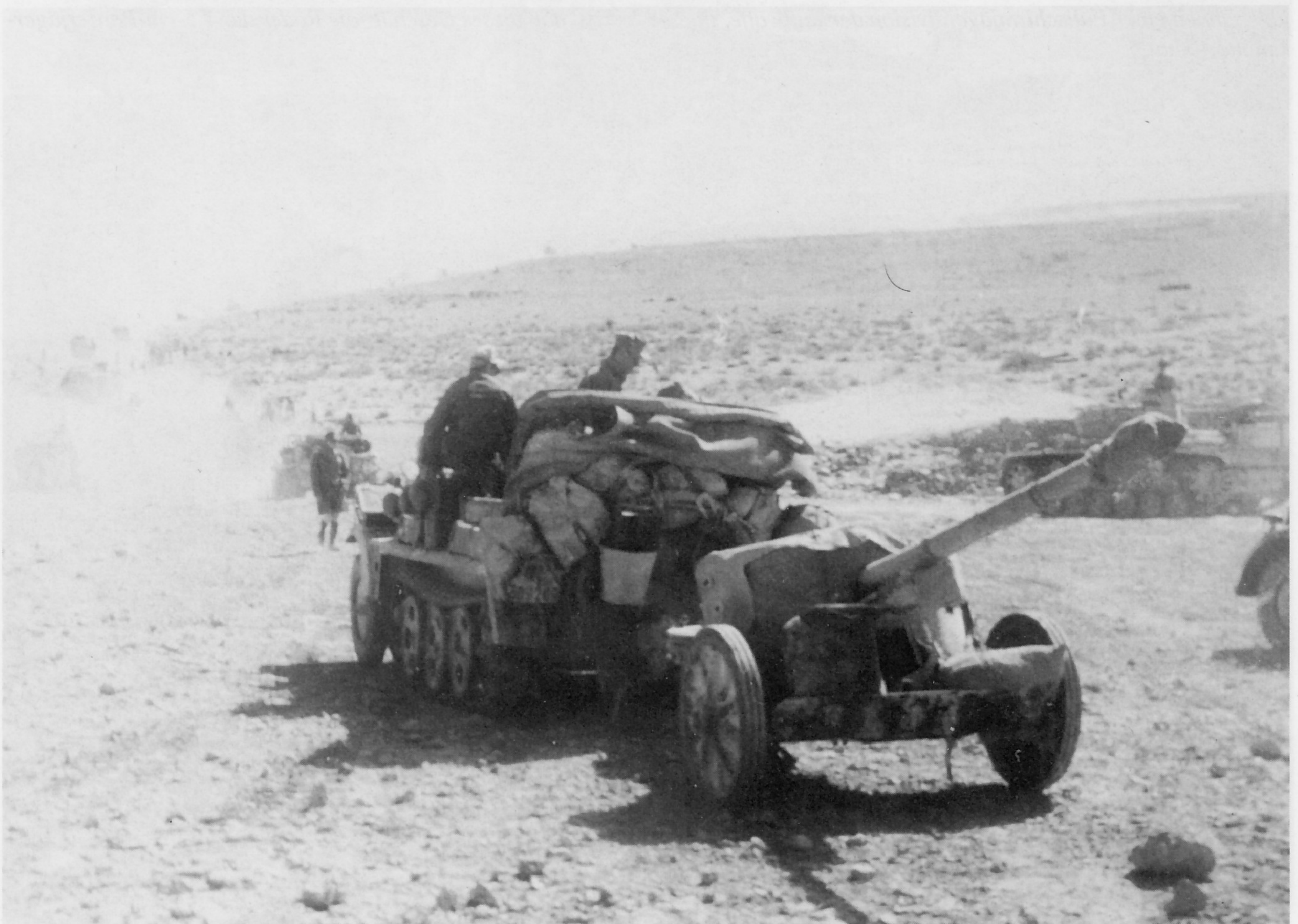
Aufnahme vom Kriegsschauplatz Nordafrika, Frühjahr 1941. Zum Schutz vor dem Wüstensand wurde das Geschütz (ab Schutzschild) mit einem "Marschüberzug" versehen. Auch die Mündungsbremse erhielt eine Schutzhülle.
