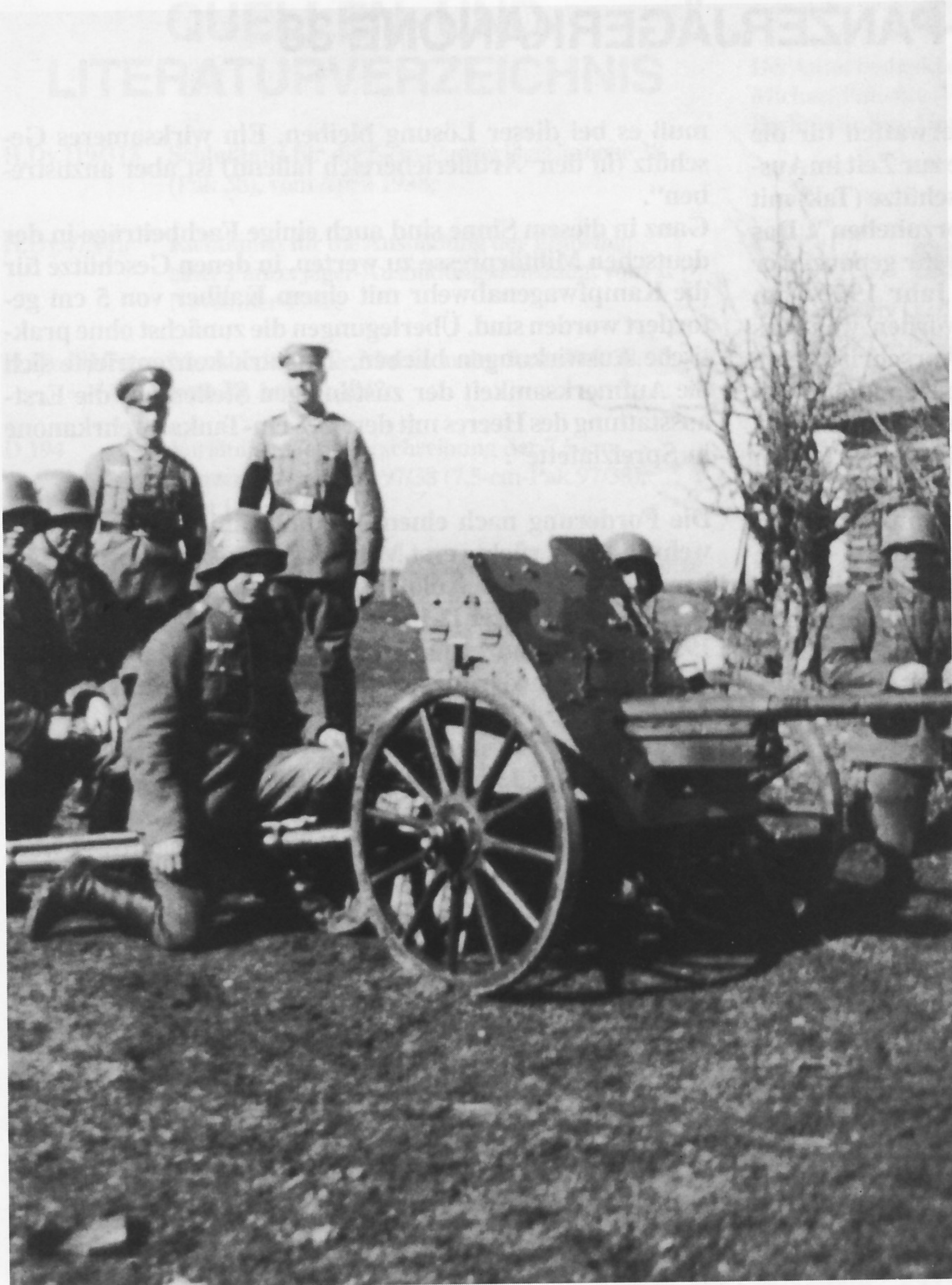
Ihre Wirksamkeit ist bereits zum Zeitpunkt der Einführung in die Reichswehr in Zweifel gezogen worden - die 3,7-cm-Tankabwehrkanone L/45 in Spreizlafette. Das Bild zeigt die frühe, für den bespannten Zug eingerichtete Ausführung.
