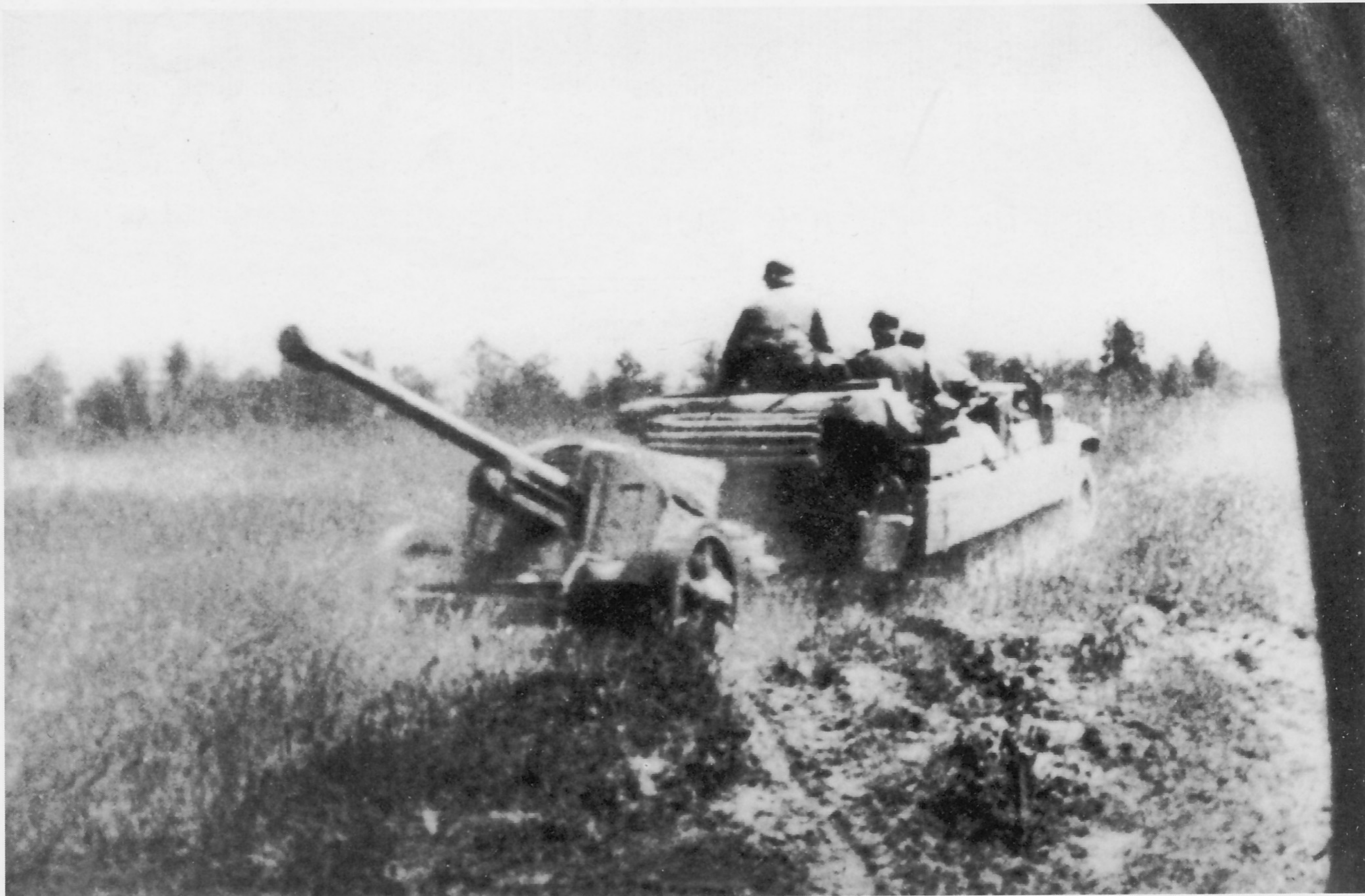
Eine 5-cm-Panzerjägerkanone 38 hinter einem leichten Zugkraftwagen 1 t Demag D 7 (Sd.Kfz.10). Die Aufnahme entstand Ende Juni 1941 an der Ostfront aus der linken Turmluke eines Panzerkampfwagens IV (Sd.Kfz.161).
