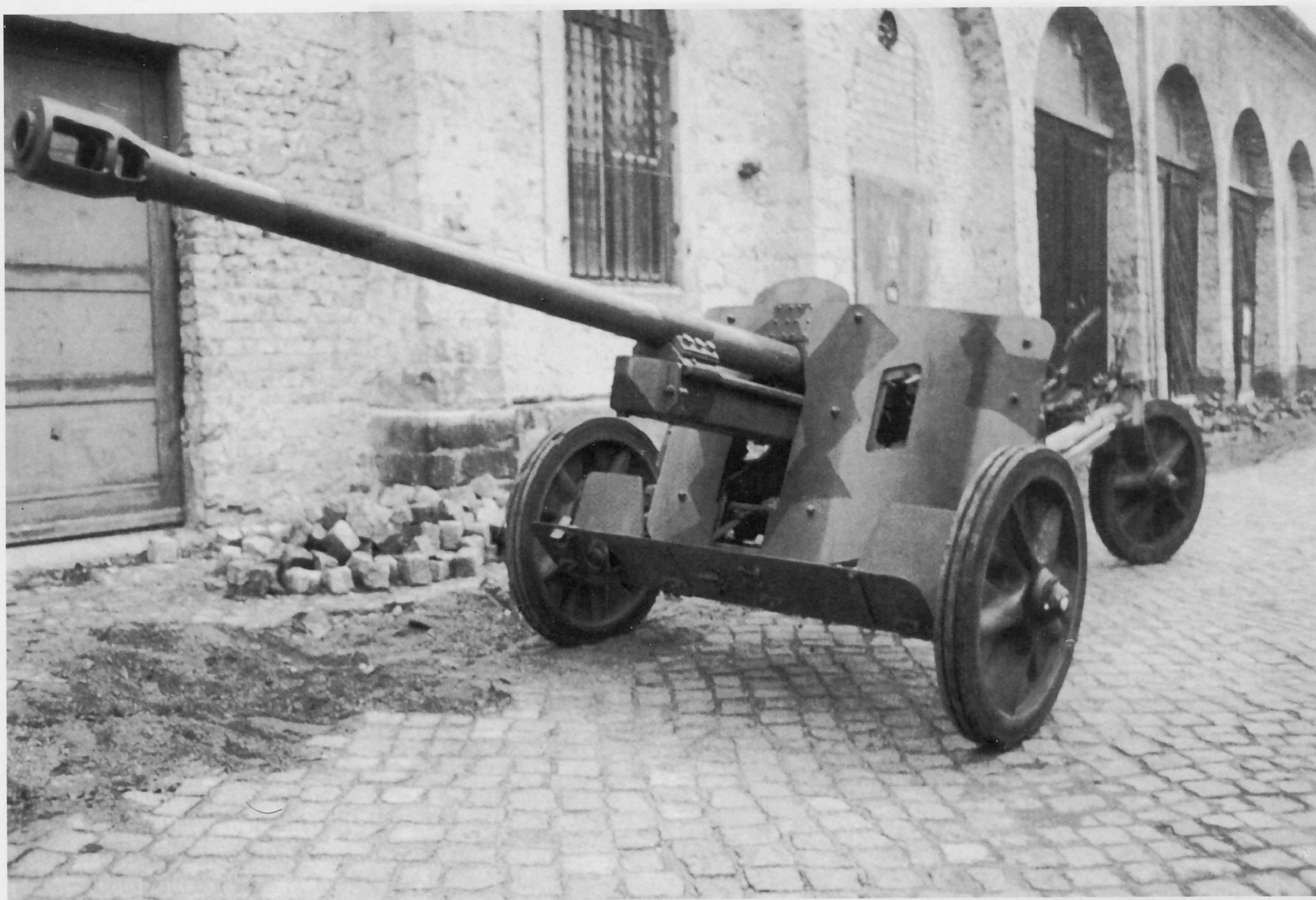
Die hier gezeigte 5-cm-Panzerjägerkanone 38 hat die Rohrnummer 634 und ist 1941 hergestellt worden. Von der Firma Continental kamen die Hartgummibandagen 800x90 für die Gußräder. Als Hersteller der Räder traten die Firmen Metallwerk Karl Michler GmbH aus Leipzig (bev) und Christoph & Unmack AG aus Niesky in der Oberlausitz in Erscheinung.
