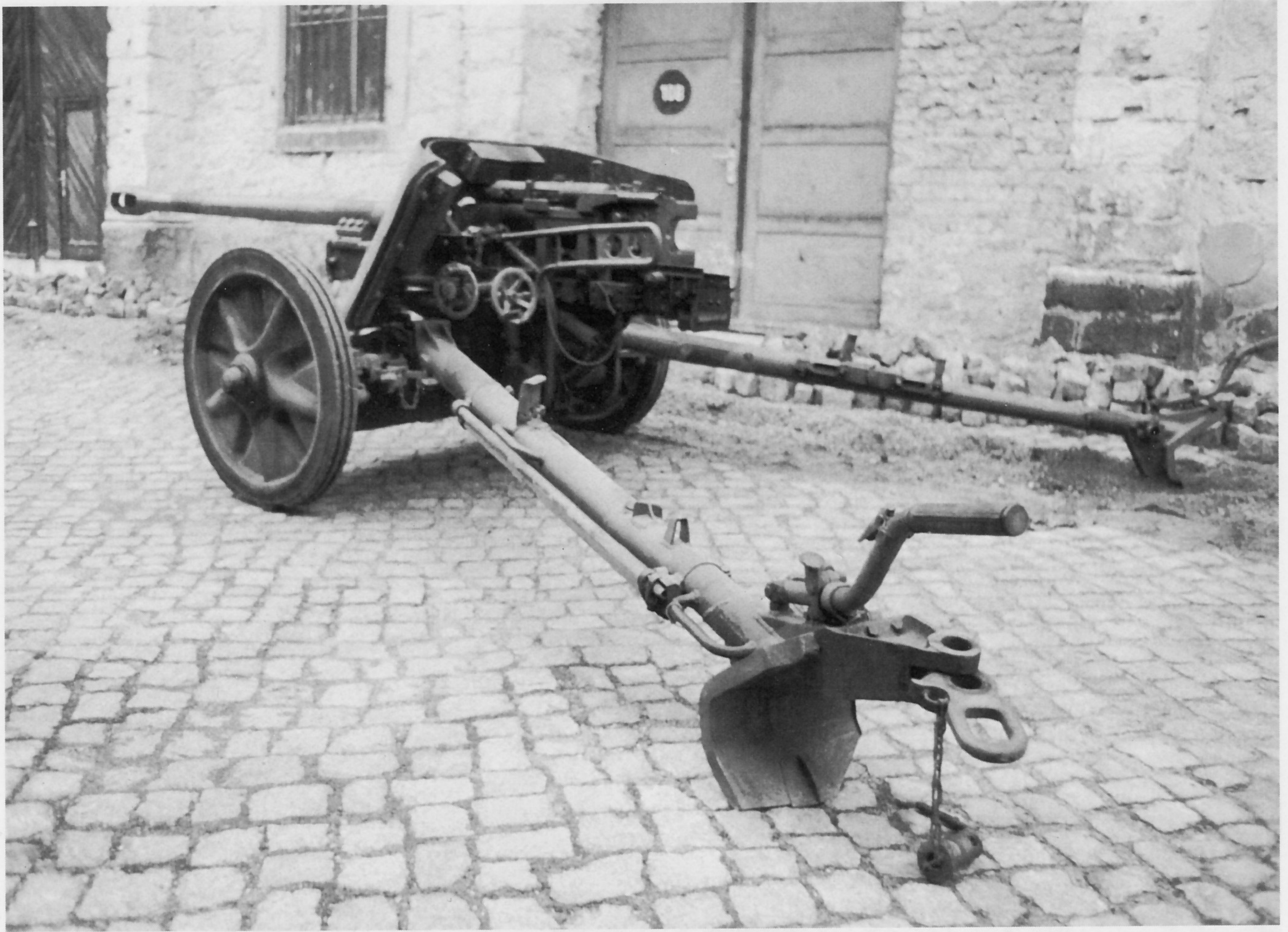
Das Geschützrohr gliederte sich in das Patronenlager und den gezogenen Teil. Letzterer hatte 20 Züge mit zunehmenden Rechtsdrall. Auf die Rohrmündung aufgeschraubt war die Mündungsbremse, ohne die nicht geschossen werden durfte.
