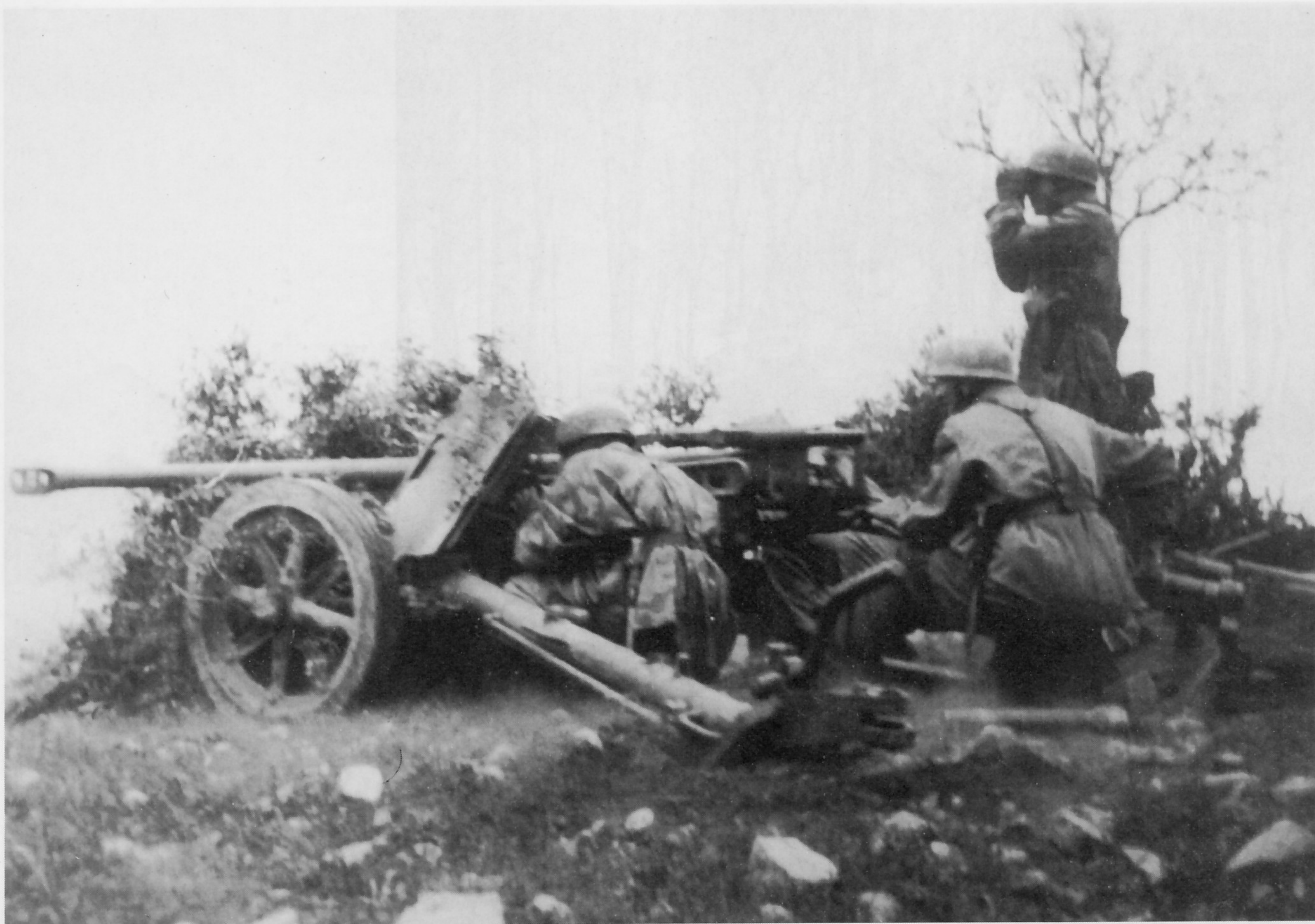
Diese Aufnahme entstand auf dem italienischen Kriegsschauplatz und zeigt eine 5-cm-Panzerjägerkanone 38 bei einer Panzerjägerereinheit einer Fallschirmjägerdivision der Luftwaffe. Interessant ist, daß dieses Geschütz die Räder der 7,5-cm-Panzerjägerkanone 40 hat.
