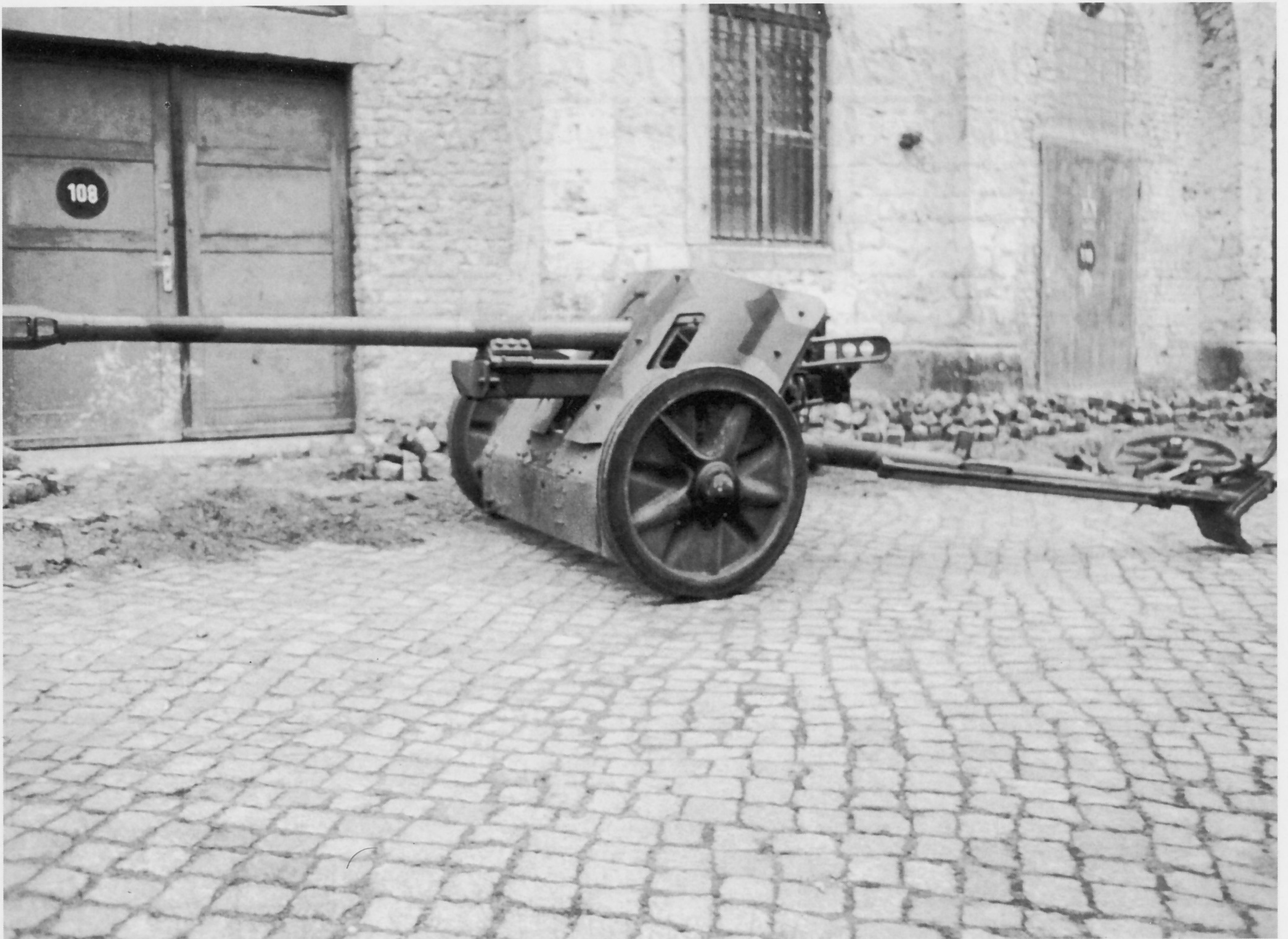
Bei der Auswahl der Feuerstellung war anzustreben, daß die Räder auf einer waagerechten Fläche standen, um ein Verkanten des Rohres zu vermeiden. Die beiden Holme mußten auf dem Erdboden aufliegen.
