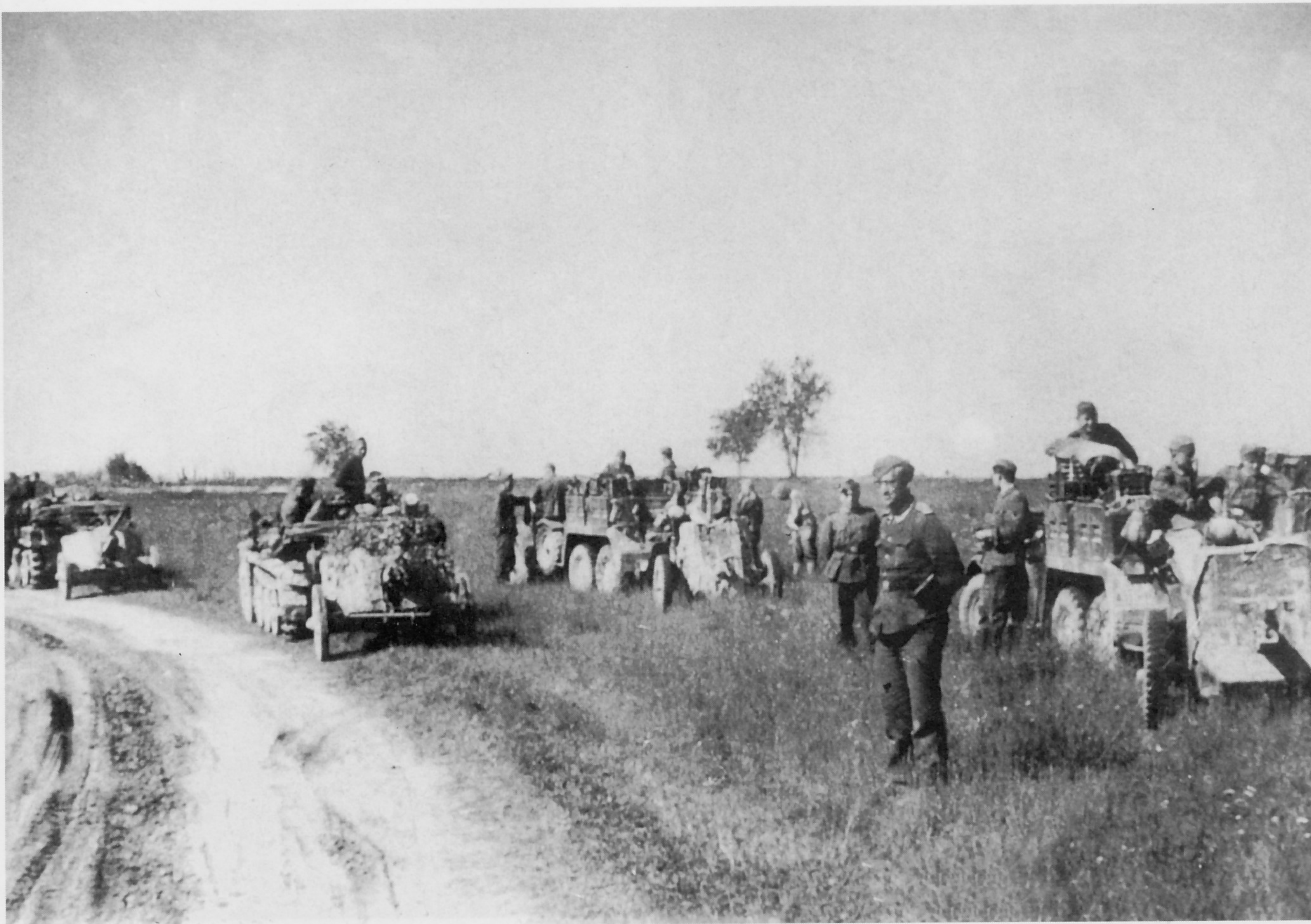
Links im Bild der 5-cm-Panzerjägerzug einer Panzerjägerkompanie. Er verfügt über 1-t-Zugkraftwagen als Zugmittel. Rechts Teile eines Zuges mit 3,7-cm-Panzerjägerkanonen. Hier reichte der leichte geländegängige Lastkraftwagen 1 t Krupp L 2 H 143 (Kfz. 69) als Zugmittel aus. Ostfront, Sommer 1941.
