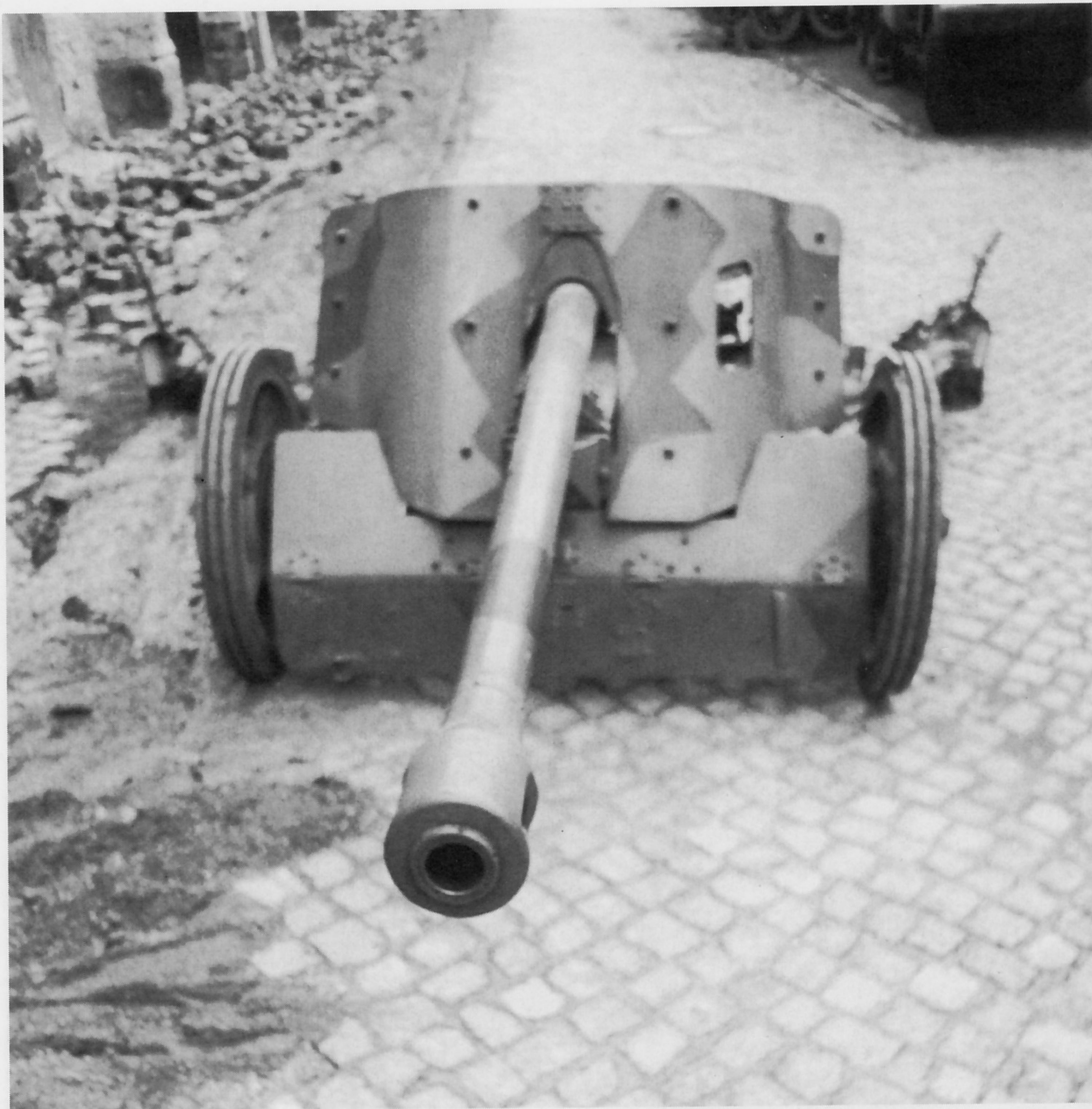
Das Geschütz in Feuerstellung mit abgespreizten Holmen und dahinter abgelegtem Spornrad. In Schießstellung wurden die Holme einzeln mit der Achse verriegelt. Das Schutzschild war schußsicher und bot der Bedienung Schutz vor dem Beschuß mit Infanteriemunition aus allen Entfernungen.
