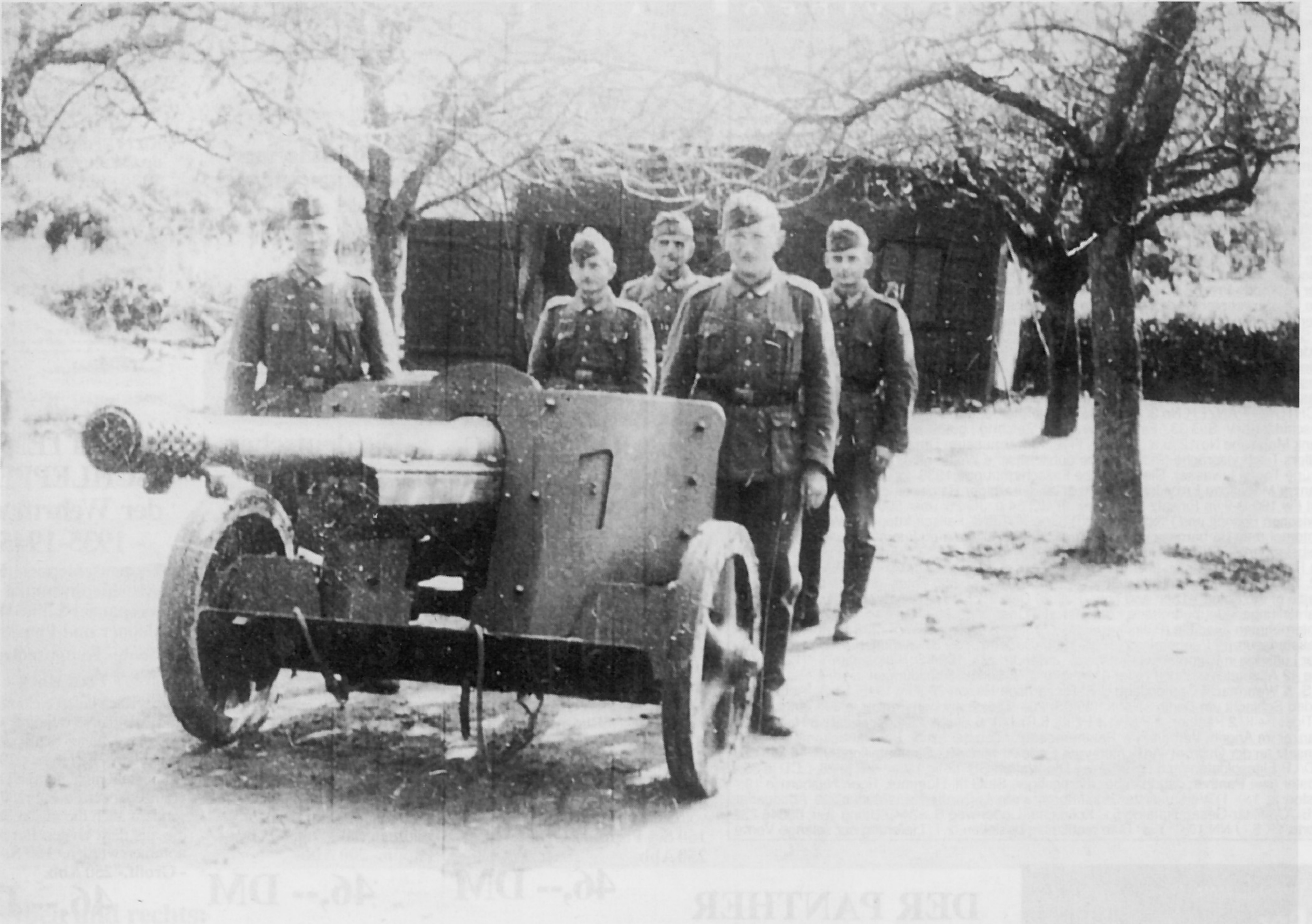
Bereits 1942 führten einzelne Infanterie-Panzerjägerkompanien als Teileinheiten schwere Züge mit zwei 7,5-cm-Panzerjägerkanonen 97/38. Die Geschütze wurden sechsspännig hinter einer Protze (Itf.14) gefahren.
