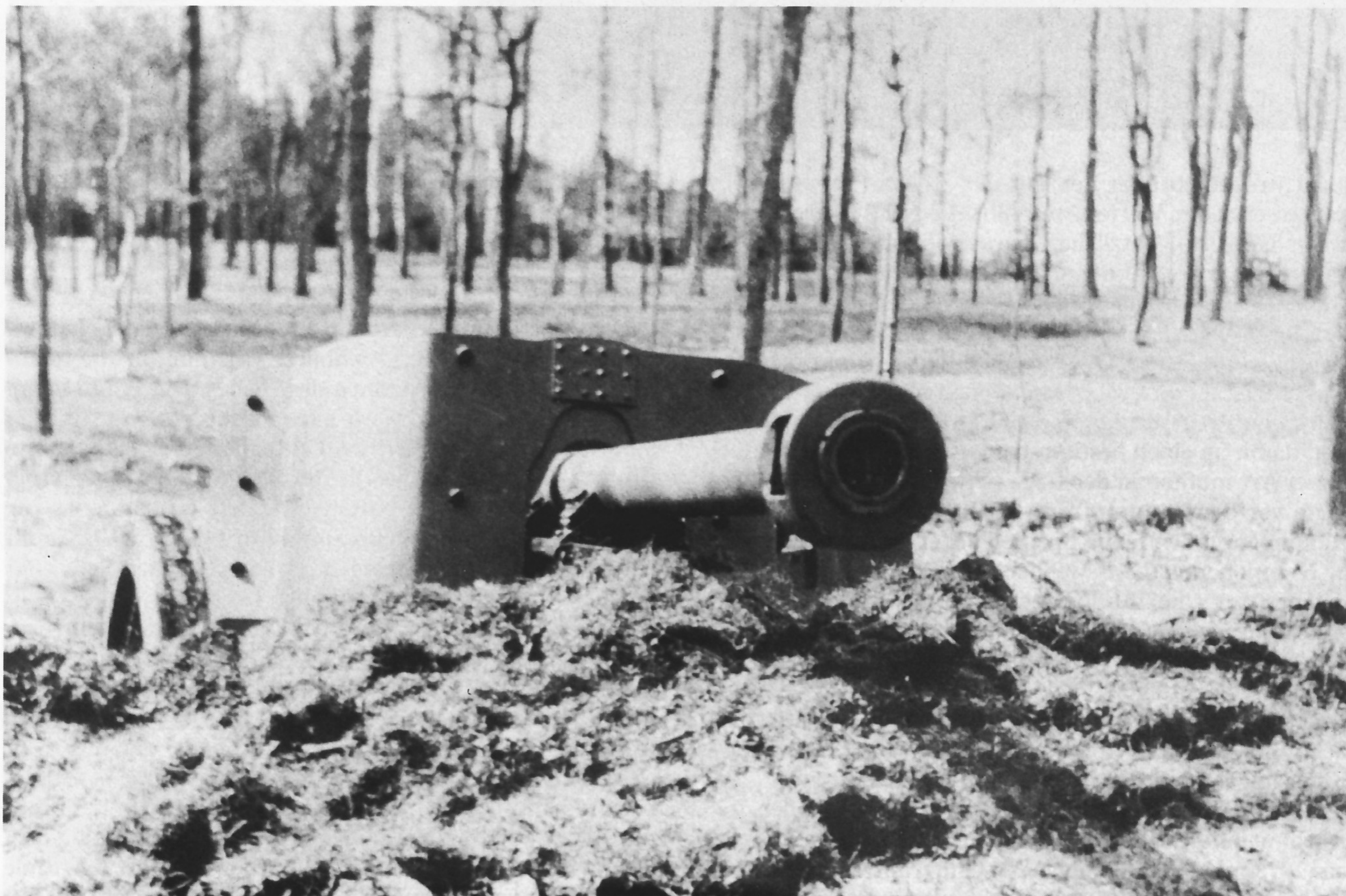
Die 5-cm-Panzerjägerkanone in Lauerstellung. Zu den charakteristischen Merkmalen des Geschützes gehörte die doppelt wirkende Mündungsbremse. Das Schutzschild bestand aus zwei, hintereinander angeordneten 4 mm starken Panzerplatten.
