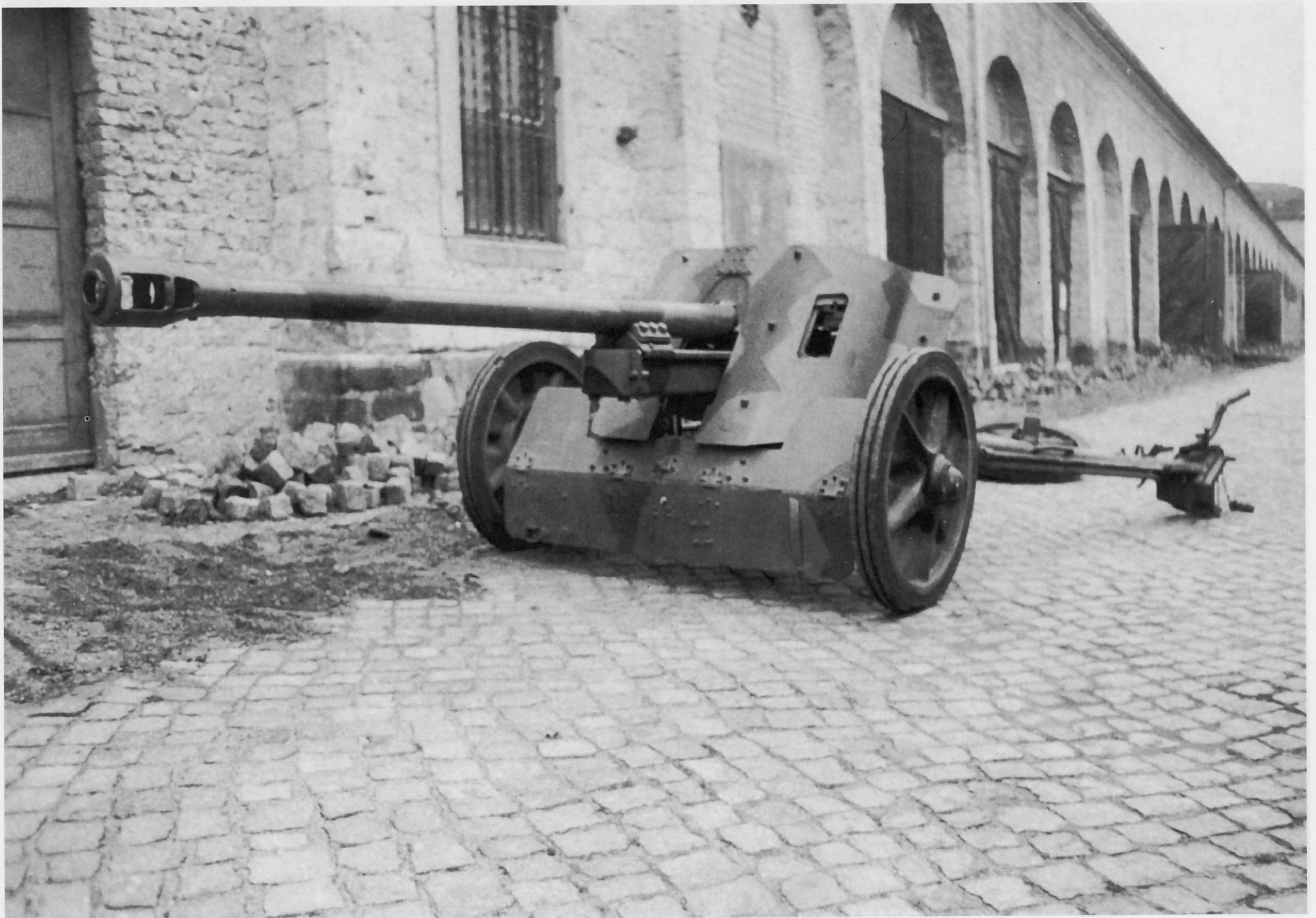
Das Geschützrohr gliederte sich in das Patronenlager und den gezogenen Teil. Letzterer hatte 20 Züge mit zunehmenden Rechtsdrall. Auf die Rohrmündung aufgeschraubt war die Mündungsbremse, ohne die nicht geschossen werden durfte.
