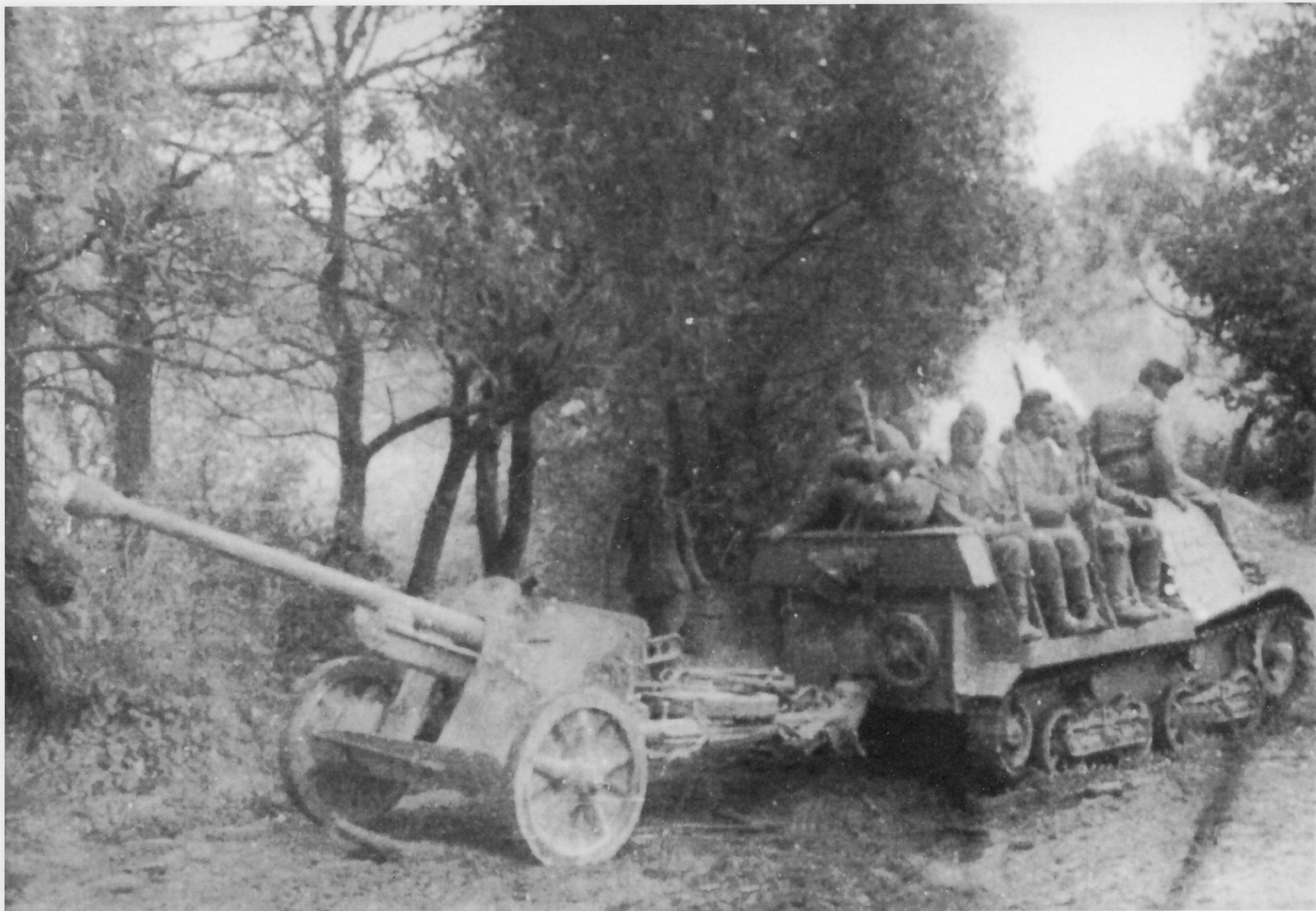
Als Ersatz für den leichten Zugkraftwagen 1 t Demag D 7 (Sd.Kfz.10) kamen bei einigen Panzerjägereinheiten erbeutete leichte gepanzerte Artillerieschlepper 630(r) - russ. Komsomoletz - zum Einsatz. In der Roten Armee waren diese Fahrzeuge u.a. als Zugmittel für leichte Panzerabwehrgeschütze verwendet worden.
