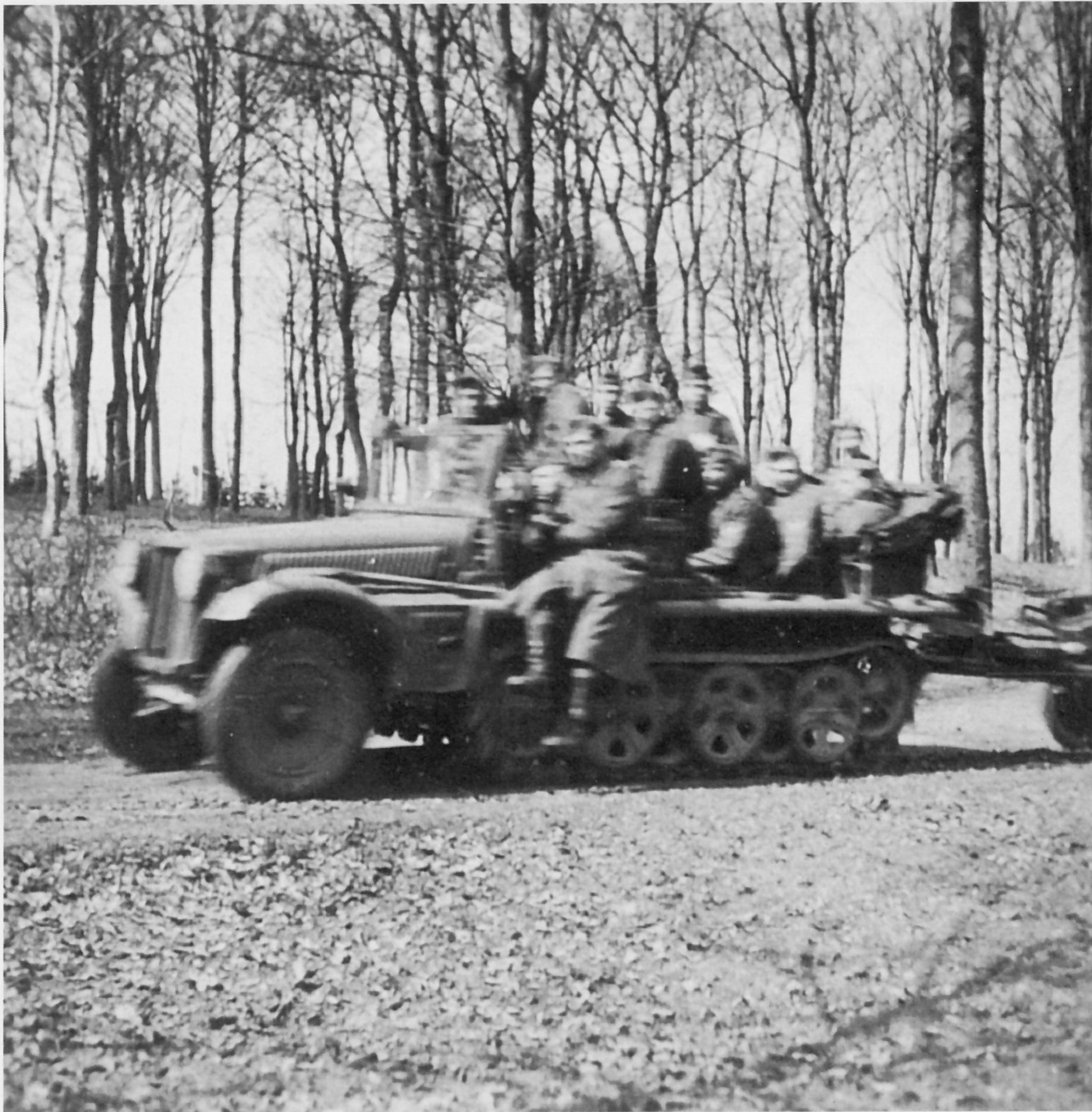
Als Zugmittel für die 5-cm-Panzerjägerkanone 38 diente der leichte Zugkraftwagen 1 t Demag D 7 (Sd.Kfz.10). Aufnahme vom Frühjahr 1941.
