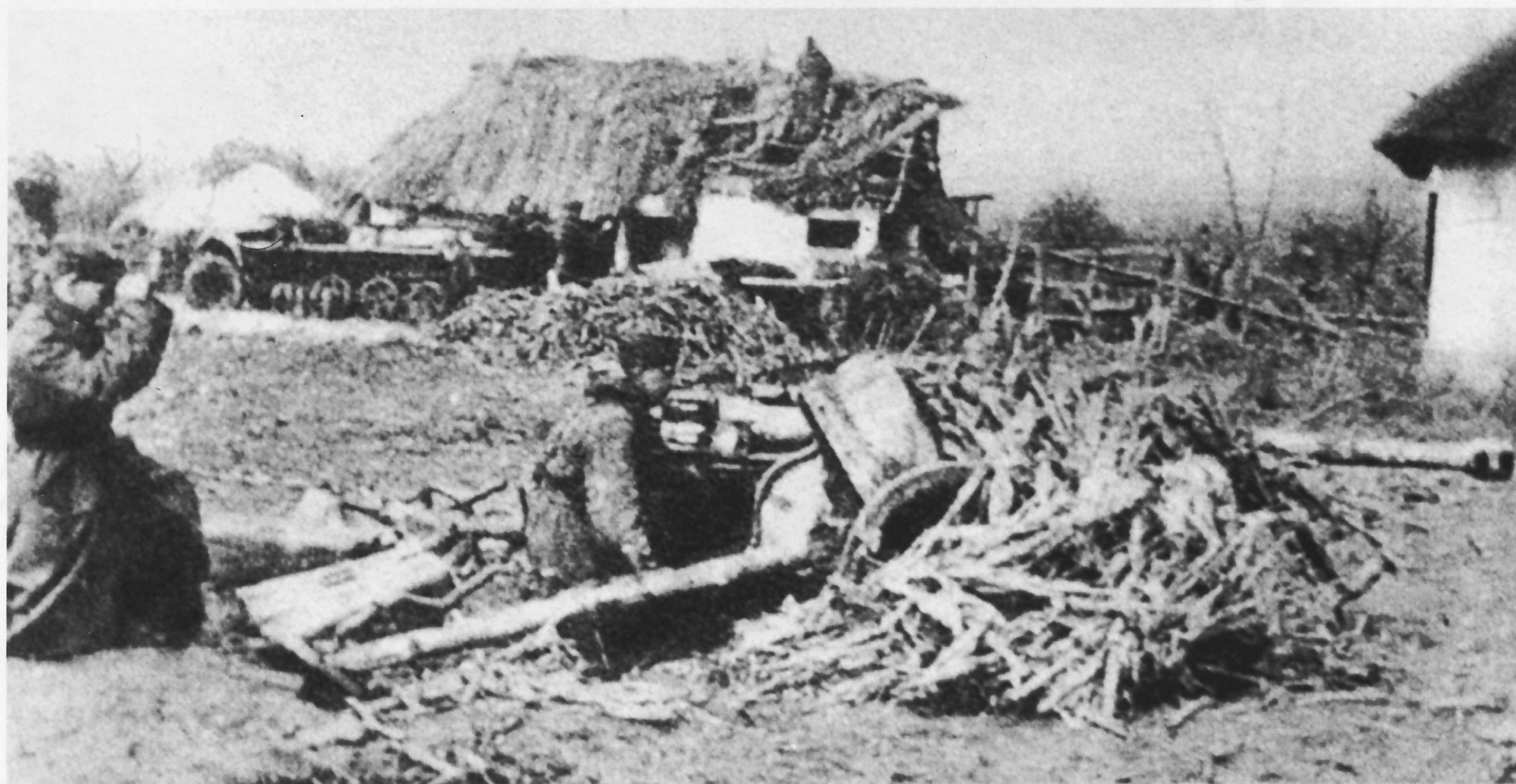
In getarnter Feuerstellung. Hinter der 5-cm-Panzerjägerkanone 38 ist das, im Schutze eines Bauernhauses bereit gehaltene Zugmittel, ein Zugkraftwagen 1 t Demag D 7 (Sd.Kfz.10) zu sehen. Aufnahme von der Ostfront, Frühjahr 1944.
