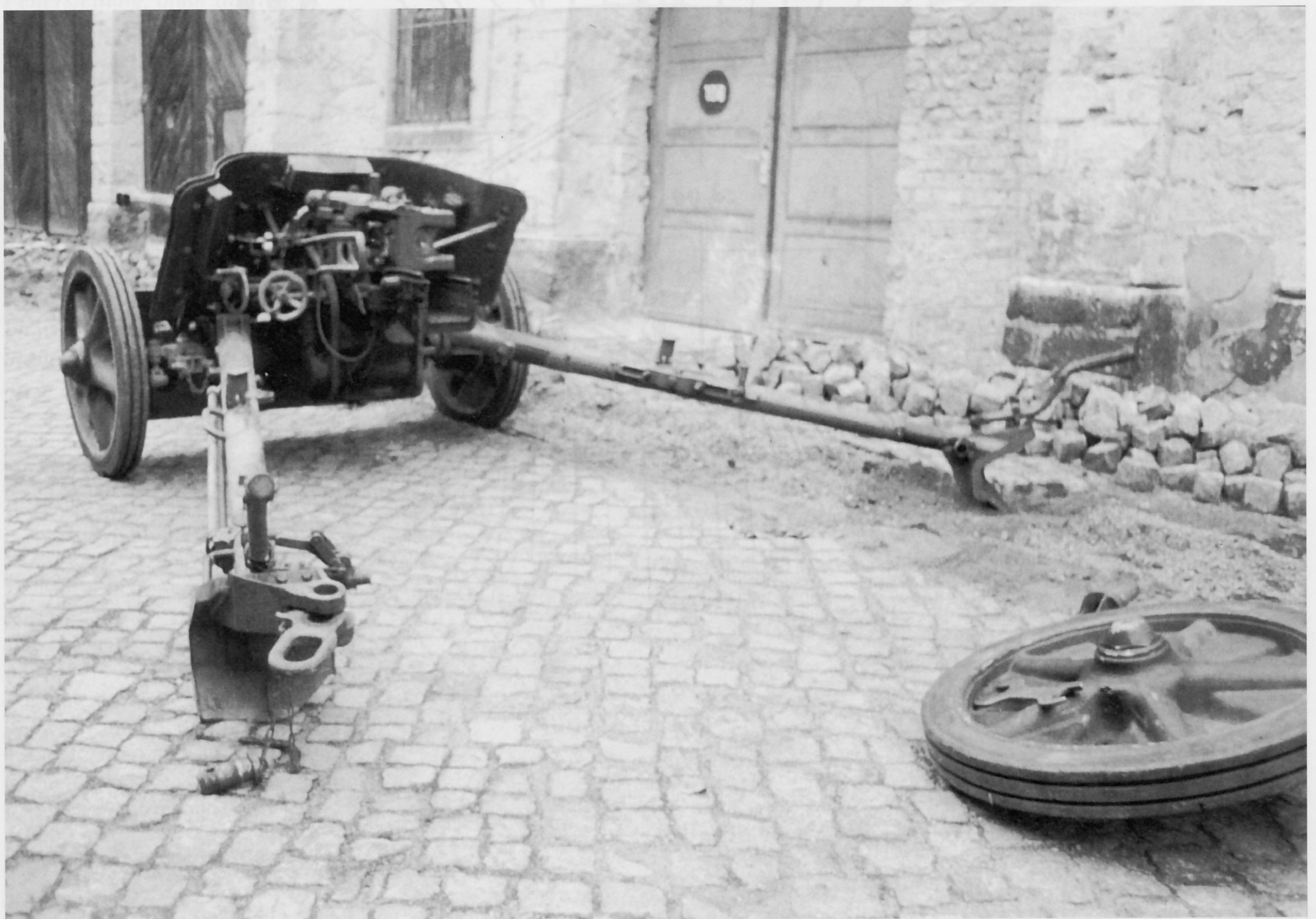
Bei der Auswahl der Feuerstellung war anzustreben, daß die Räder auf einer waagerechten Fläche standen, um ein Verkanten des Rohres zu vermeiden. Die beiden Holme mußten auf dem Erdboden aufliegen.
