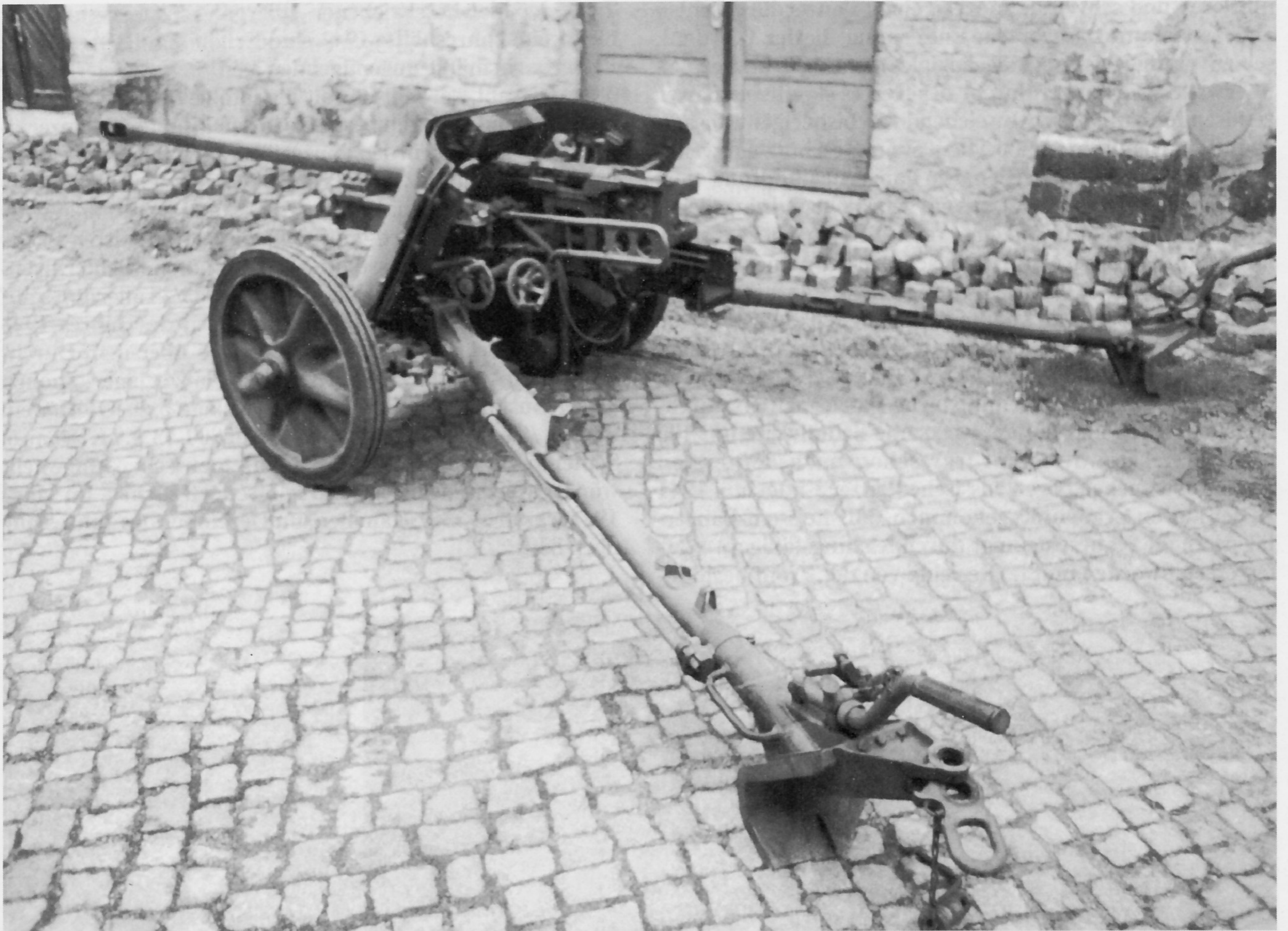
Die Feuerhöhe der 5-cm-Panzerjägerkanone 38 ist mit 820 mm angegeben. Dem Richtschützen standen die Zieleinrichtung 38 oder 38 A mit dem Zielfernrohr 3x8° zur Verfügung.
