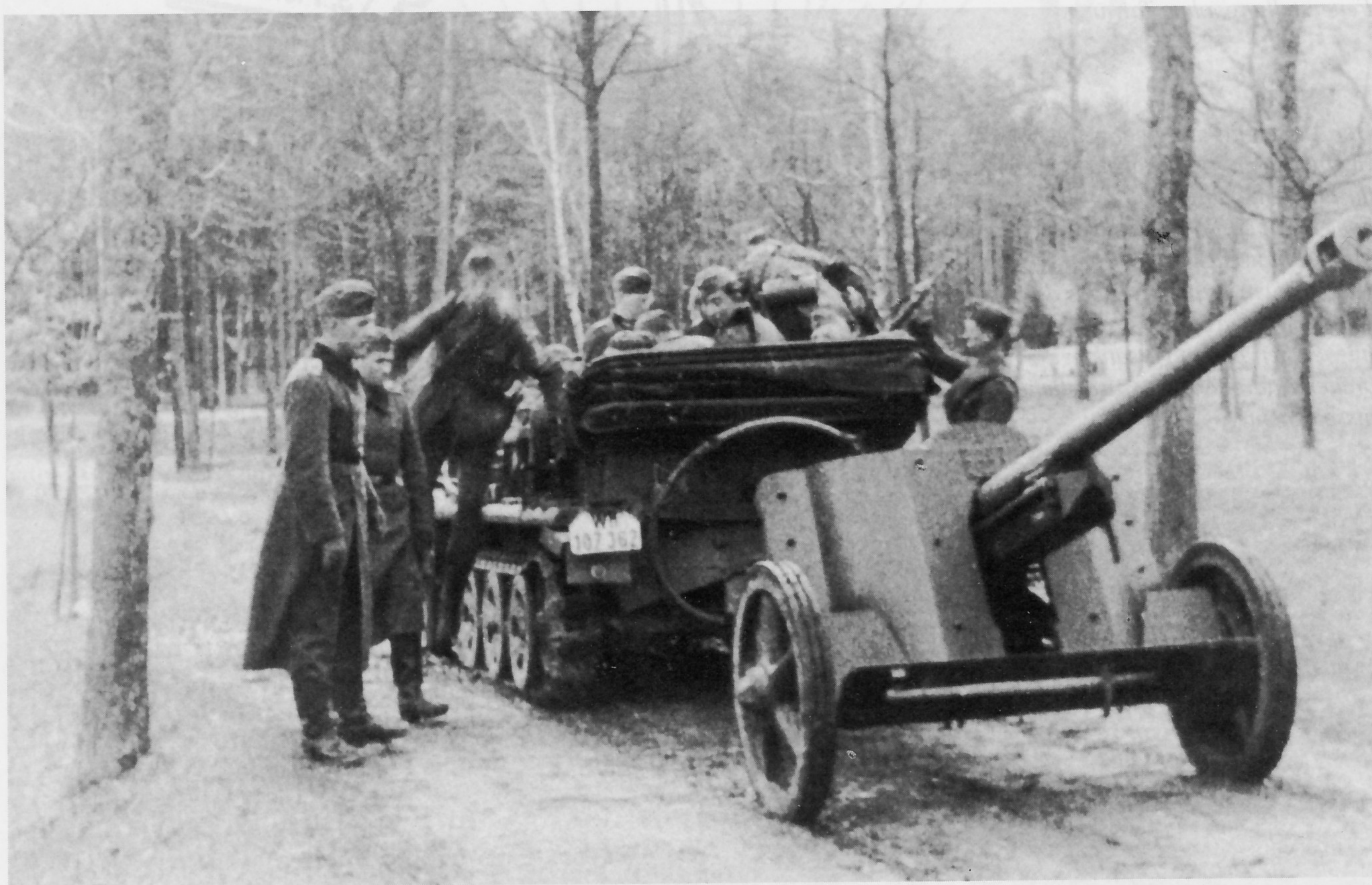
Das Gewicht der 5-cm-Panzerjägerkanone 38 in Fahrstellung ist in den Datenblättern des Heeres von 1944 mit 1062 Kg angegeben. Für die Herstellung benötigte man 2677 Kg Eisen, etwa 100 Kg andere metallische Rohstoffe und über 35 Kg Kautschuk. 1800 Arbeitsstunden waren für ein Geschütz erforderlich. Der Herstellungspreis lag bei 10600,- Reichsmark.
