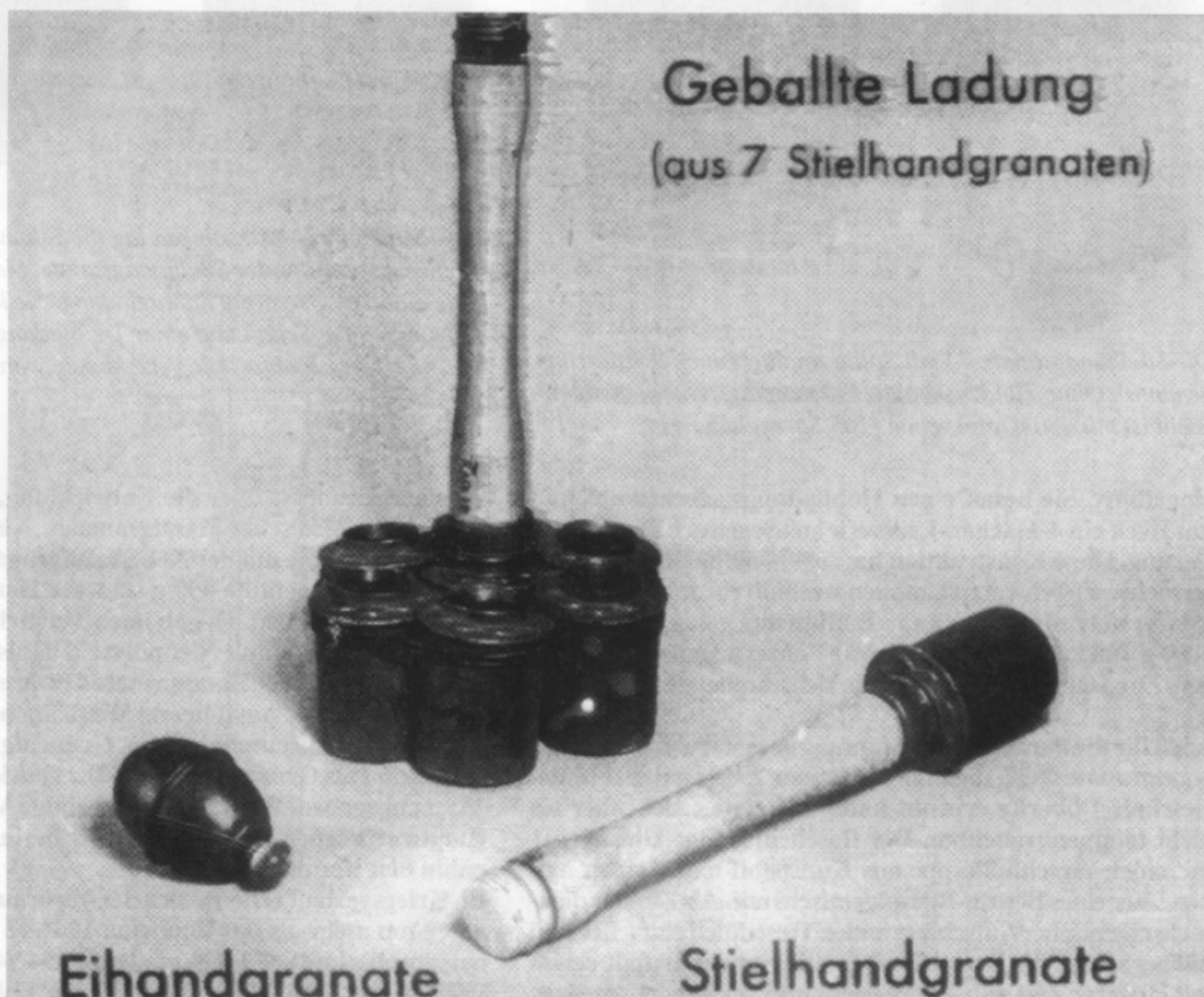
Angehörige der Panzergrenadierdivision "Großdeutschland" beim Herstellen einer geballten Ladung aus Stielhandgranaten 24. Sie konnten so als Notbehelf zum Sprengen von Hindernissen und Unterständen verwendet werden. Ihre Verwendung zur Abwehr von Panzerfahrzeugen war schwierig und versprach nur Erfolg, wenn es gelang, die Ladung unter die Ketten zu werfen oder wenn sie bewegungsunfähig waren.
