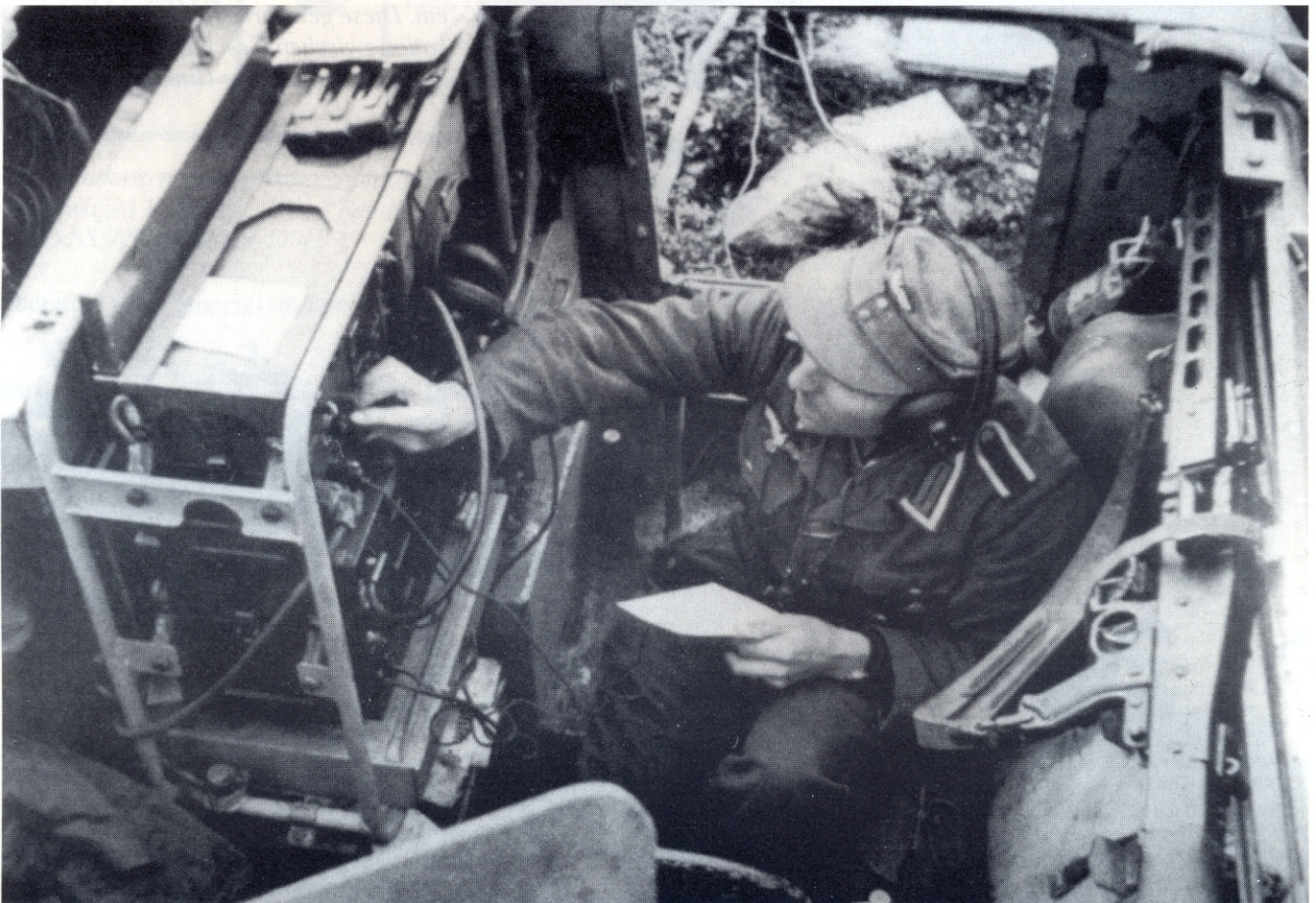
Der Funker an den Funkgerätesätzen FuG 8 (30-Watt-Sender 30 W.S.a und Mittelwellen-Empfänger Mw.E.c) und FuG 4 (Mw.E.c) im Funk-Panzerwagen (Sd.Kfz. 250/3) des Bataillons-Adjutanten.
