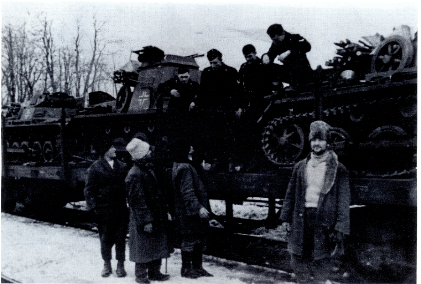
Die 184 gebauten Kleinen Panzerbefehlswagen (Sd.Kfz. 265) waren mit den Funkgerätesätzen FuG 2 und FuG 6 sowie 1,4-m-Stabantenne Fu a (an der rechten Fahrzeugseite) ausgestattet. Ab Ende 1940 setzte man sie allerdings nur noch zur Führung einzelner Panzer-Kompanien ein. Darüberhinaus hatten aber auch verschiedene Artillerie-Rgt. (mot) und Minenräum-Kp. einzelne Fahrzeuge. Ein Teil wurde auch als Munitionsschlepper und Krankenkraftwagen verwendet.
