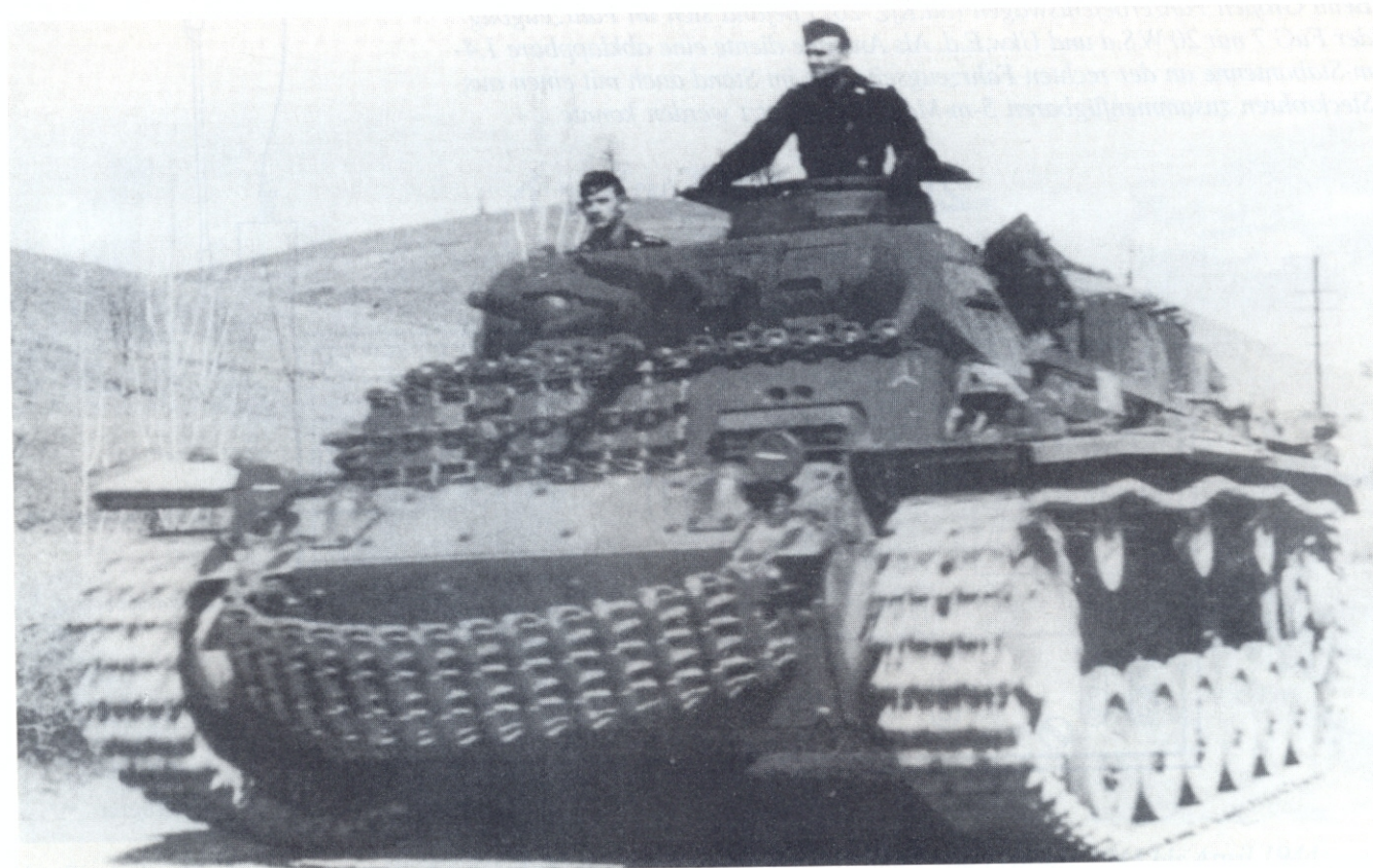
Bei diesem Großen Panzerbefehlswagen III Ausführung H wurde nach der Anbringung einer Zusatzpanzerung die Kugelblende des Panzer-Maschinengewehrs 34 von der Fahrerfront in den Turm verlegt. Führungspanzer der 2. Panzer-Division.
