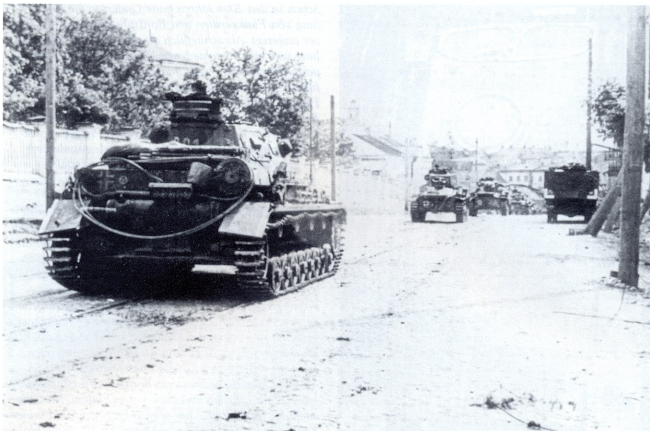
Bis 1943 befand sich die Halterung der abklappbaren 2-m-Stabantenne an der rechten Vorderseite des Wannenaufbaus. Aufnahme vom Sommer 1941, Panzerkampfwagen 38 (t) der 12. Panzer-Division in Rußland.
