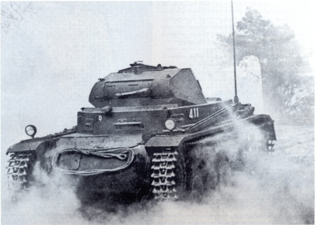
Beim Panzer II, hier einer der Ausführung c, war das Sende- und das Empfangsgerät links in der Panzerwanne eingebaut. Die Antenne war abklappbar und lag zum Schutz in einer Schiene aus Holz.
