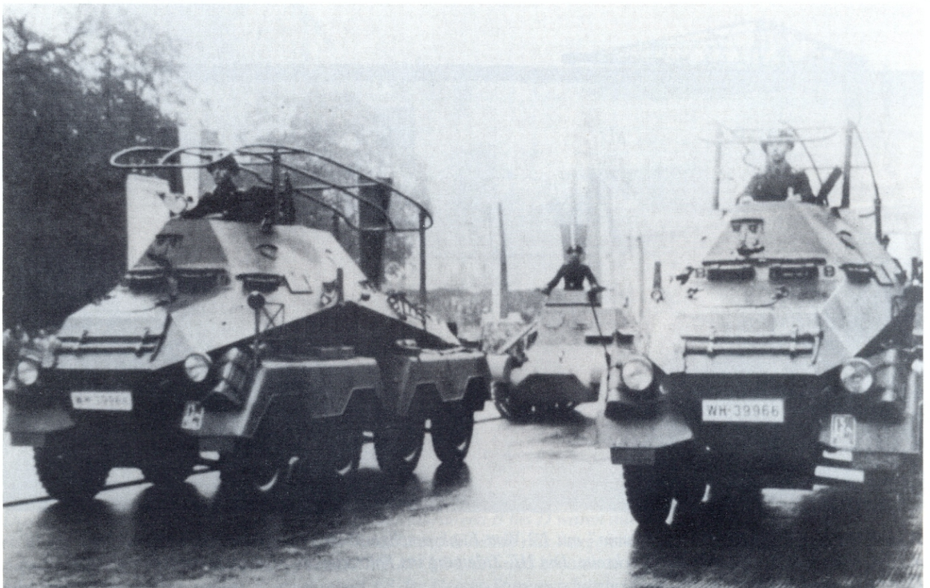
Die Funkausstattung des Schweren Panzerspähwagen (Fu) (Sd.Kfz. 232) -oben- und des Schweren Panzerfunkwagen (Sd.Kfz. 263) -unten- war gleich, unabhängig ob es sich um einen Sechs- oder Achtrad-Spähwagen handelte. Die Fahrzeuge unterschieden sich nur darin, daß die Sd.Kfz.263 einen festen Aufbau und zusätzlich zur Bügelantenne einen 8-m-Kurbelmast hatten, auf dem die Sternantenne a befestigt werden konnte. Ab 1935 bestand die Funkanlage aus dem Torn.E. 445 Bs (später Torn.E.b) und dem 100-Watt-Sender LS 100/108 der Fa. Lorenz (später als 100 W.S. bezeichnet). Diese Sende- und Empfangsanlage wurde als FuG 11 benannt.
