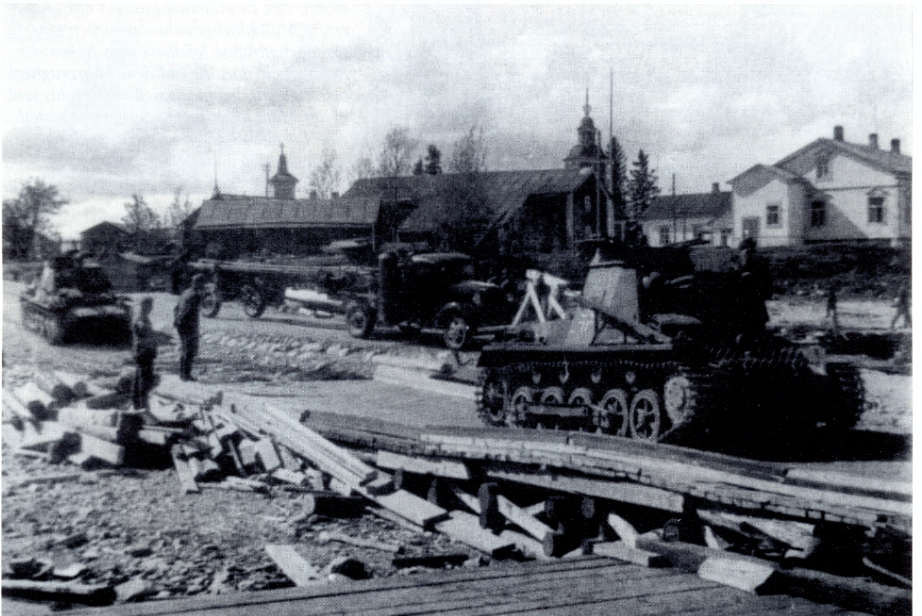
Die 184 gebauten Kleinen Panzerbefehlswagen (Sd.Kfz. 265) waren mit den Funkgerätesätzen FuG 2 und FuG 6 sowie 1,4-m-Stabantenne Fu a (an der rechten Fahrzeugseite) ausgestattet. Ab Ende 1940 setzte man sie allerdings nur noch zur Führung einzelner Panzer-Kompanien ein. Darüberhinaus hatten aber auch verschiedene Artillerie-Rgt. (mot) und Minenräum-Kp. einzelne Fahrzeuge. Ein Teil wurde auch als Munitionsschlepper und Krankenkraftwagen verwendet.
