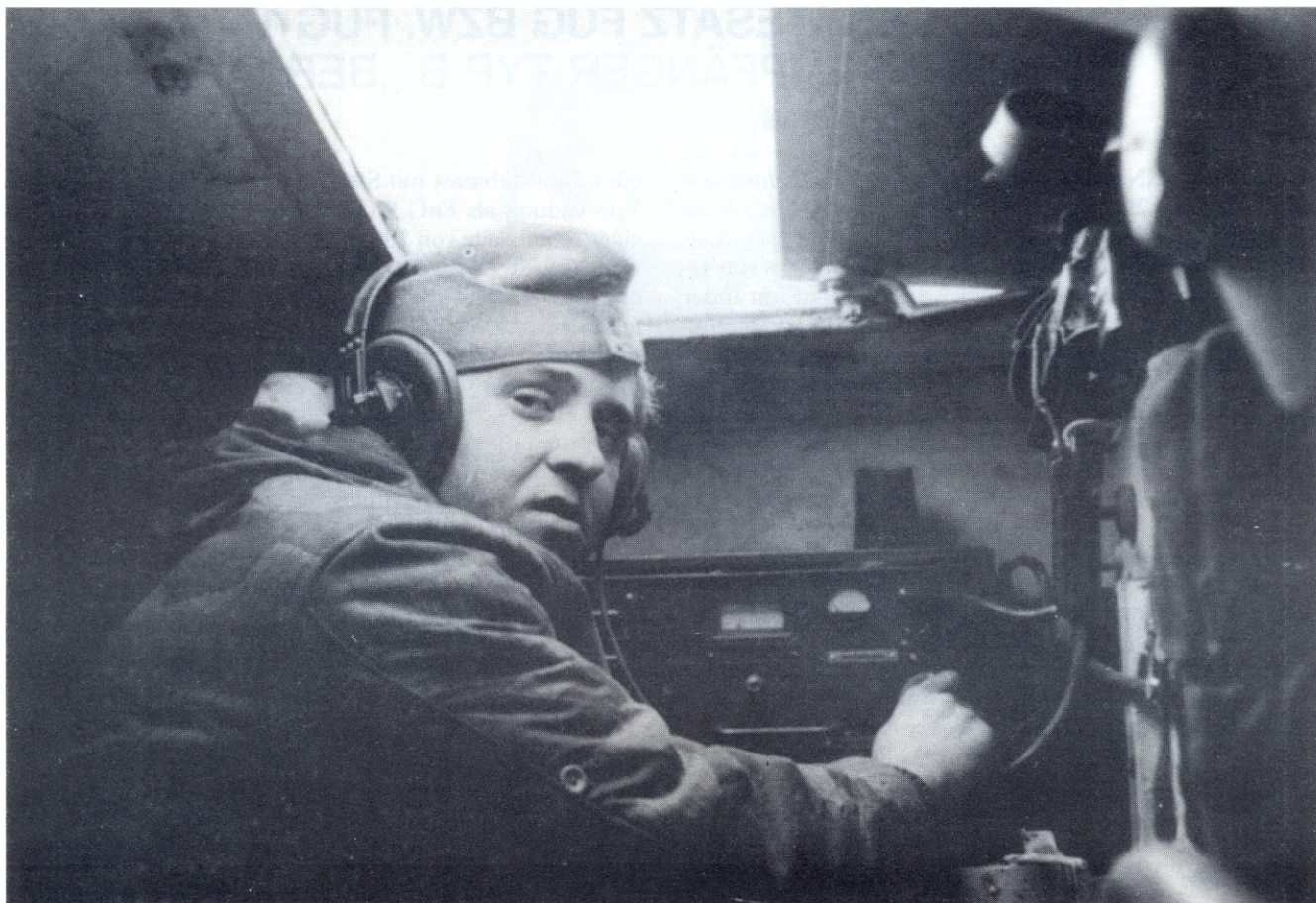
Der Funker eines Sturmgeschützes III beim Bedienen des Betriebsschalters seines 10-Watt-Senders 10 W.S.h, das zusammen mit dem Ukw-Empfänger Ukw.E.h den Funkgerätesatz, FuG 16 bildeten.
