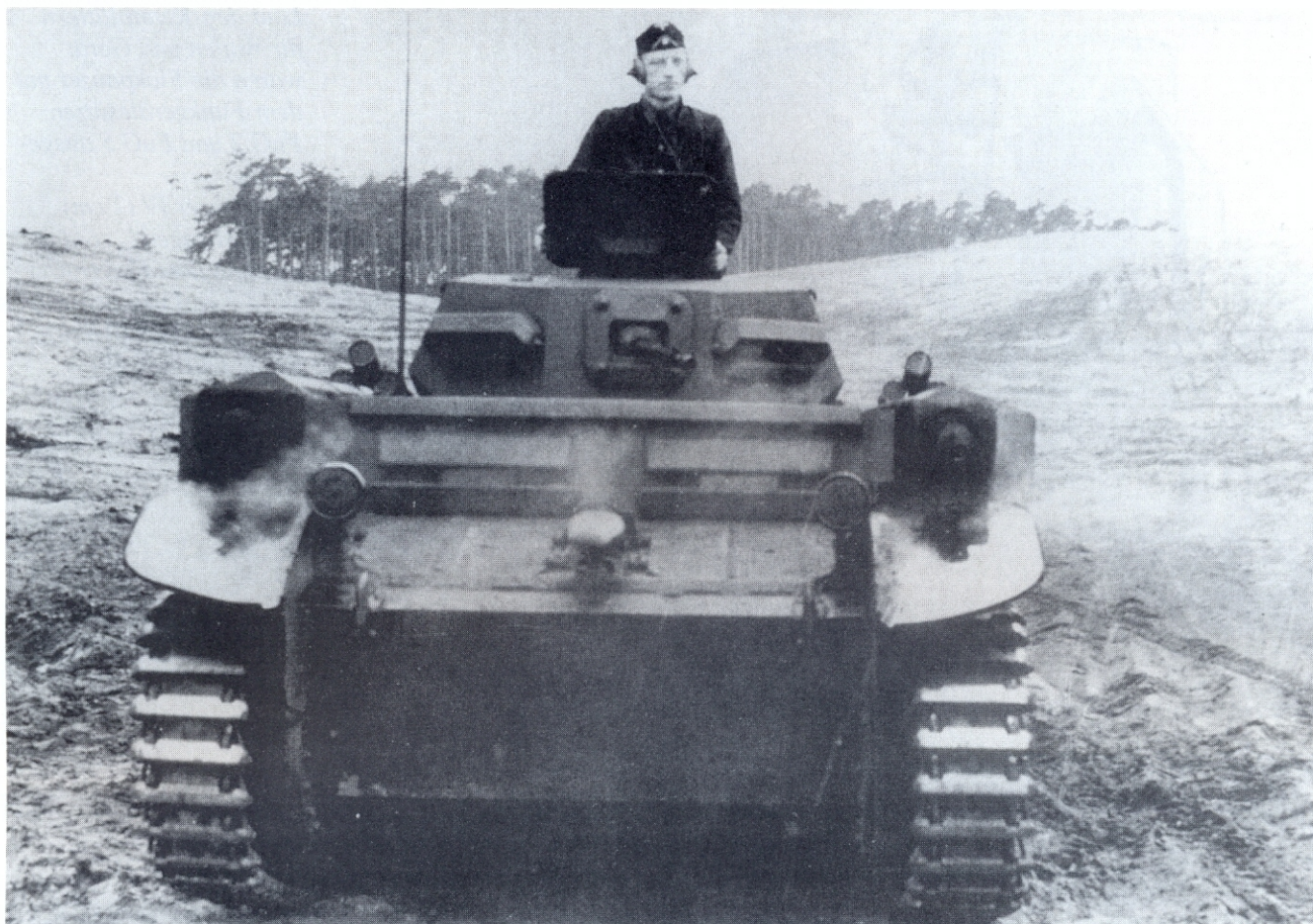
Auch die Flammpanzer waren mit dem Funkgerätesatz FuG 2 (Ukw-Empfänger Ukw. E.e) mit 1,4-m-Stabantenne ausgerüstet. Die Flammenwerfer-Panzerkampfwagen II (Sd.Kfz. 122) wurden von Januar 1939 bis März 1942 gebaut. Bis zum Juli 1942 nahm das H.W.A. 179 Fahrzeuge ab. Flammpanzer II des Panzer-Regiment 8 in Kummersdorf 1941.
