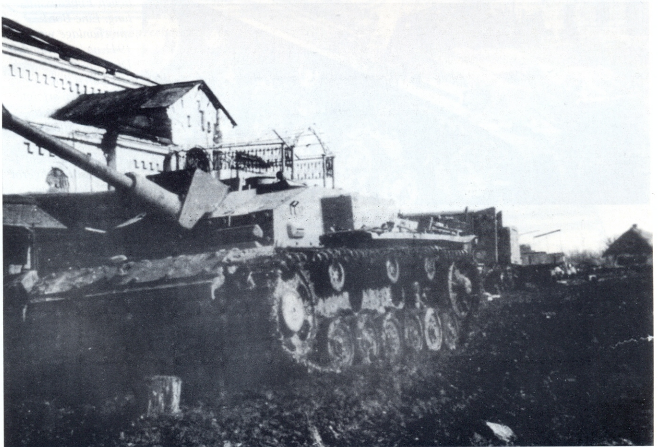
Die bis 1941 gefertigten Sturmgeschütze III der Ausführungen B bis D waren mit dem Funkgerätesatz FuG 16 (Ukw.E.h und 10 W.S.h) ausgerüstet. Ab der Ausführung E hatten alle neugefertigten Sturmgeschütze Einbauten zur Aufnahme der Funkgerätesätze FuG 16 und FuG 15 (Ukw.E.h) und konnten so jederzeit zu Zug- und Batterie-führerwagen umgebaut werden. Sturmgeschütz F8 der Heeres-Sturmgeschützbrigade 203 in Rußland 1942.
