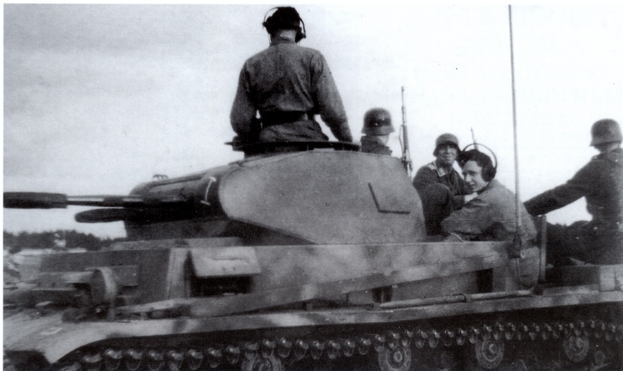
Panzerkampfwagen II (2 cm) Ausführung F, ausgerüstet mit Funkgerätesatz FuG 5 (UKW-Empfänger UKW.E.c1, später UKW.E.e oder UKW.E.h, und 10-Watt-Sender 10 W.S.c bzw. 10 W.S.h).
