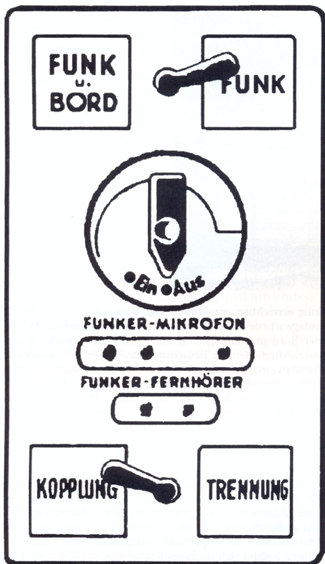
Umschaltkasten der Bordsprechanlage 20 des Panzerkampfwagen V (Sd.Kfz. 171) "Panther", (Zeichnung aus der D 655/27 "Panther-Fibel").
