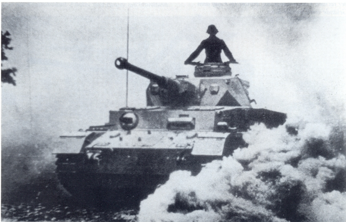
Panzerkampfwagen IV (7,5 cm) Ausführung G (Sd.Kfz. 161/1), ursprünglich mit 7,5-cm-Kpfgw.K. L/43, dann mit L/48, 1.687 Stück gefertigt von Mai 1942 bis Juni 1943 bei Krupp-Gruson in Magdeburg, Vomag in Plauen und den Nibelungenwerken in St. Valentin.
