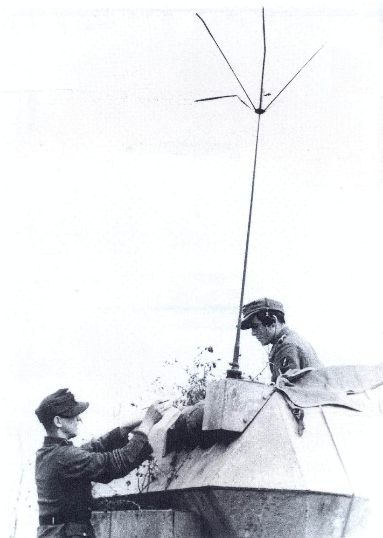
Mittlerer Schützenpanzerwagen (Sd.Kfz. 251) als Führungsfahrzeug eines Panzergrenadierbataillons. Die Verwendung der 2-m-Sternantenne a (inoffz. "Schirmantenne") läßt auf den Einbau des Funkgerätesatz FuG 4 (Mittelwellen-Empfänger Mw.E.c und 30-Watt-Sender 30 W.S.a) schließen.
