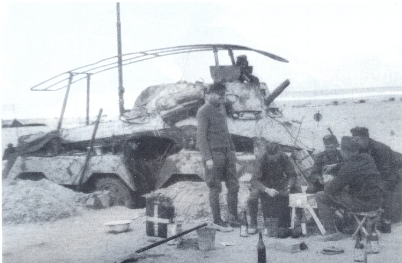
Obwohl zunächst die Achtrad-Spähwagen den FuG 11 erhielten, rüstete man ab Ende 1939 / Anfang 1940 die Fahrzeuge anstelle des 100-Watt-Senders mit dem 80-Watt-Sender 80 W.S. bzw. 80 W.S.a aus. Die Verbindung des Torn.E.b, der später auch durch den Mw.E.c ersetzt wurde, und dem 80 W.S. definierte man als Funkgerätesatz FuG 12. Einen der ersten Schweren Panzerfunkwagen (Sd.Kfz. 263) mit dieser Sende- und Empfangsanlage wurde während des Frankreich-Feldzuges vom Kommandeur der 7. Panzer-Division Generalmajor Erwin Rommel genutzt.
