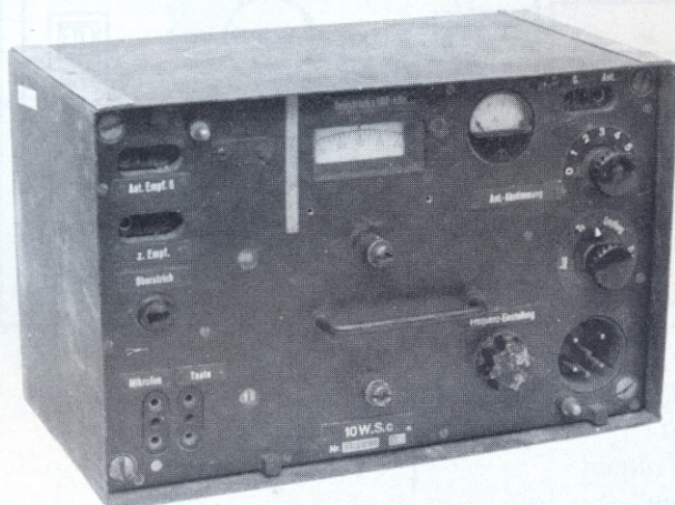
10-Watt-Sender 10 W.S.c mit heeresgrauem Anstrich, Gerät Nr. 13282-44, hergestellt 1944.
