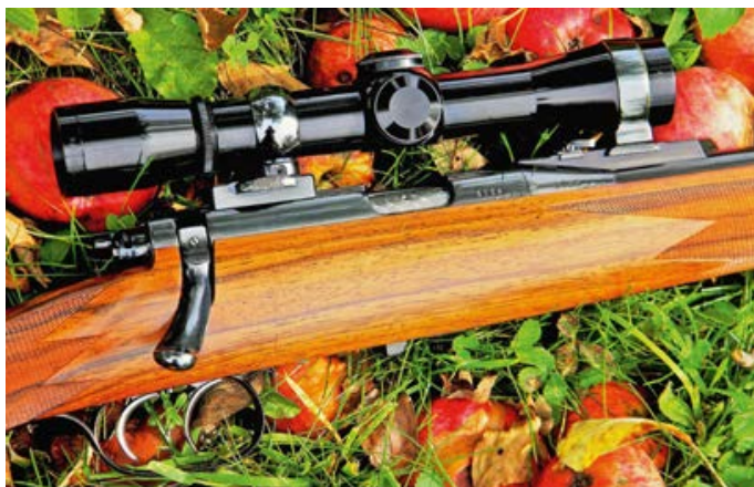
Der in Originalausführung ab Werk mit Kugelkopf versehene Kammerstängel wurde nachträglich löffelförmig gestaltet.
