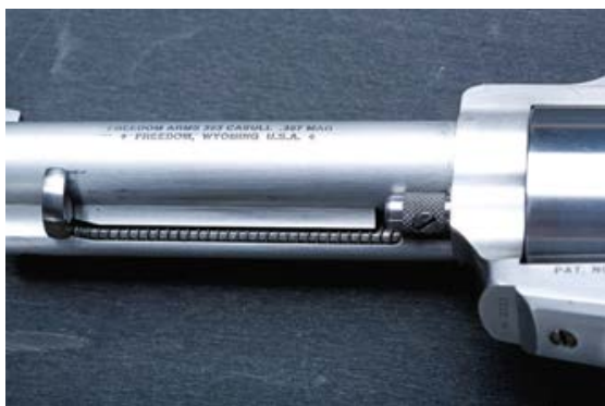
Die verschraubte Trommellachse und die federunterstützte Ausstoßertange.
