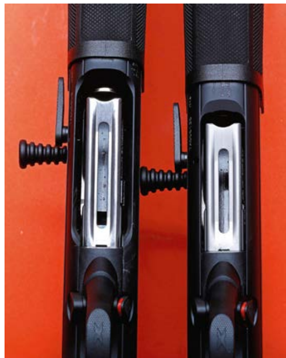
Die Ladeöffnung der Competition ist größer gestaltet, weil im dynamischen IPSC/Action-Schießsport auch schon mal gerne zwei Patronen hintereinander in die Magazinröhre befördert werden.
