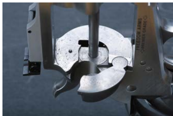
Die verschraubte Trommellachse und die federunterstützte Ausstoßertange.
