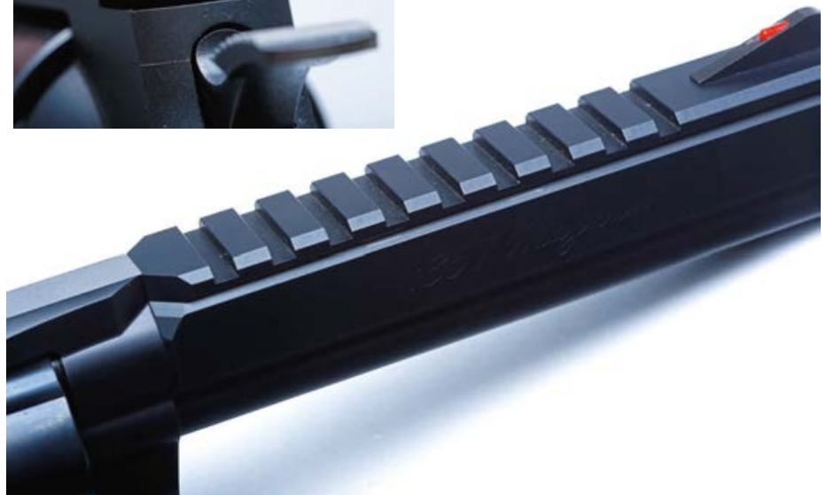
Das hochstehende, hinterschnittene Scheibenkorn des Freedom-Arms.
