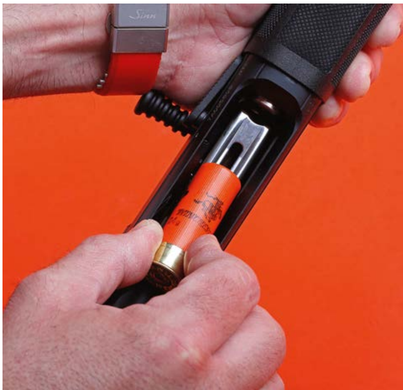
Der Ladelöffel führt die Patrone gut Richtung Röhrenmagazin.
