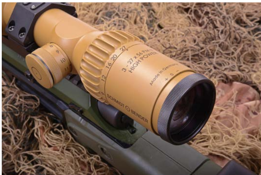
Das mächtige Schmidt & Bender-Zielfernrohr PM II 3-27x56 High Power mit 34 mm-Mittelrohrdurchmesser und 9-fachem Zoom gestaltete die Produktion von kleinen Streukreisen einfach.
