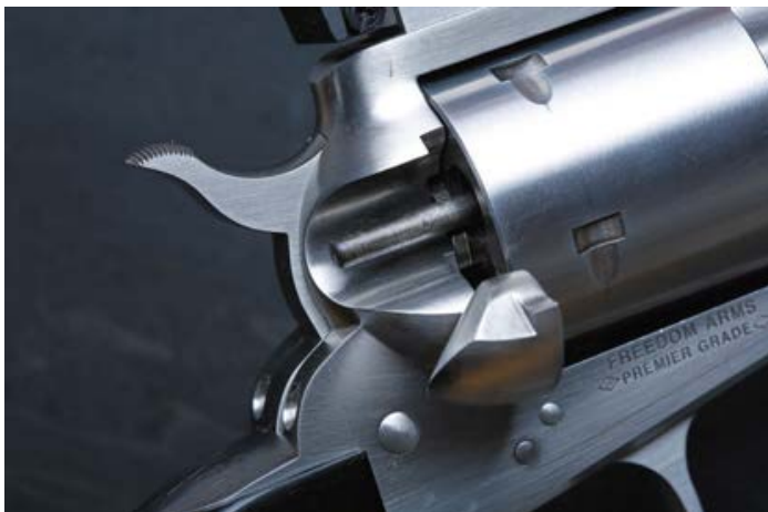
Das Laden und Entladen des Freedom Arms nach Colt SAA Manier geschieht für jede Kammer einzeln und ist zeitraubend.
