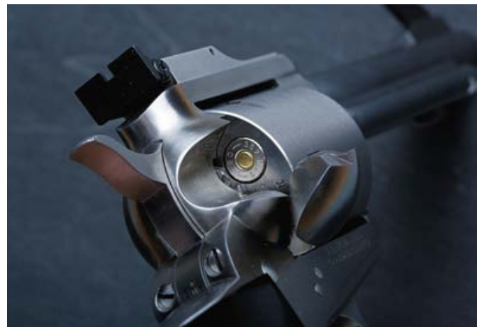
Das Laden und Entladen des Freedom Arms nach Colt SAA Manier geschieht für jede Kammer einzeln und ist zeitraubend.
