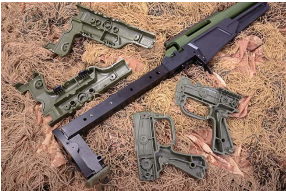
Die hintere Schulterstützenpartie bei abgenommenen Kunststoff-Halbschalen-Verkleidungen.
