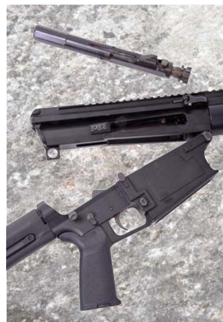
Modifizierte AR-10-Bauweise: Albert Arms ALR-300 mit aufgeklapptem Systemgehäuse und herausgenommenem Verschluss.
