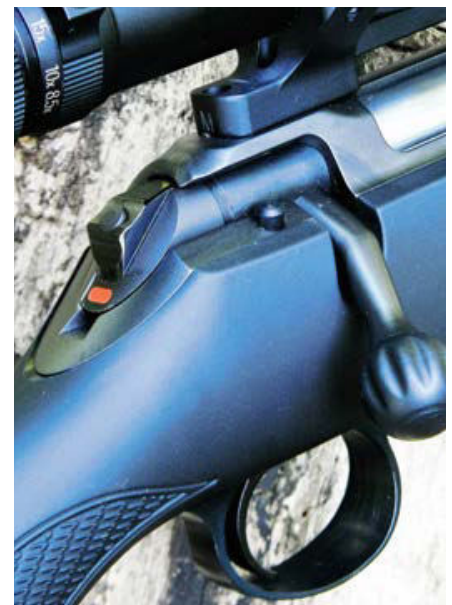
Die „Dura Safe“-Sicherung auf dem Schösschen blockiert den Schlagbolzen. Auch im gesicherten Zustand kann der Verschluss betätigt werden.
