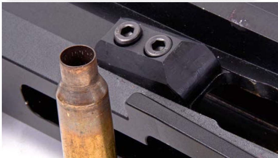
Kunststoff-Hülsenabweisschild am hinteren Bereich des Auswurfensters. Die Hülsen verlassen die Waffe unbeschadet, höchstens leichte Druckstellen von Auszieher und Doppel-Ausstoßer konnten festgestellt werden.
