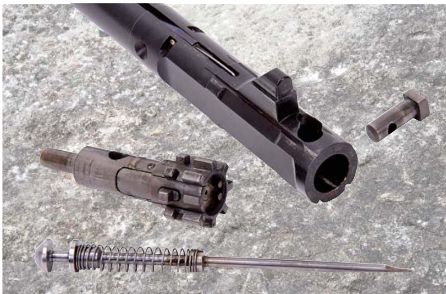
Der demontierte Verschluss offenbart die Schlagbolzen-Rückholfeder, die das Risiko von „Slamfire“ deutlich reduziert.
