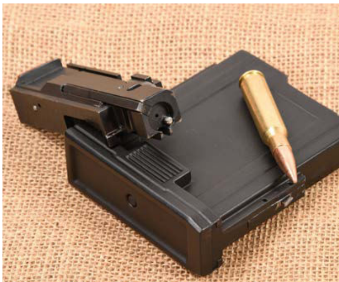
Blick auf den abgewandelten Fallblockverschluss mit zwei Verriegelungselementen mit einer Verriegelungsfläche von 140 Quadratmillimetern.
