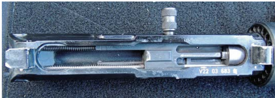
Einblick in den Upper Receiver des CZ V22 mit Masse-Feder-Verschluss mit zwei Verschlussfedern.
