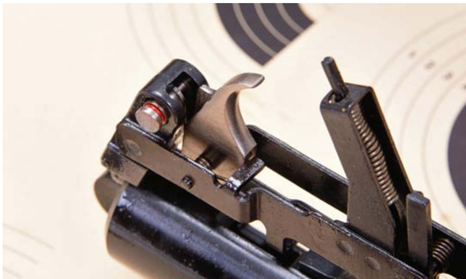
Die simpel konstruierte Druckknopfsicherung begrenzt den Weg des Abzuges.
