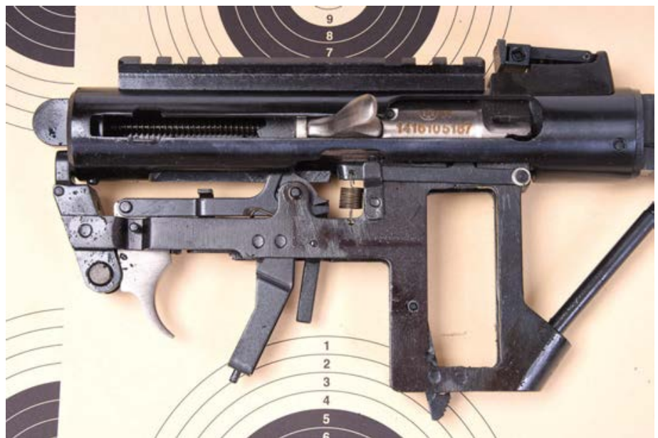
Das interessant aufgebaute System mit kraftschlüssigem Feder-Masse-Verschluss.
