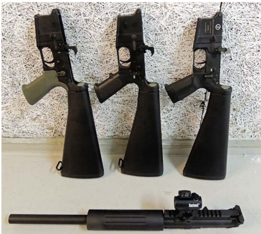
Im Test wurde das DPMS-System in .22 Long Rifle unter anderem mit drei verschiedenen Griffstücken kombiniert. Von links: DPMS Lower mit überarbeitetem Standardabzug, FMK Polymer-Lower mit Standardabzug und Schmeisser Lower mit Uhl Matchabzug.
