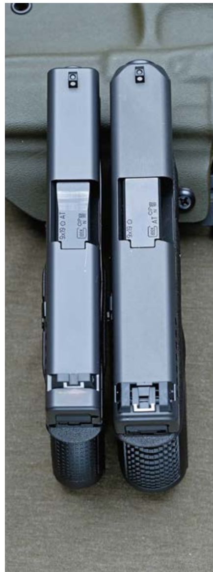
Im direkten Vergleich der Seitenansichten einer Glock G26 Subkompaktpistole mit Doppelreihier-Magazin und 10+1 Patronen (oben) und einer Glock G43 mit Einreihier-Magazin und 6+1 Patronen (unten), beide in 9 mm Luger, sieht man keinen großen Unterschied. Erst aus der Vogelperspektive wird der um vier Millimeter schmalere Schlitten der etwa 100 Gramm leichteren G43 sichtbar (links).
