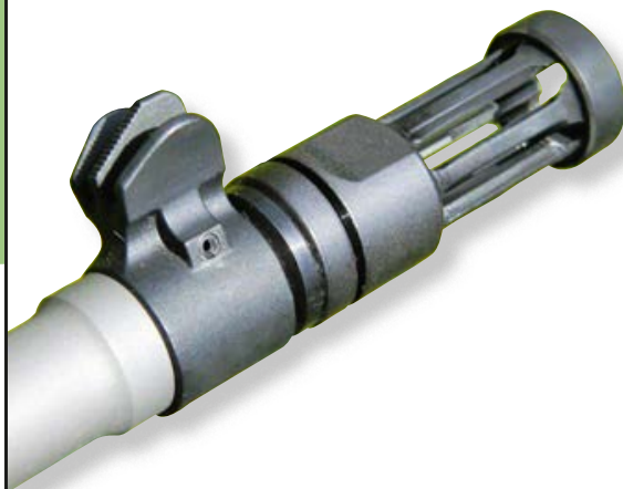
Blick auf Mündungsfeuerdämpfer und Korn mit Schutzbacken.
