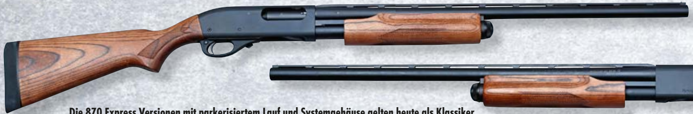
Die 870 Express Versionen mit parkerisiertem Lauf und Systemgehäuse gelten heute als Klassiker unter den „Arbeitsflinten“. Die matt-schwarze Phosphatierung vermeidet Reflektionen und der Schichtholz-Schaft ist relativ unempfindlich gegen Feuchtigkeit und mechanische Belastung.
