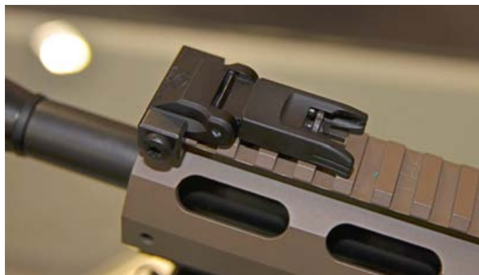
Die mechanische, extrem flach bauende ERA-TAC-Notvisierung überzeugt durch praxisnahe Konstruktion und hochwertige Verarbeitung. Hier zu sehen, die hochgeklappte Lochkimmer und das eingeklappte Korn.
