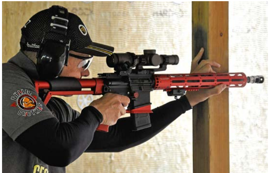
Dynamische Dominanz: Das AR-15-Selbstladegewehr mit direktem Gasdruckladesystem („direct gas impingement“; DGI) in .223 Remington ist in all seiner Vielfalt „das“ Sportwerkzeug im IPSC/Action-Metier.
