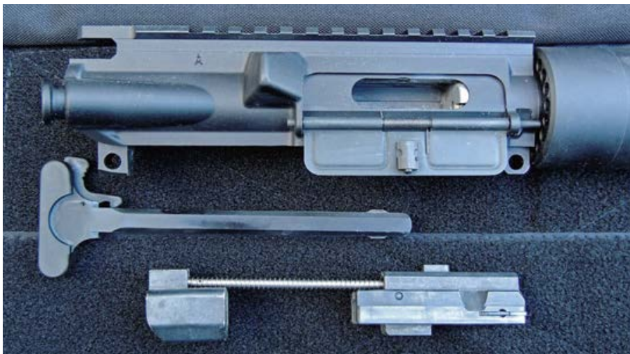
Das DPMS RFA2-22LR Wechselsystem in seine wesentlichen Bestandteile zur feldmäßigen Reinigung zerlegt.
