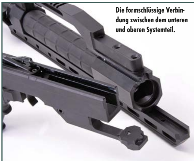
Vom Leichtmetallträger-Griffstück entfernte Verschlusskammerhülse.
