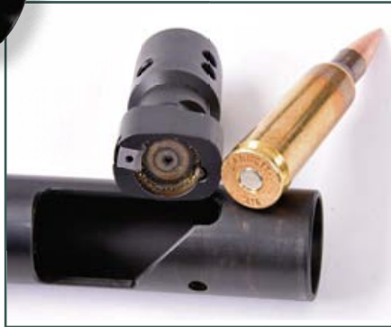
Demontierter Verschluss und Blick auf den Verschlusskopf mit integriertem Ausstoßer und Auszieher.
