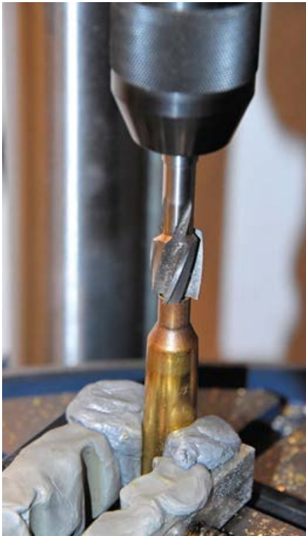
Die originalen .416 Barrett-Hülsen trimmten wir nach dem 100 Meter-Test mit unserem Hülsen-Trimmgewerk Marke Eigenbau für die anstehende 300-Meter-Erprobung.
