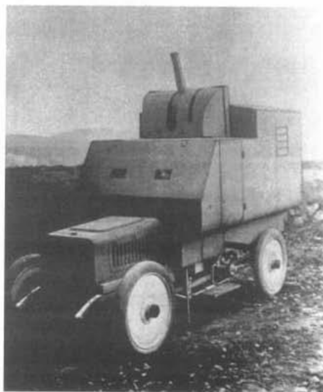
Die 5-cm-Schnellfernkano L/30 in Mittlepivott-Wiegenlafette. Das Fahrzeug stammte von der Firma Erhardt und wurde auf ein normales LKW-Fahrgestell aufgebaut.
