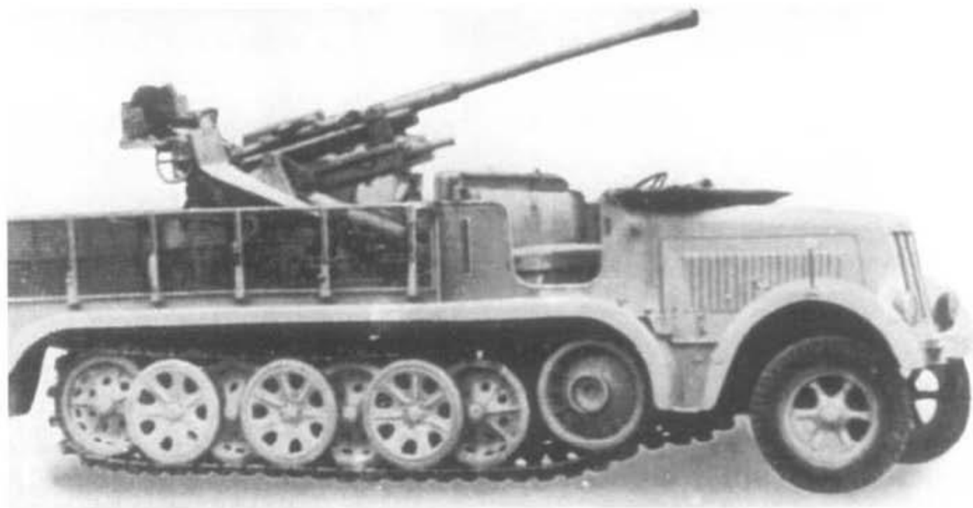
Die 3,7-cm-Flak 36 auf Zugkraftwagen 8 t KMm 11 (Sd. Kfz. 7/2) kam 1942 bis 1945 zur Auslieferung.
