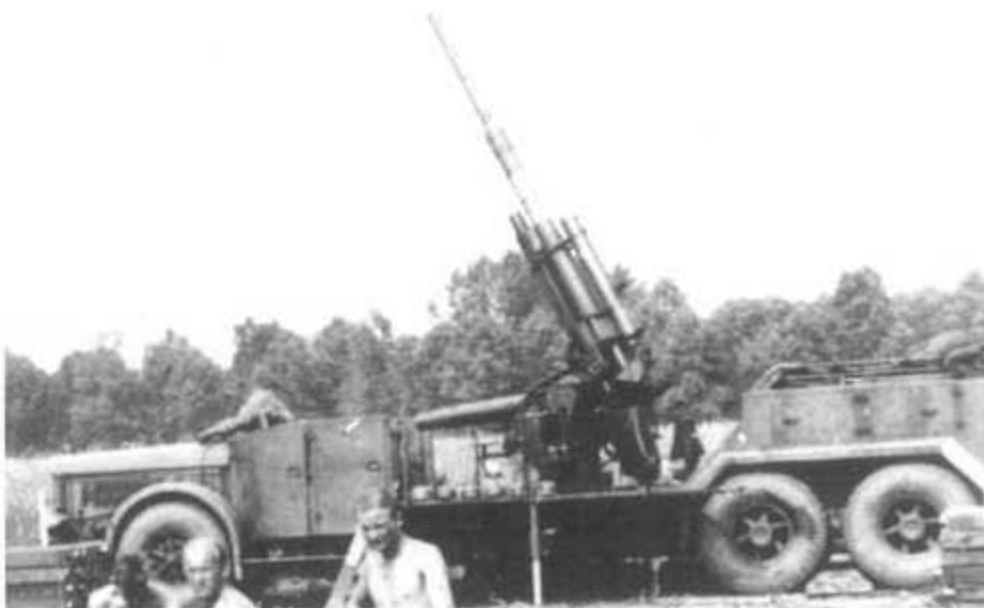
Die 8,8-cm-Flak auf LKW 6,5 t Vomag 6L (6x4) musste beim Schießen beidseitig abgesichert werden. Die maximale Erhöhung betrug +85°.
