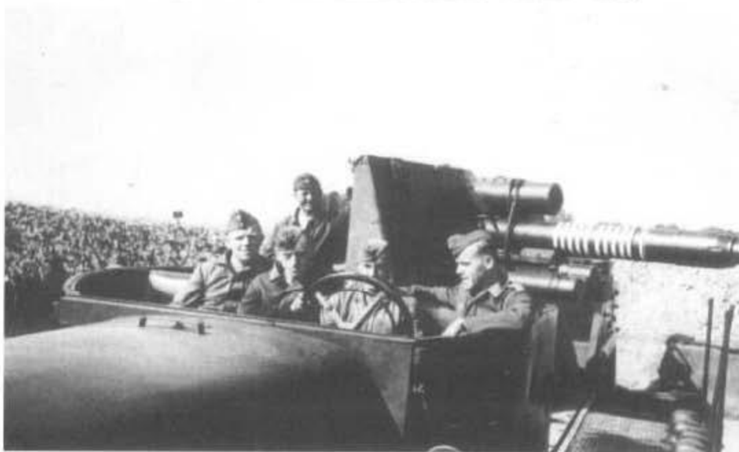
Die 8,8-cm-Flugabwehrkanone hatte eine Rohrlänge von 4930 mm = L/56.
