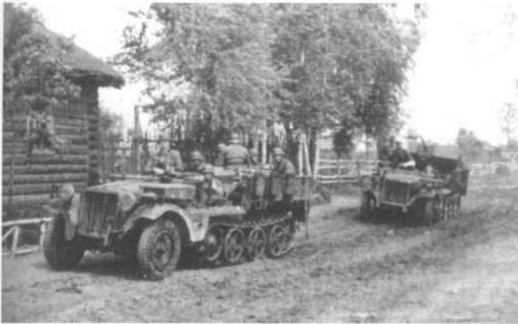
Mit der Verwendung von Fahrgestellen der Halbketten-Zugkraftwagen erreichte man eine gute Beweglichkeit der Flak.
