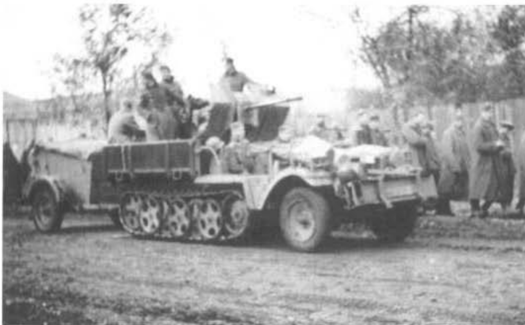
Nachdem die 2-cm-Flak 30 auf Zgkw 1 t Demag D 7 (Sd. Kfz. 10/4) zuerst bei der Luftwaffe zum Einsatz kam, erhielten später auch Heeres-Flak-Verbände diese Selbstfahrlafette.
