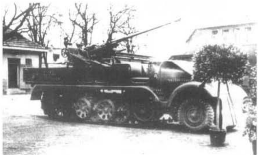
Die 3,7-cm-Flak auf Zgkw 5 t BN 9 (Sd. Kfz. 6/2) in einer Gesamtansicht. Die Rohrlänge von 3626 mm \approx L/98 ist hier gut einzuschätzen.
