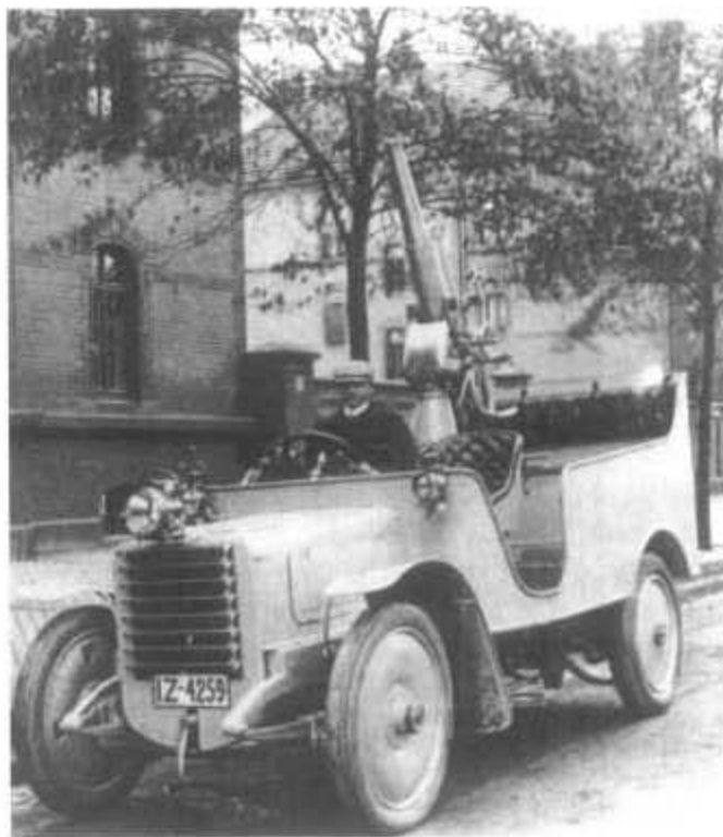
Die 5-cm-Ballonabwehrkanone L/30 der Firma Rheinmetall wurde auf ein teilgepanzertes LKW-Fahrgestell der Firma Erhard aufgesetzt.
