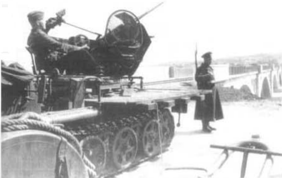
Die seitlichen Bordwände des Fahrzeugs konnten aufgeklappt werden. Damit entstand eine größere Fläche für die Bedienmannschaft.
