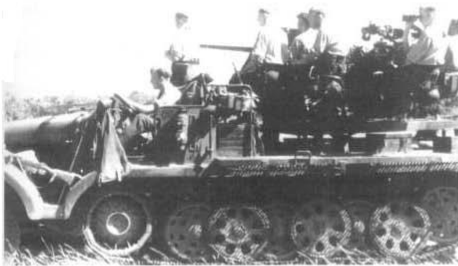
Diese Aufnahme lässt Details des Fahrwerks erkennen. Die Seitenwände sind aufgeklappt, damit die Fläche für die Bediennemannschaft vergrößert wird.
