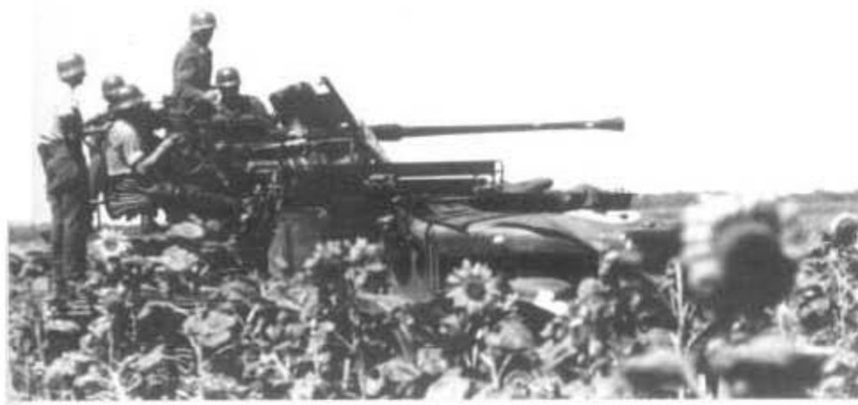
Die 3,7-cm-Flak 36 L/60 auf Zgkw 5 t BN 9 (Sd. Kfz. 6/2) wurde auch bei Heeresflak-Einheiten verwendet.
