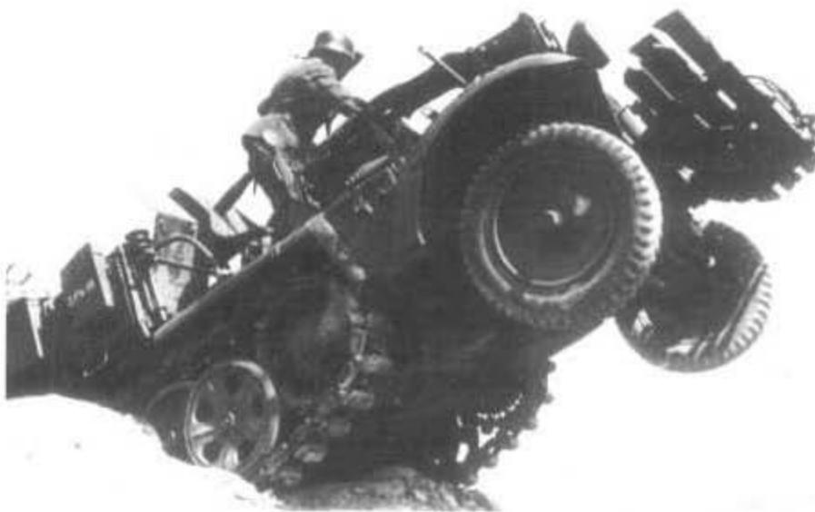
Die Halbketten-Fahrgestelle der Zugmaschine 1 t Demag D 7 hatten eine gute Beweglichkeit.
