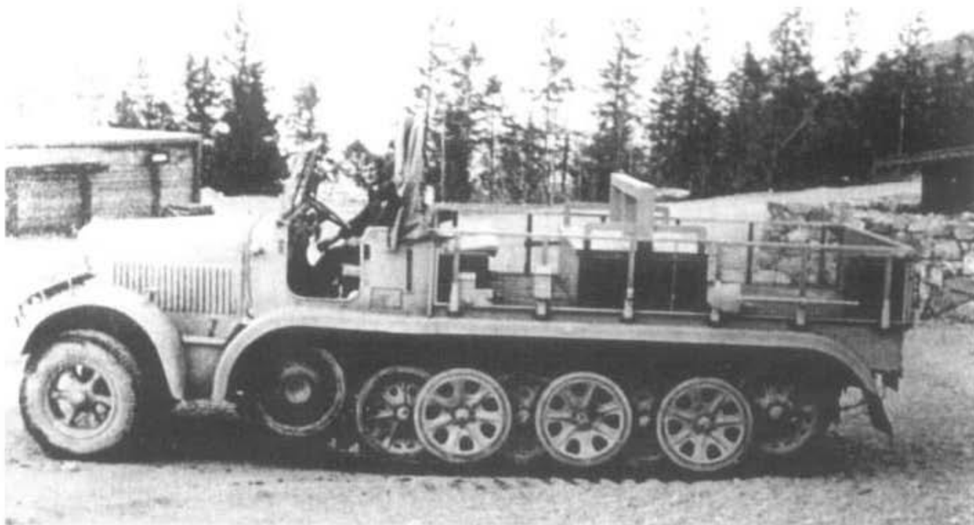
Das Foto zeigt die 3,7-cm-Flak 36 auf Zugkraftwagen 8 t KMm 11 (Sd. Kfz. 7/2) als Fahrschulwagen für die Ausbildung; die Waffe ist deshalb abgenommen.
