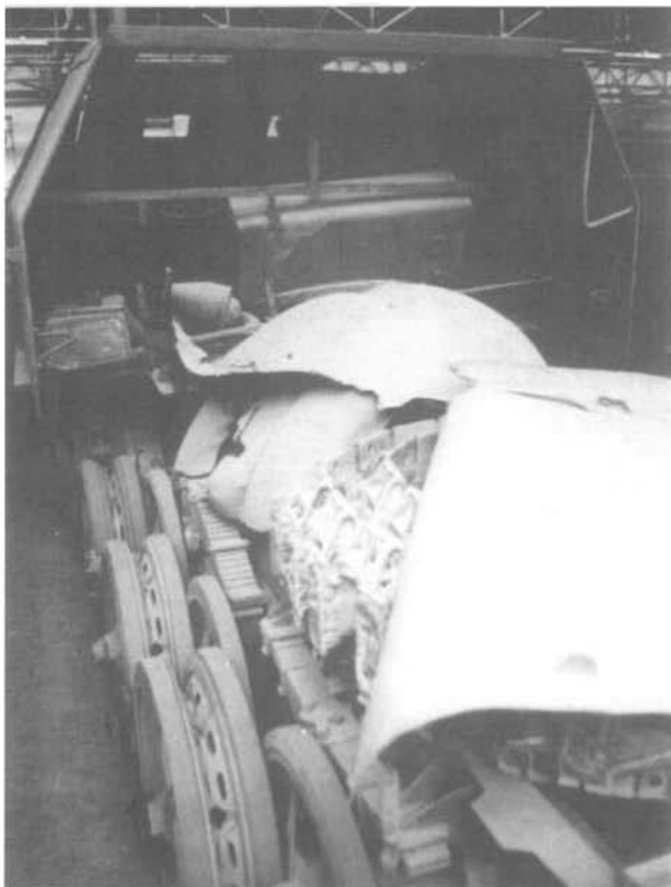
Diese Aufnahme einer 3,7-cm-Flak L/60 auf Zgkw 8 t Kfz. 7/2) vor der Restaurierung gewährt einen Blick auf das Fahrgestell.
