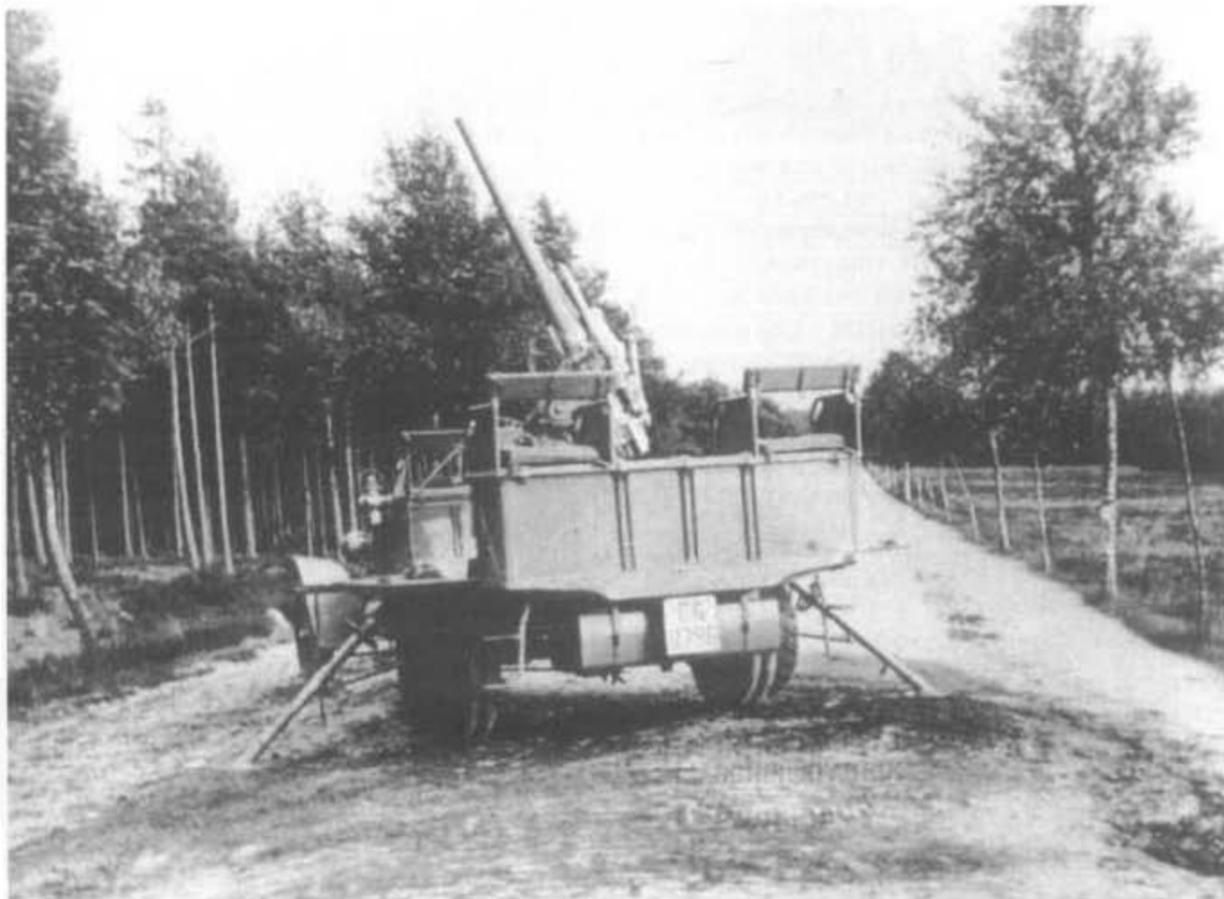
Bei diesem Fahrzeug handelt es sich um einen Prototyp einer Ballonabwehrkanone auf einem LKW-Fahrgestell, wie sie seit Anfang des 20. Jahrhunderts entwickelt wurden.
