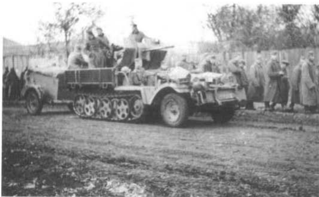
Das Fahrgestell des Halbketten-Zugkraftwagen 1 t Demag D 7 bewährte sich auch als Trägerfahrzeug für die 2-cm-Flak 30. Die selbsttragende Stahlblechwanne trug problemlos alle Aufbauten.
