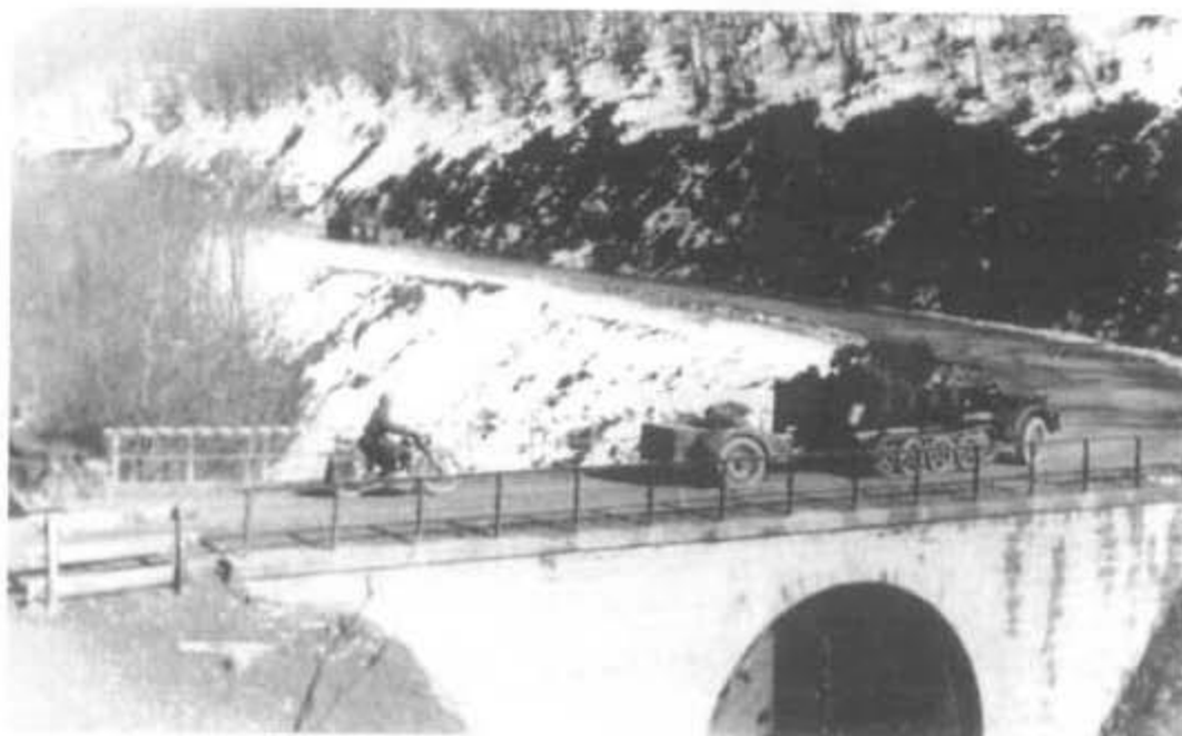
Das Fahrgestell des Halbketten-Zugkraftwagen 1 t Demag D 7 bewährte sich auch als Trägerfahrzeug für die 2-cm-Flak 30. Die selbsttragende Stahlblechwanne trug problemlos alle Aufbauten.
