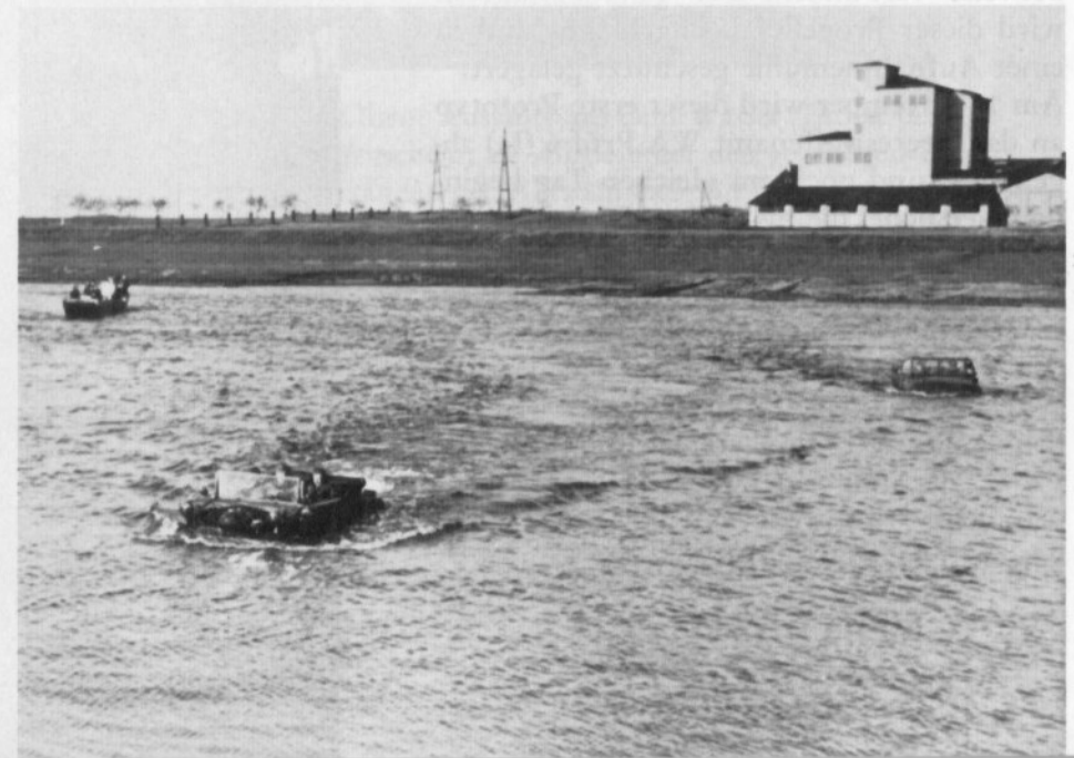
Unten: Typ 128/3 in Bildmitte und Trippel rechts beim Vergleichsschwimmen in der Donau bei Ingolstadt.
