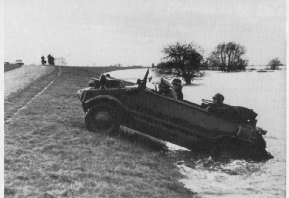
Der Typ 128/I »klettern« mit eigener Kraft an Land.
