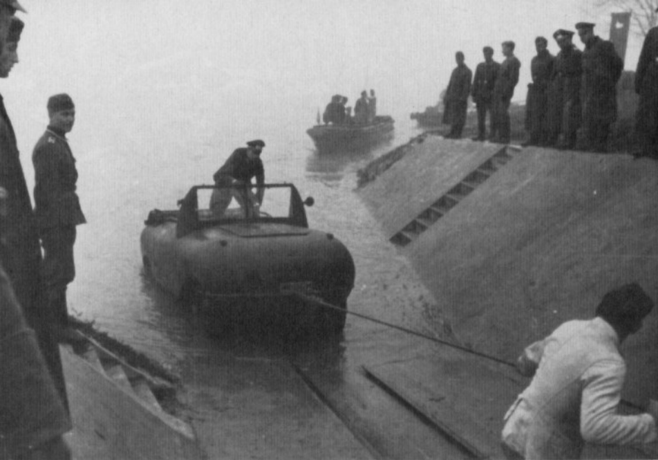
Das Trippel Vergleichsfahrzeug wird an Land gezogen mit Motordefekt wegen Überhitzung (s. auch WA-Band 82).
