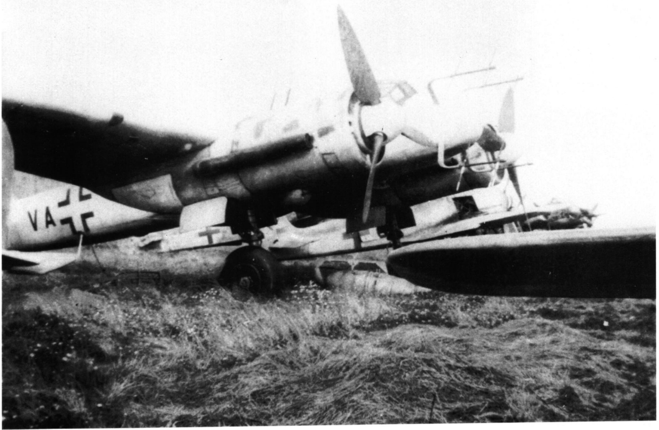
Eine Ju 88 G-6 mit einer hinter der Kabine installierten, aus zwei MG 151/20 bestehenden Schrägbewaffnung.
