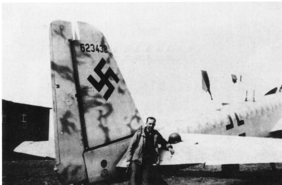
Die Ju 88 G-6 (WerkNr: 623432) war mit zwei MG 151/20 als Schrägbewaffnung ausgerüstet.
