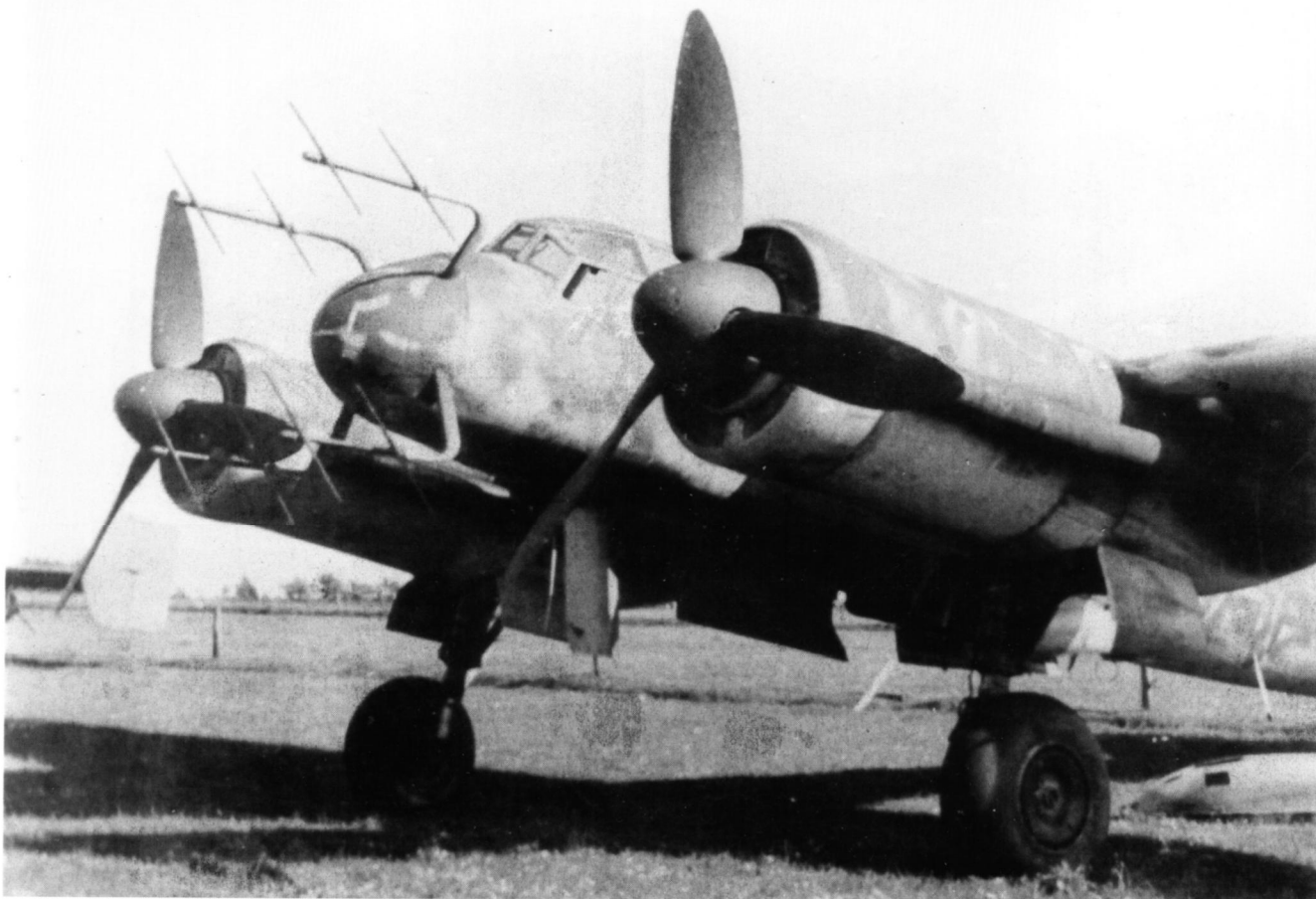
Die seitlich der Triebwerke angebrachten Flammen-Vernichterrohre wirkten sich nachteilig auf die Flugleistungen aus.
