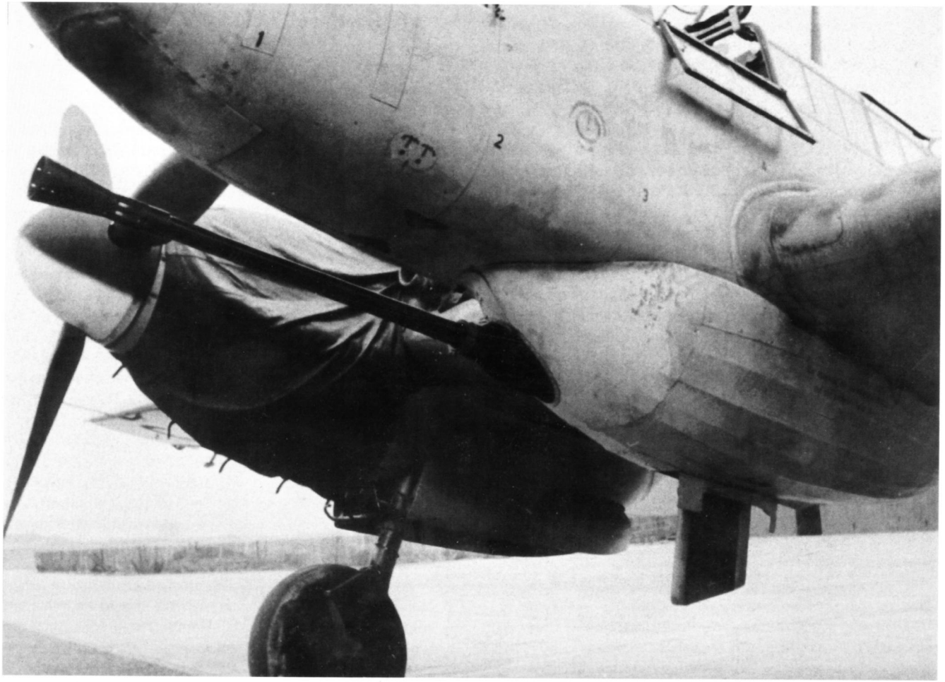
Als Nachtjäger bewährte sich die Bf 110 mit untergebauter BK 37 (3,7 cm) nicht.
