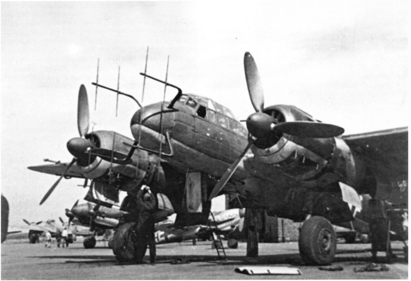
Eines der Ju 88 G-1-Musterflugzeuge, die mit einer geänderten FT-Anlage bei der E-Stelle in Werneuchen flogen.
