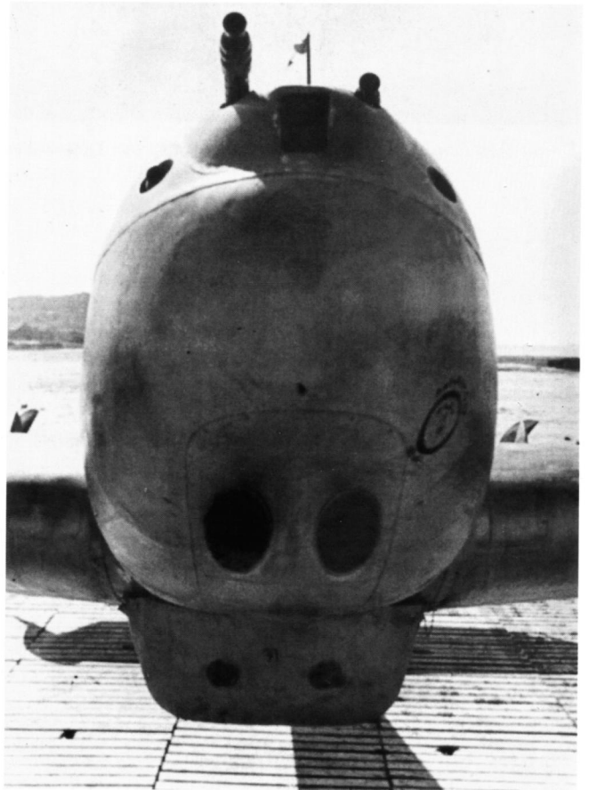
Beim NJG 100 flog diese Bf 110 mit zwei zusätzlichen 2 cm - Waffen.
