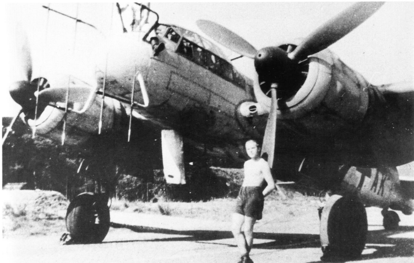
Versuchsweise wurde diese Ju 88 G-1 (4R+AK), die zur 2./NJG 2 gehörte, mit einer nach vorn feuernenden 2 cm Kanone versehen.
