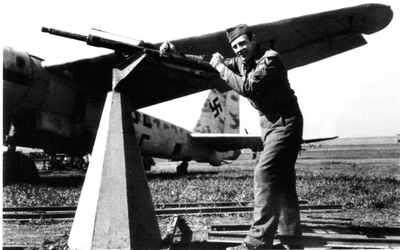
Nicht mehr benötigte MG 151/20-Waffen wurden als Behelfsflak auf Betonsockeln zur Tieffliegerabwehr genutzt.
