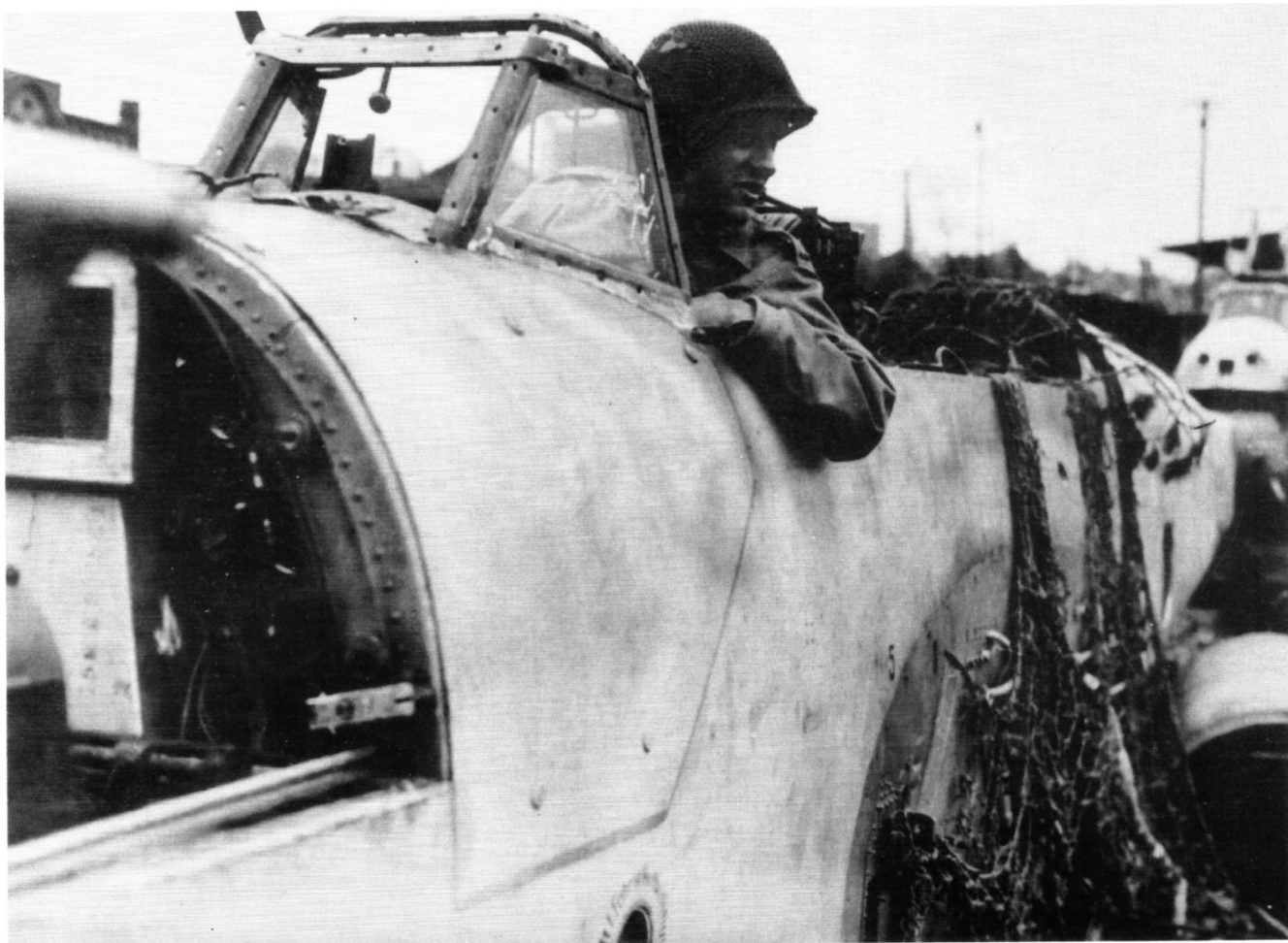
Mit einer solchen Zusatzpanzerung sollte die letzte Baureihe der Bf 110, die Ausführung H, serienmäßig ausgerüstet werden.
