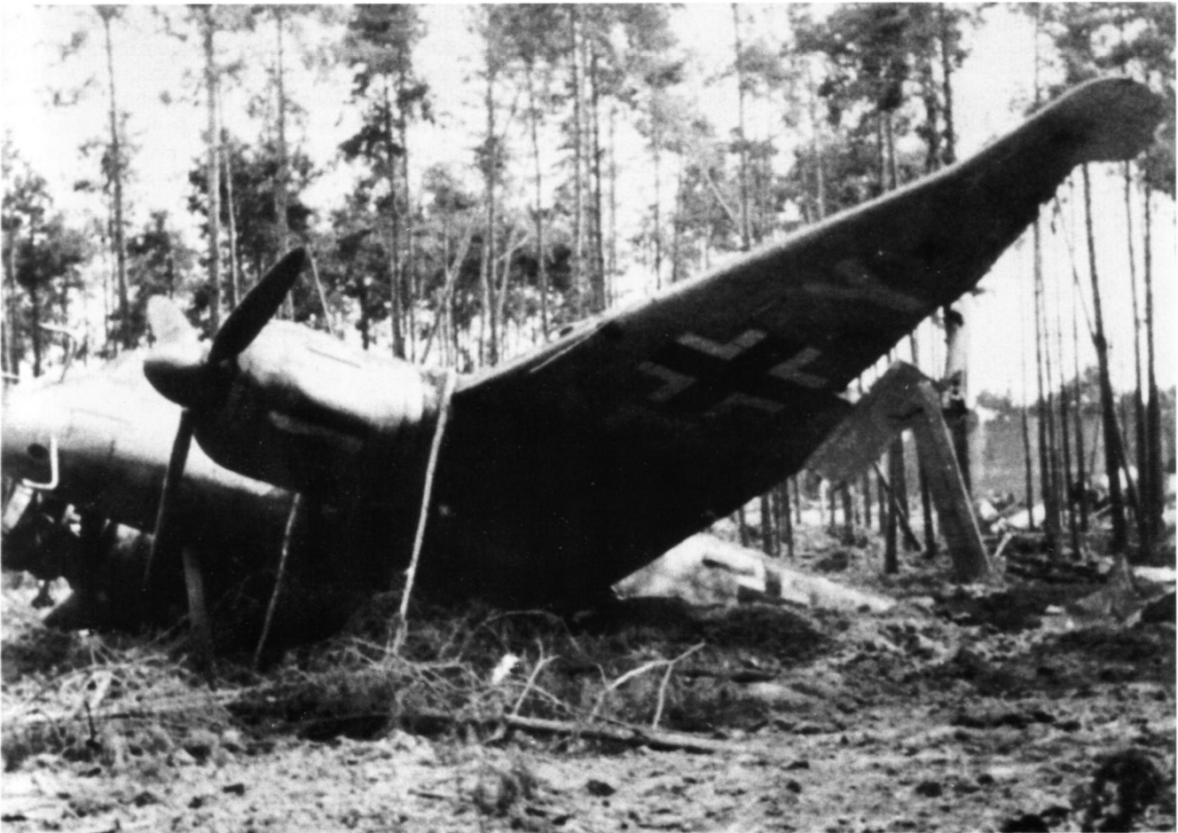
Offensichtlich besaß diese Ju 88 G die Flächen der Ju 188 und stellte ein Versuchsmuster der G-Serie dar.
