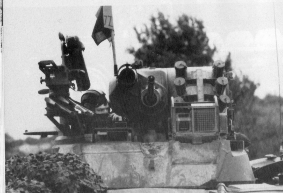
Unten: Dasselbe Fahrzeug; bemerkenswert – das Fehlen der Fahr-scheinwerfer und das mit Gurten befestigte Tarnnetz auf der Triebwerkraumklappe. Rechts im Hintergrund ein KPz LEOPARD 2 A3.
