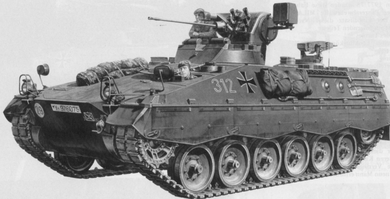
SPz MARDER, nachgerüstet mit Kettenschürzen, jedoch noch mit kurzen Abschleppseilen.
