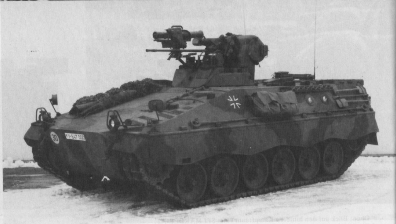
Voll aufgerüsteter SPz MARDER A2 im Fleckentarnanstrich. Gut erkennbar die Öffnungen in den Kugel- blenden und die komplette Waffenanlage MILAN einschließlich des Lenkflugkörpers. Die kurzen Anten- nen weisen darauf hin, daß dieses Fahrzeug schon mit den neuen Funkgeräten SEM 70 bzw. 80/90 ausge- stattet ist.
