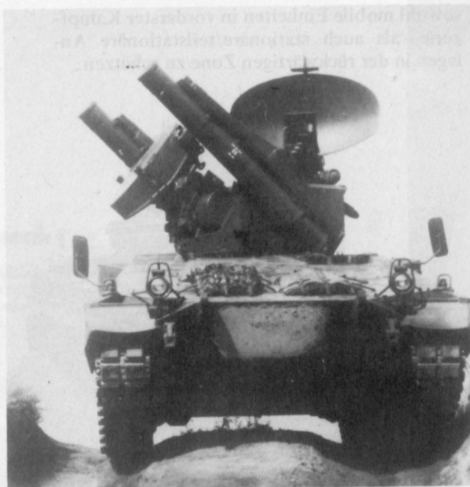
Beim ROLAND II übernimmt das Feuerleitradar die Funktion des optischen Visiers. Es folgt mit seiner Send-/Empfangskeule automatisch dem Ziel.
