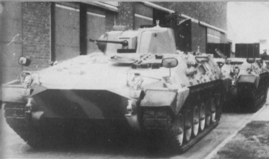
Mörserträger VCTM – bemerkenswert die beiden zur Seite klappbaren großen Luken sowie die nach vorn abzuklappende mittlere Luke. Auf dem Fahrzeugbug: Markierungsstangen für die Feuerstellung.
