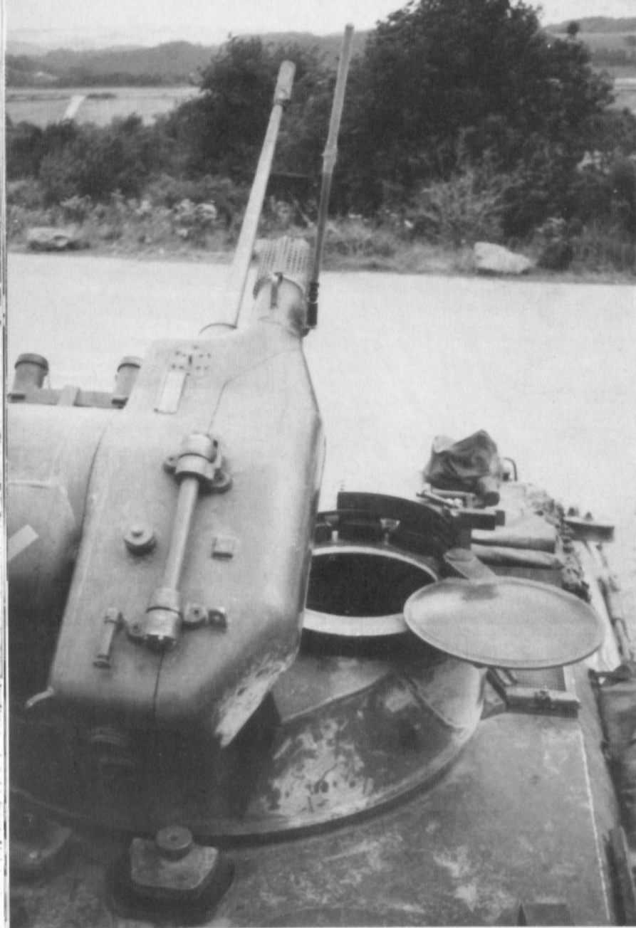
Blick auf das Waffenträgergehäuse (A1-) der 20 mm-Maschinenkanone, rechts oberhalb davon in die Wiege integriert das achsparallele Maschinengewehr, dessen Mündung mit einem Metallgitter ummantelt ist. Interessant die schwenkbare Richtschützenluke.
