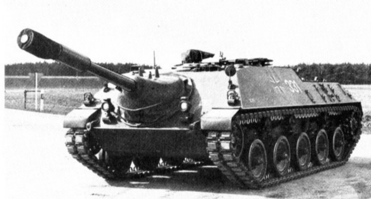
1966/67 wurden 710 Jagdpanzer, Kanone (Bordkanone 90 mm L 40,4 / 500 PS-Mehrstoff-Vorkammer-Dieselmotor MB 837 Aa) hergestellt.
