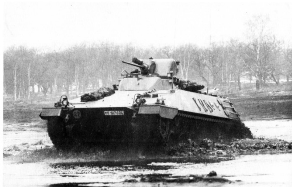
Schützenpanzer – neu der Nullserie; die Nebelwurfbecher befinden sich noch an der linken Turmseite, die Formgebung der Scheitellafette des Heck-MG's entspricht noch nicht der späteren Serienfertigung.
