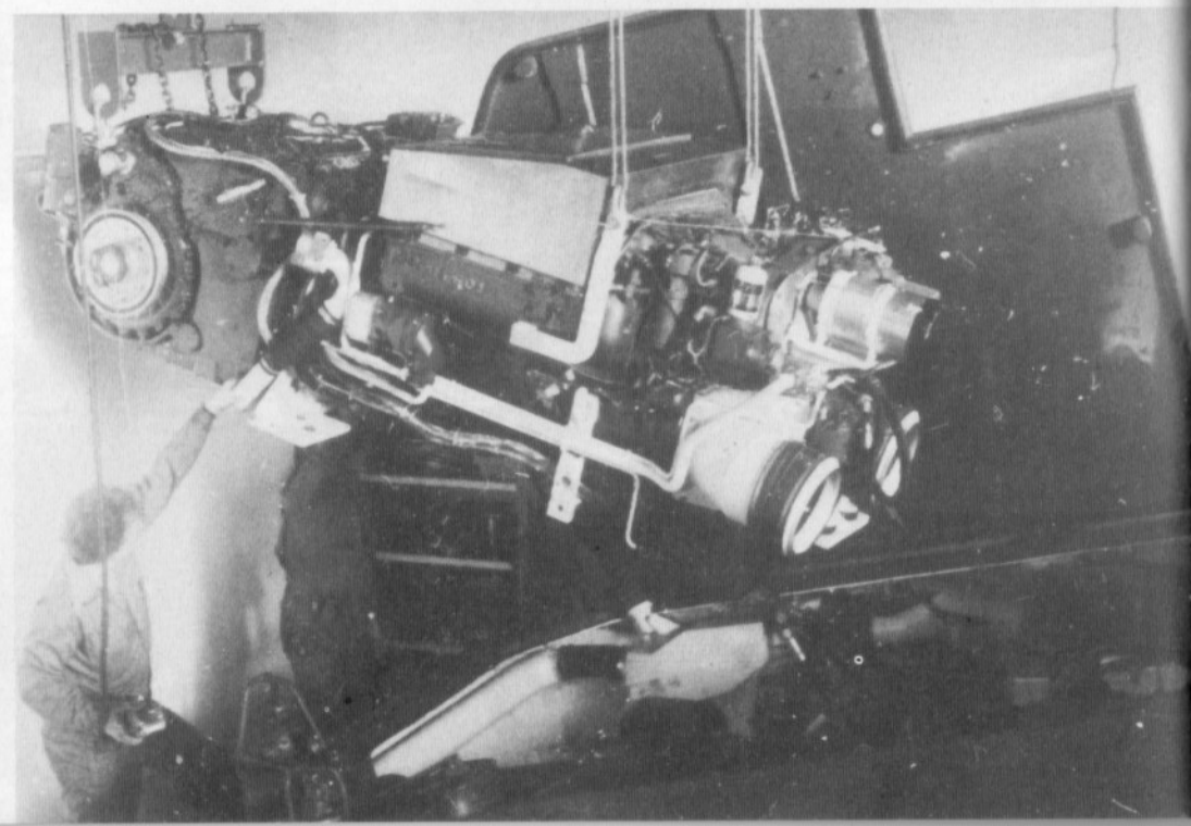
Die große Triebwerkraumklappe ermöglicht den Ein- und Ausbau des 600 PS (441 kW)-Dieselmotors zusammen mit dem angeflanschten Getriebe in ca. 30 Minuten.
