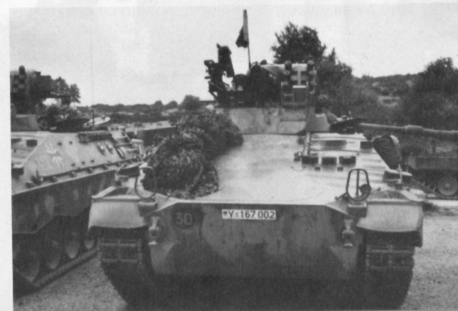
Unten: Dasselbe Fahrzeug; bemerkenswert – das Fehlen der Fahr-scheinwerfer und das mit Gurten befestigte Tarnnetz auf der Triebwerkraumklappe. Rechts im Hintergrund ein KPz LEOPARD 2 A3.
