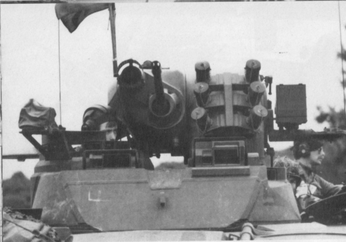
Links: Turm eines SPz Marder A1A2: Auf dem Turmgehäuse die beiden Ausblickköpfe des PERI Z11 (klein) und PERI Z16 (groß); darüber auf dem Waffenträger montiert die Nebelwurfanlage (sechs Nebelwurfbecher), daneben links das Waffenträgergehäuse mit BMK 20 mm und achsparallelem Maschinengewehr, rechts das kastenförmige Gehäuse des Wärmeortungsempfängers.
