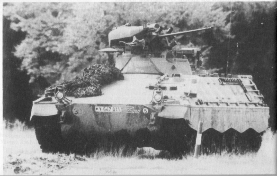
Oben und unten: SPz Marder A1+. Gut erkennbar die langen Abschleppseile, das Außenbordwerkzeug und die mit Gummi-Kettenpolstern austauschbaren Schneegreifer an der Wannen- seite.
