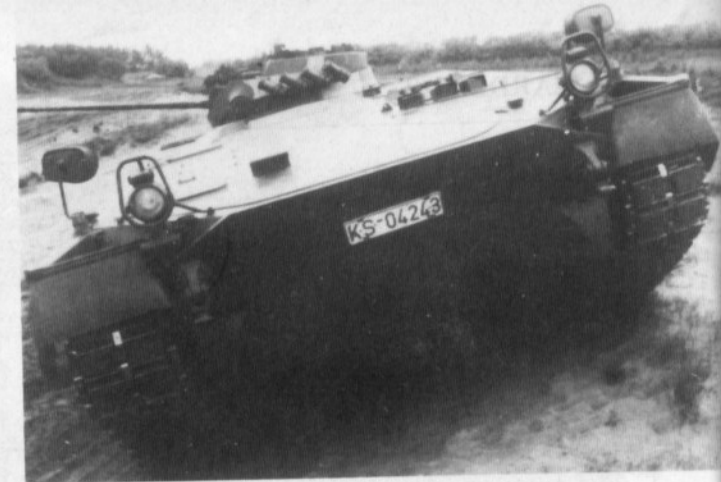
Dreiachsstablisierter Leichter Waffenturm (LWT 3) auf MARDER-Fahrgestell; ein interessantes und technisch aufwendiges Vorhaben – imponierend die niedrige Silhouette.
