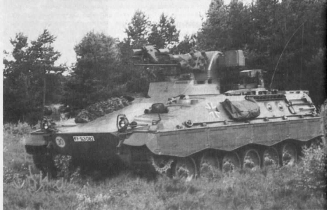
Oben und unten: SPz Marder A1+. Gut erkennbar die langen Abschleppseile, das Außenbordwerkzeug und die mit Gummi-Kettenpolstern austauschbaren Schneegreifer an der Wannen- seite.
