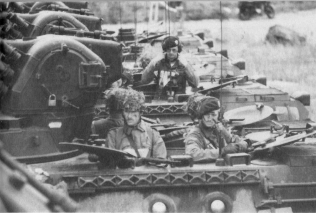
Oben: Blick auf den hinteren Kampfraum eines SPz MARDER A2. Die Schützen haben ihre Sturmgewehre G3 auf dem Dach abgelegt und bis auf den Truppführer, der sich mit einem Sprechsatz, Funk an die interne Bordverständigungsanlage angeschlossen hat, ihren Stahlhelm aufgesetzt. Erwähnenswert, die zehn Schneegreifer in einer schienenförmigen Halterung am oberen seitlichen Wannenrand.
