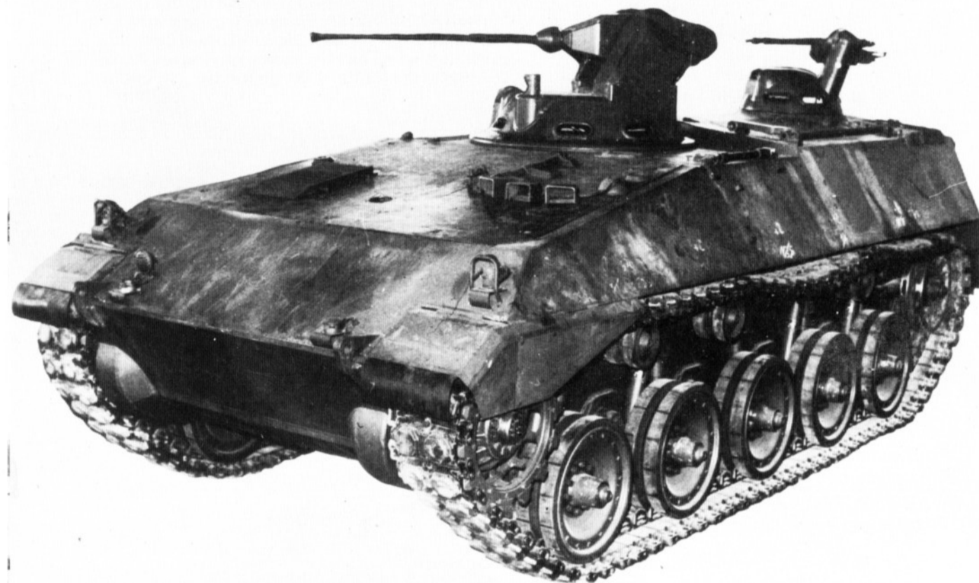
Der Prototyp RU 262, Schützenpanzer — neu der Fa. Hanomag besitzt rein äußerlich schon wesentliche Merkmale des Serienfahrzeugs SPz MARDER, wie z. B. die Scheitellafetten für die 20 mm-Maschinenkanone und für das Heck-Maschinengewehr sowie den Platz für den Triebwerkbloß im Fahrzeugbug.
