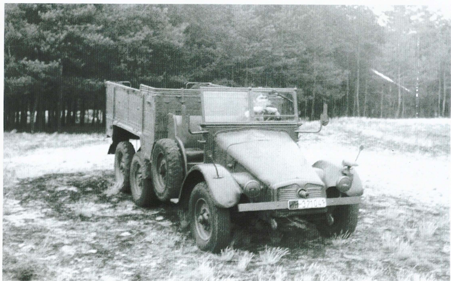
Bei Sechsradwagen mit zwei angetriebenen Hinterachsen, wie beim Krupp L2H143, wurden rund 70 % des Wagengewichts als Reibungsgewicht für den Antrieb ausgenutzt, bei Allradantrieb das Gesamtgewicht.
