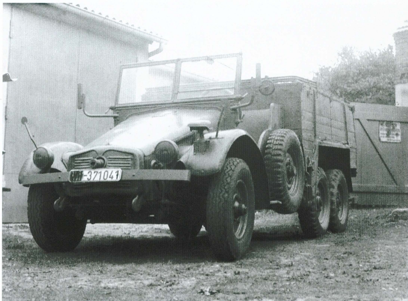
Mitte der dreißiger Jahre zählte der leichte geländegängige Lastkraftwagen 1,5 t L2H143 zu den neuzeitlichen Konstruktionen leichter Gelände-Lastkraftwagen. Um die erforderliche Geländegängigkeit zu erreichen, wurde über das Wechselgetriebe ein Zusatzgetriebe mit Gelände- und Straßengang angetrieben. Zusatzgetriebe und Achsantriebe für die beiden Hinterachsen sind fest am Rahmen gelagert.
