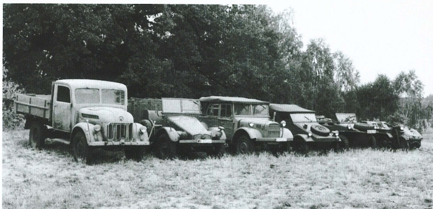
Verschiedene geländegängige Fahrzeuge der deutschen Wehrmacht. Von links: der leichte geländegängige (4x4) LKW 1,5 t Steyr 1500 a; der leichte geländegängige (6x4) LKW 1,5 t Krupp L2H143; der leichte geländegängige Einheits-PKW (4x4) Stöwer (Kfz. 1); der leichte geländegängige PKW (4x2) Typ 82 (Kfz. 1); der leichte geländegängige PKW Typ K1s (Kfz. 1/20); das leichte Kettenrad (Sd. Kfz. 2)
