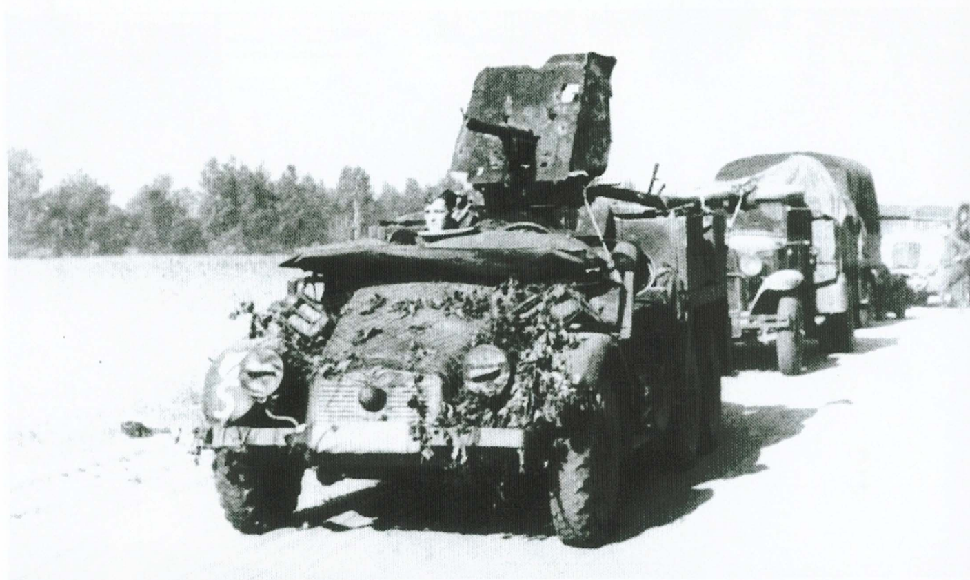
Die Panzerjägerzüge in den Panzeraufklärungsabteilungen erhielten 3,7-cm-Panzerabwehrkanonen L/45 auf Protzkraftwagen (Kfz. 69). Den Geschützen wurden die Räder abgenommen. Die Selbstfahrlafette zeichnete sich durch schnellere Feuerbereitschaft aus.
