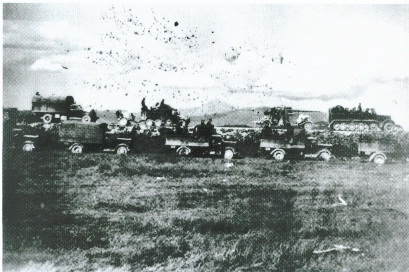
Aufmarsch einer schweren Flakbatterie der Luftwaffe. Vorn ein mittlerer Zugkraftwagen 8 t (Kfz. 7) mit angehängter 8,8-cm-Flak 18. Dahinter ein leichter Flakkraftwagen (Kfz. 81) mit angehängter 2-cm-Flak 30. Links im Bild und davor Munitionskraftwagen.
