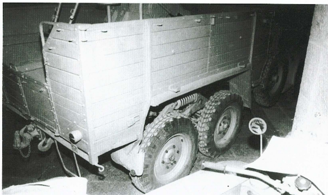
Gesamtansicht der beiden Hinterachsen mit dazugehöriger Abfederung.
