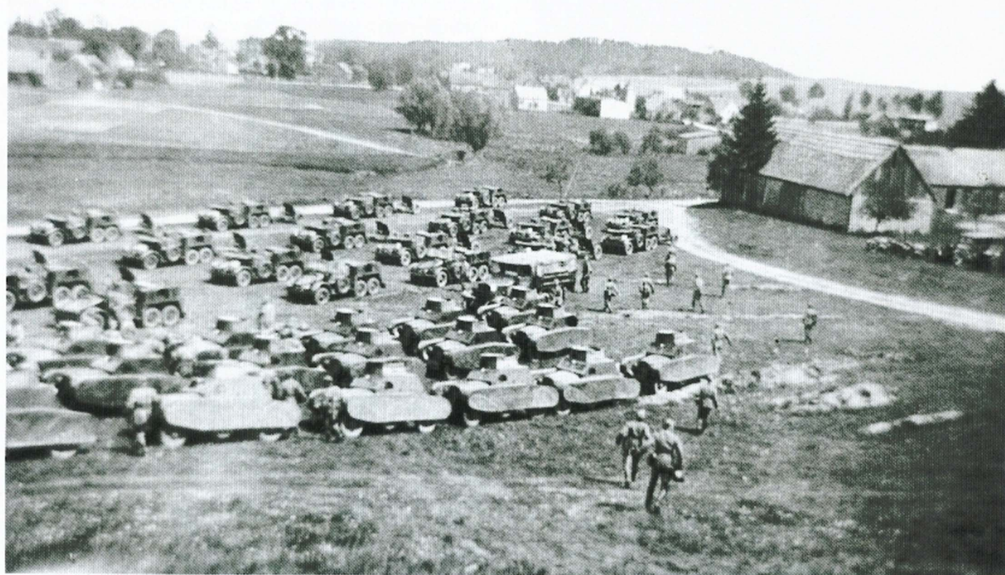
Das Bild zeigt die Fahrzeuge einer Panzerabwehr-Abteilung während eines Manövers in der Vorkriegszeit. Im Vordergrund eine Kampfwagen-Nachbildungs-Kompanie. Die Attrappen dienten während der Ausbildung zur Darstellung von Panzerangriffen.
