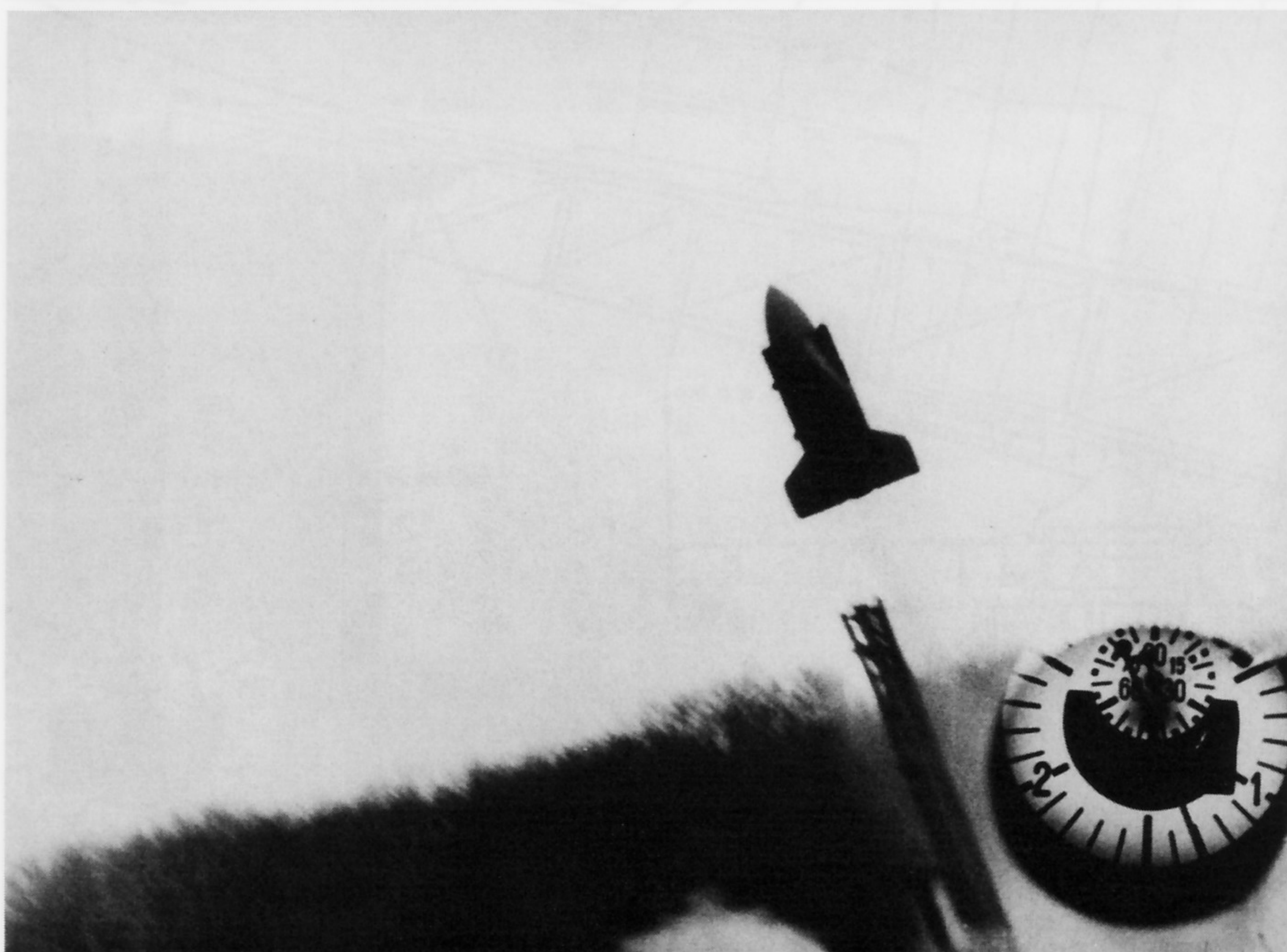
Der Anfangsschub der „Enzian“ (E1) betrug 15 kN. Der Antrieb hatte eine Brenndauer von 30 s.
