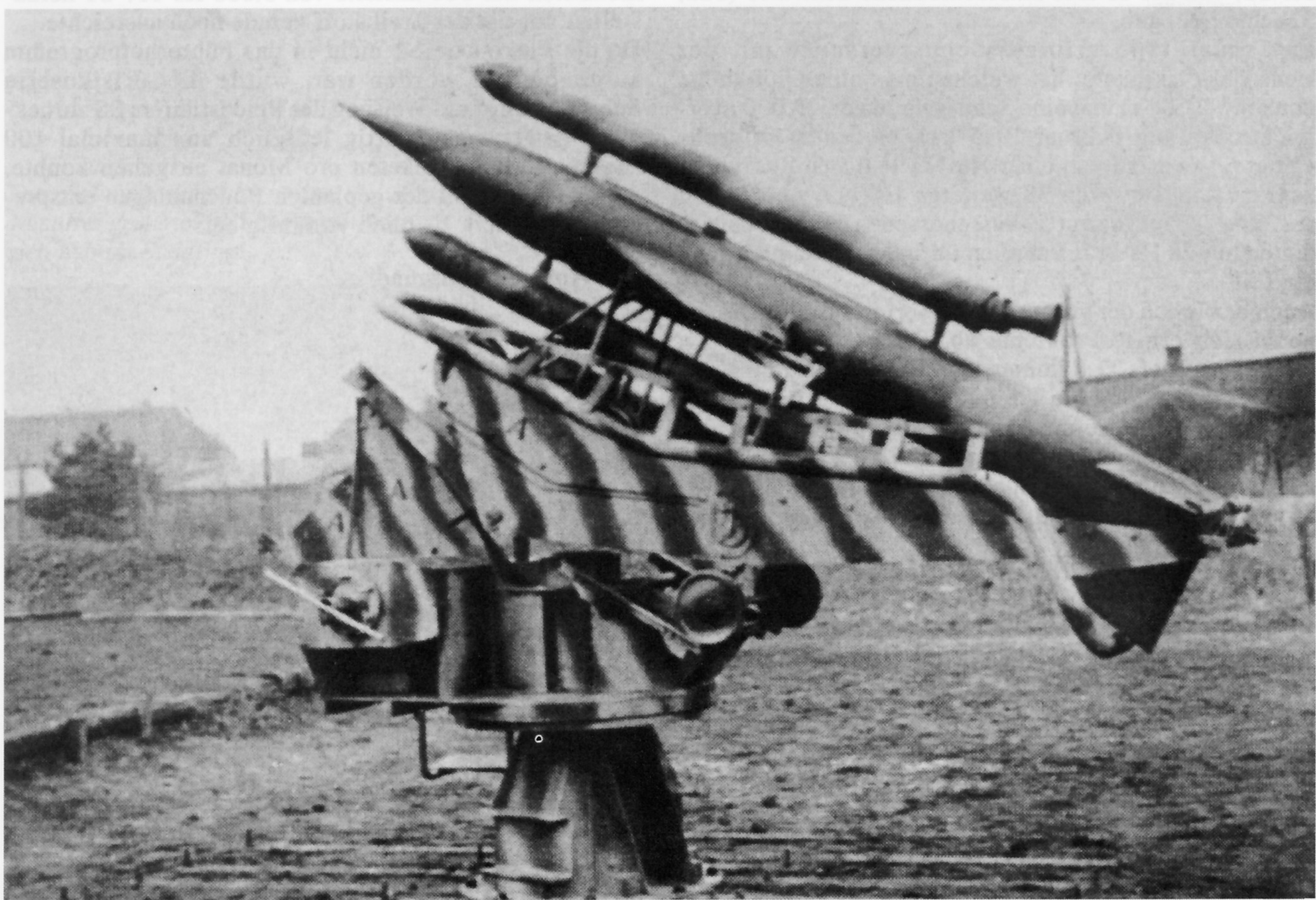
Detailansicht der um 360 Grad drehbaren Abschussgeräte, die in der Neigung verstellbar waren. Zu beachten sind die unterschiedlichen Tarnanstriche.
