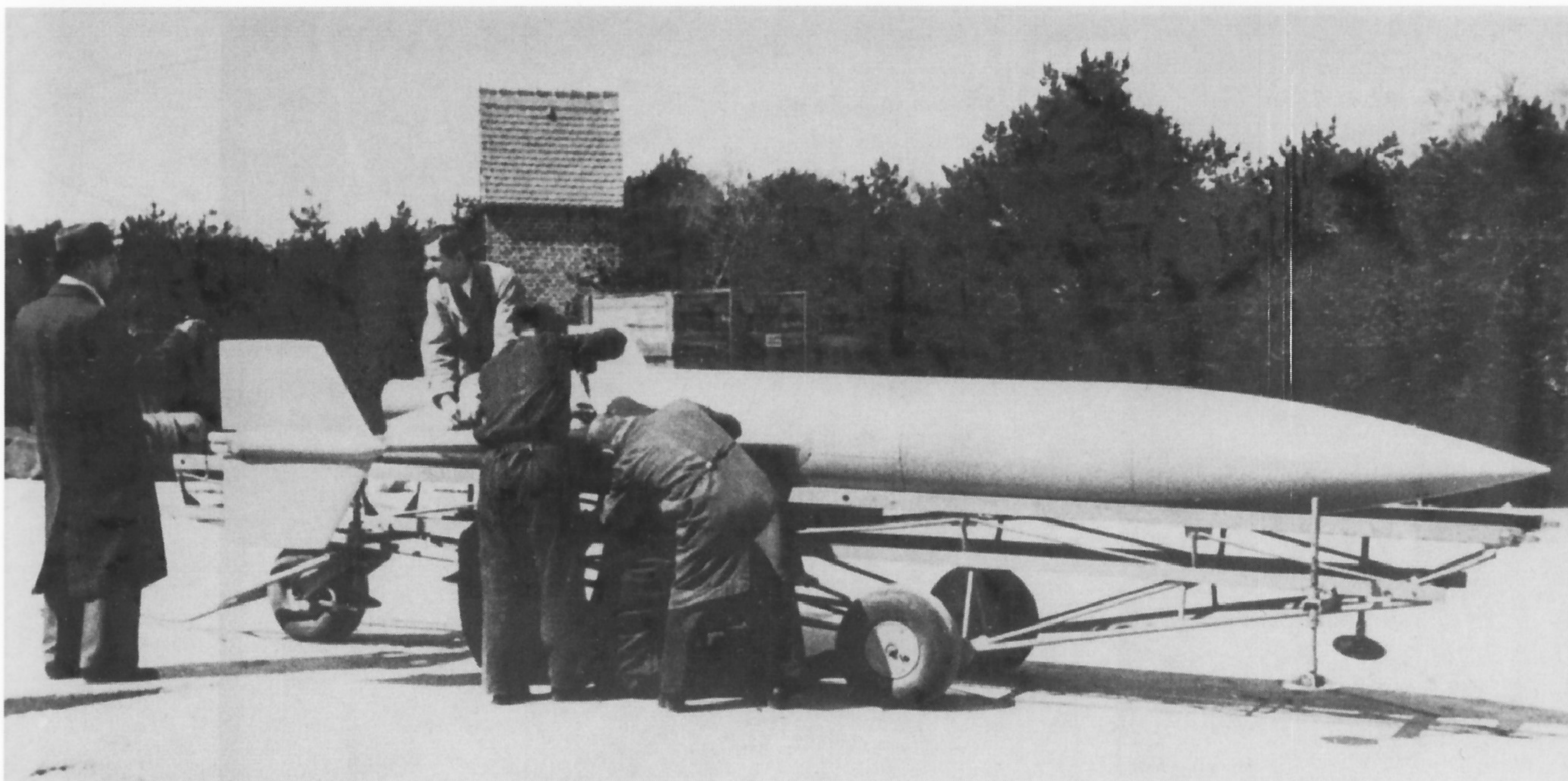
Letzte Wartungsarbeiten an einem Versuchsmuster der „Feuerlilie“ F 55.
