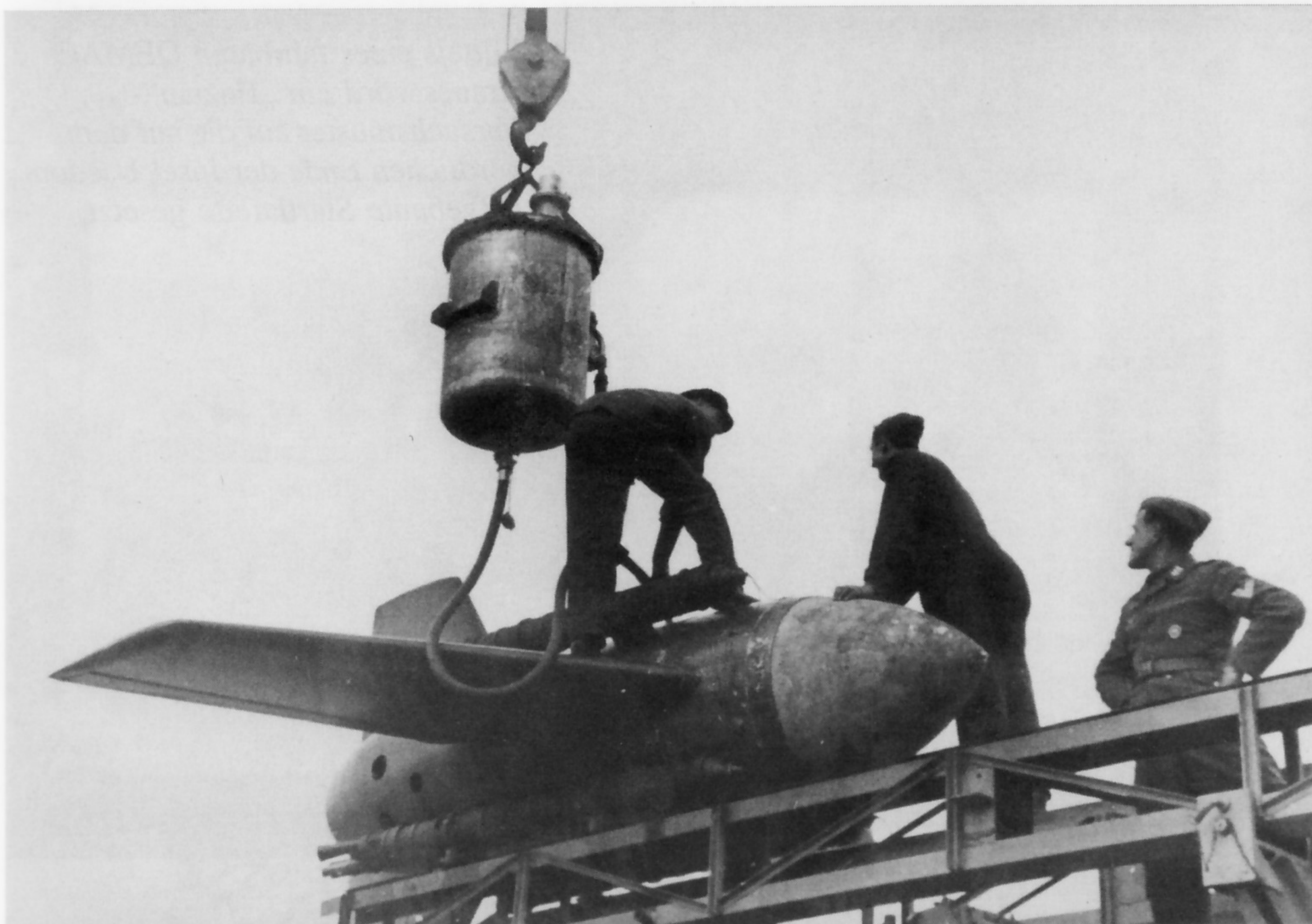
Fachpersonal der E-Stelle Peenemünde West beim Betanken einer „Enzian“ während der Steuerungs- erprobung des Geräts.
