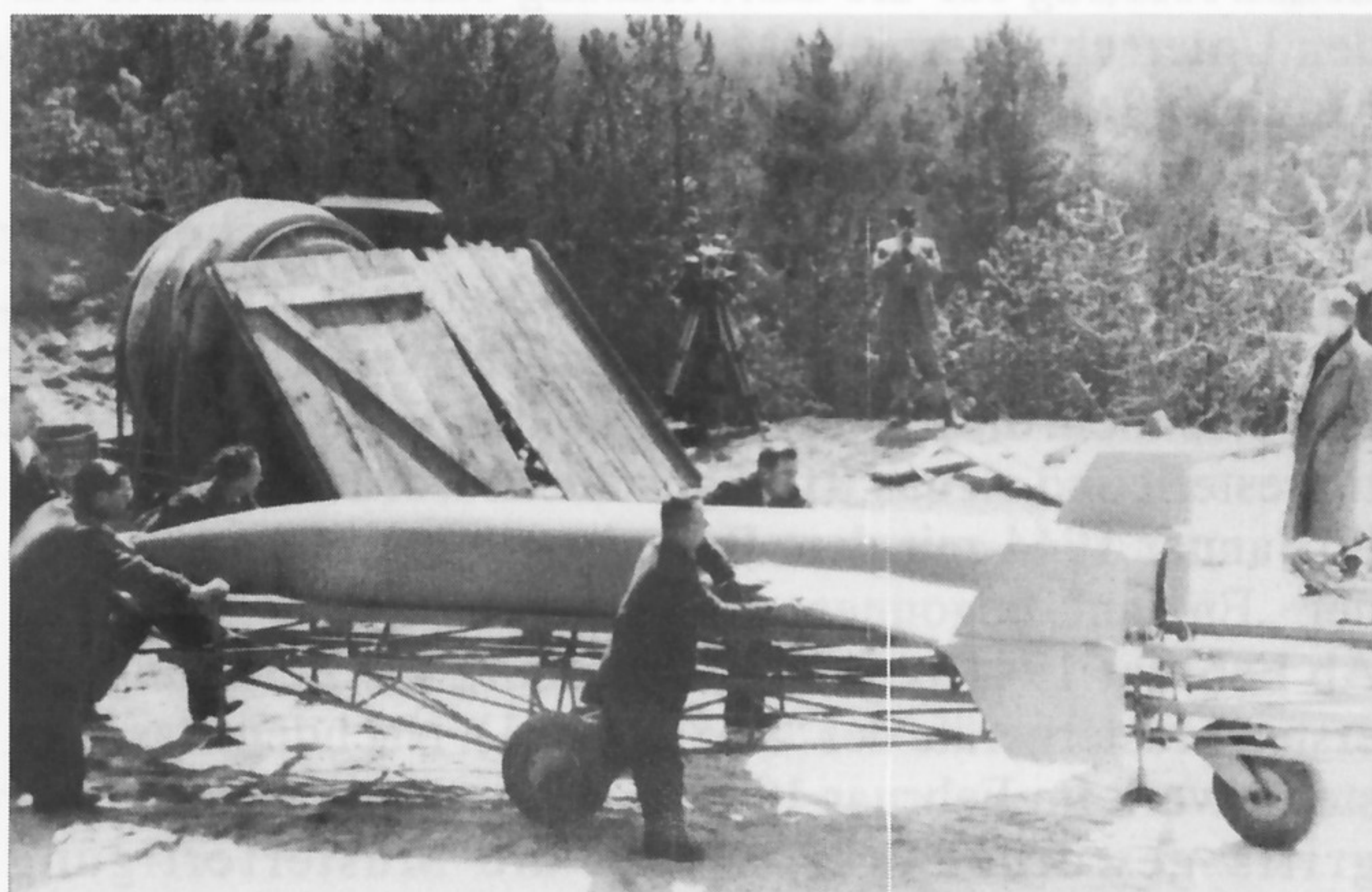
Triebwerkserprobung bei einer F 55, die von Mitarbeitern der LFA Braunschweig zum Prüfstand gerollt wird.
