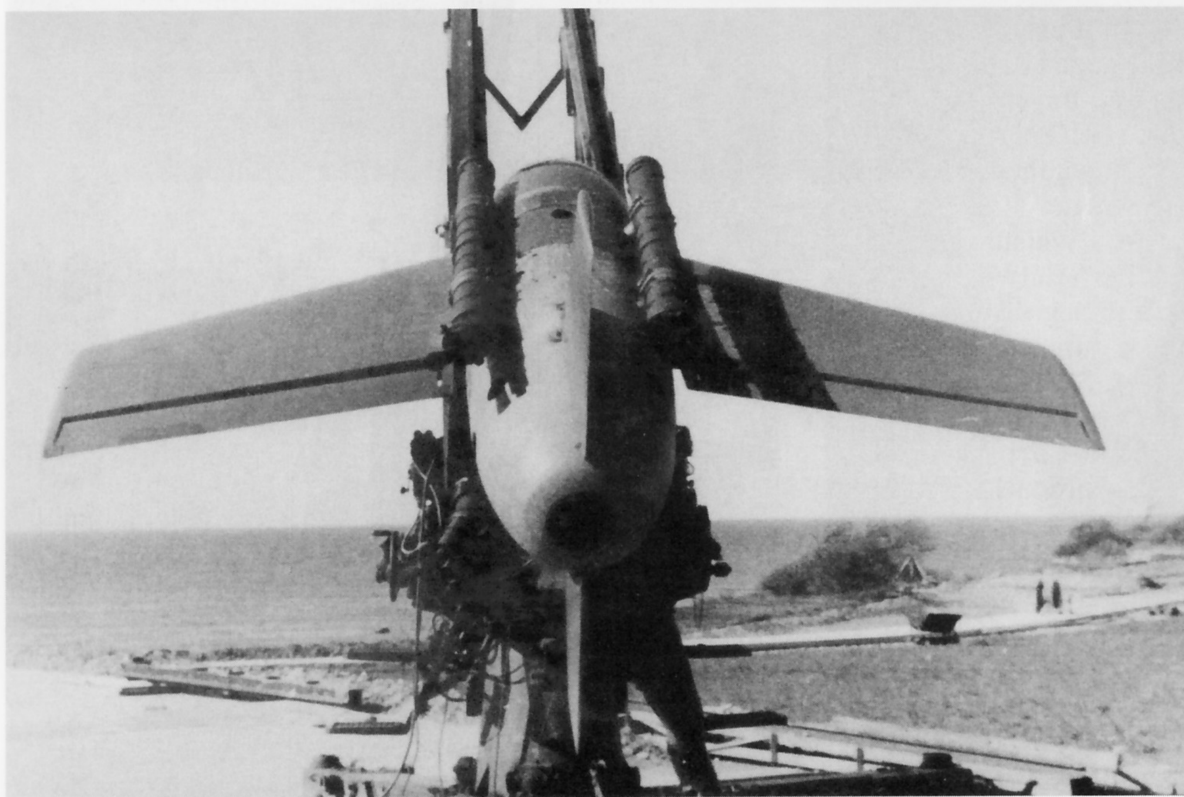
Zwei Nahansichten eines frühen Baumusters der Flakrakete "Enzian", bei denen die Austrittsdüse des Marschtriebwerks zu sehen ist.
