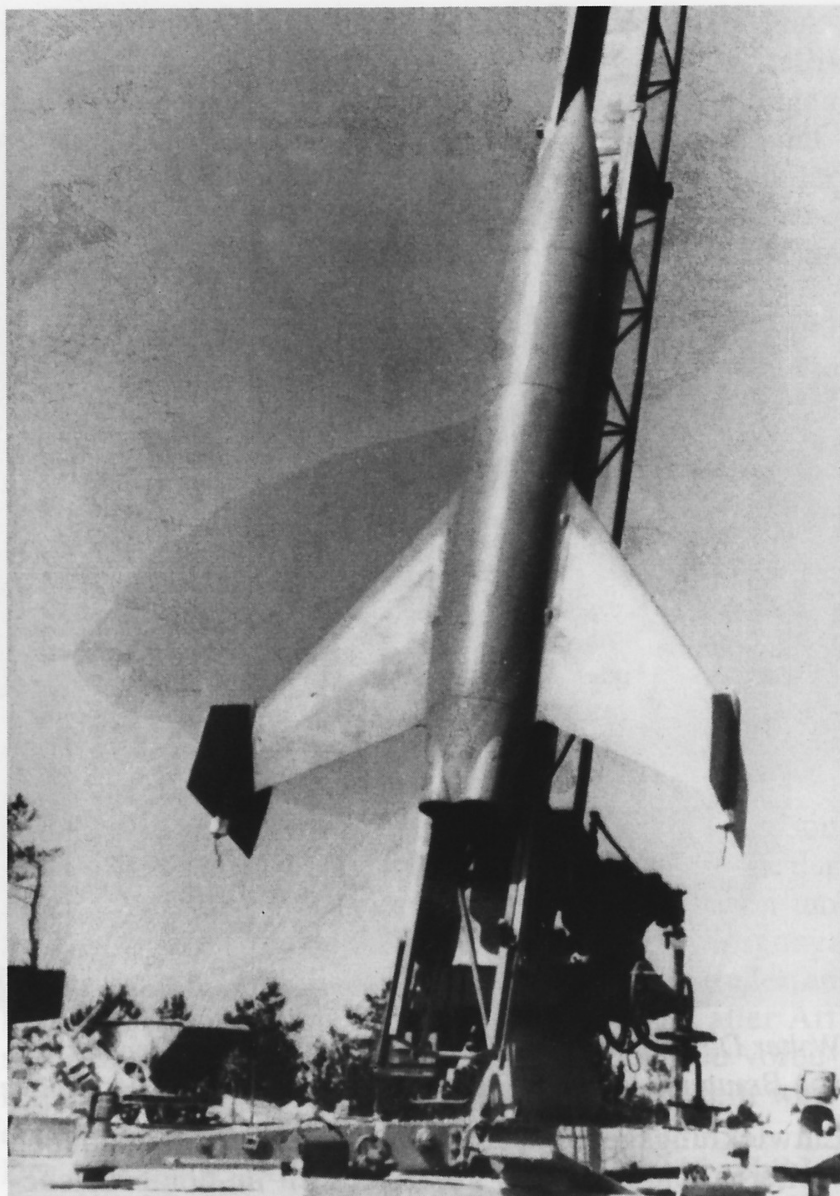
Nur zu Forschungszwecken dienten die verschiedenen Ausführungen der „Feuerlilie“. Auch für die F 55 wurde eine von der 8,8 cm Flak entlehnte Lafettenkonstruktion gewählt.
