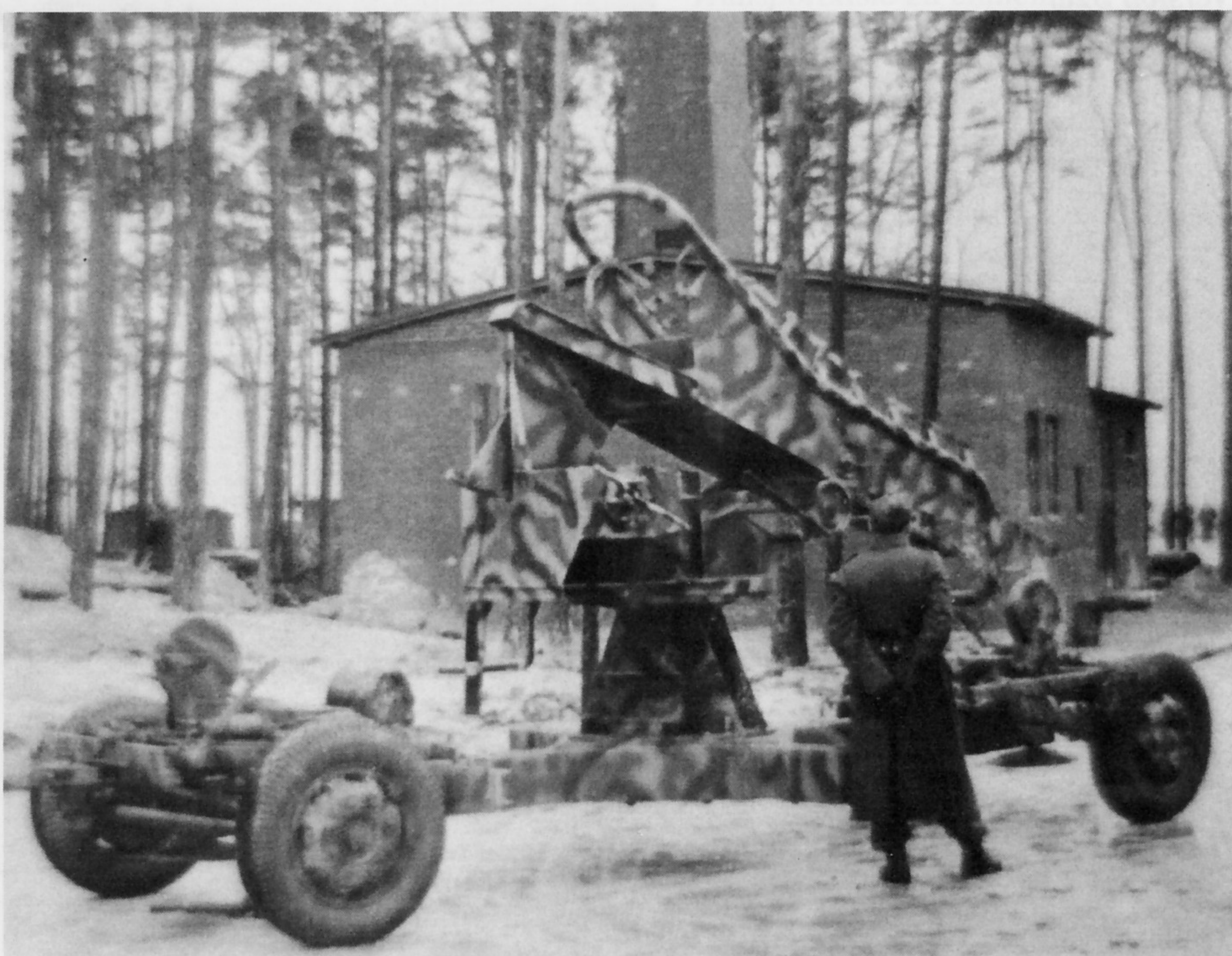
Infolge der sich ab Herbst 1944 rapide verschlechternden Kriegs- lage gelang es nicht, die Pläne zu realisieren, welche den Einsatz von beweglichen Batterien mit Raketenflak zum Schutz wichtiger Objekte vorsahen. Geräte wie dieses Abschussgestell für die „Schmetterling“-Batterien blieben daher nur Einzelstücke.
