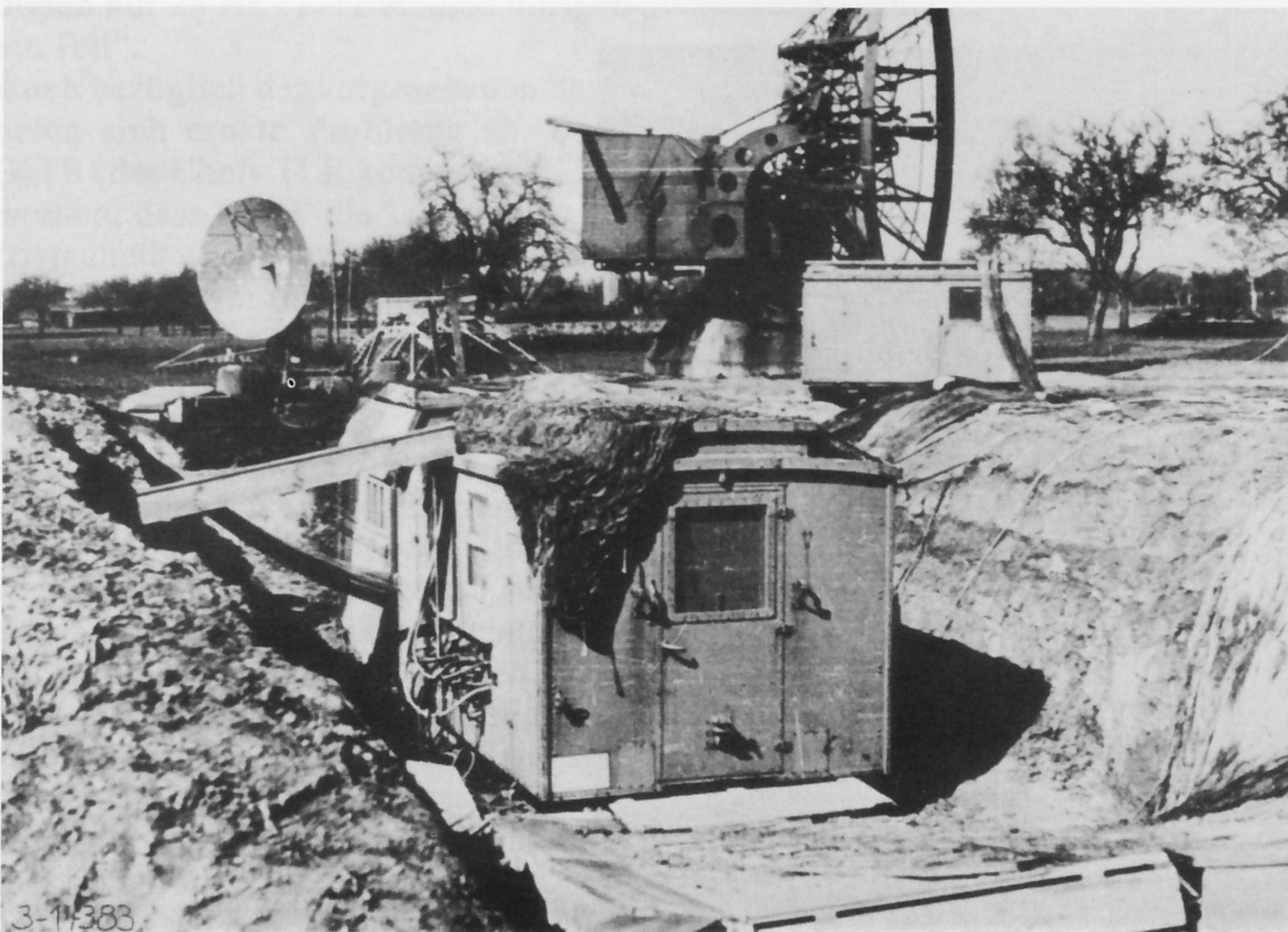
Zum Schutz gegen gegnerische Luftangriffe wurde der Bedienungs- wagen 74/76 splittersicher aufge- stellt. Im Hintergrund ein FuMG 62 „Würzburg“ sowie ein FuMG 65 „Würzburg Riese“.
