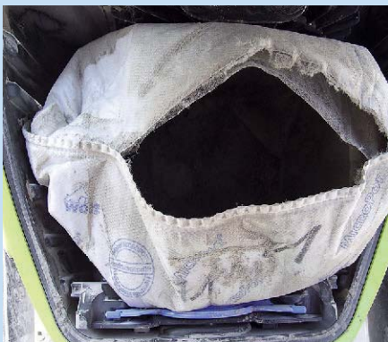
Geplatzt. Der Beutel von Wolf riss im AEG-Sauger beim Belastungstest auf.
