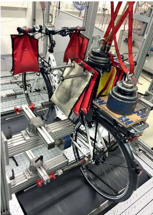
Auf dem Prüfstand. Gewichte ersetzen Fahrer und Gepäck. Holperleisten simulieren Kopfsteinpflasterstraßen und Schlaglöcher.
