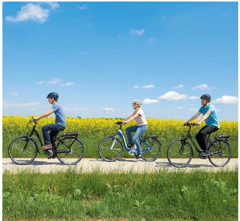
Bei Testfahrten. Prüfer reiten die elektrischen Drahtesel durch Süddeutschland. Sie bewerten das Verhalten beim Fahren, die Fahrstabilität mit und ohne Gepäck und andere Eigenschaften.
