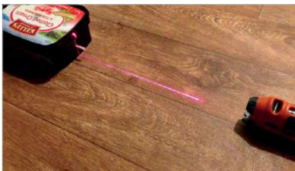
Oben Platzieren Sie die Laserlichtschranke zum Beispiel im Durchgangsbereich einer Türe – sozusagen als „Wachhund“
