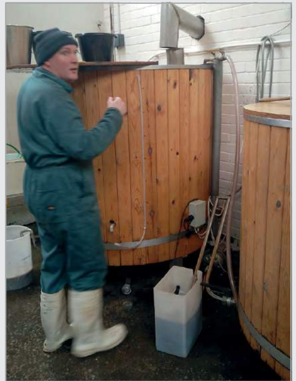
Brauhaus Ben pumpt das Bier während des Brauens in einen speziellen Tank. Dort läuft es durch einen Wärmetauscher
