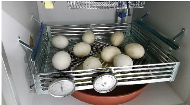
Der vollautomatische Brutschrank mit eingesetzter Schlupfhorde – © Archiv Michael Quetting
