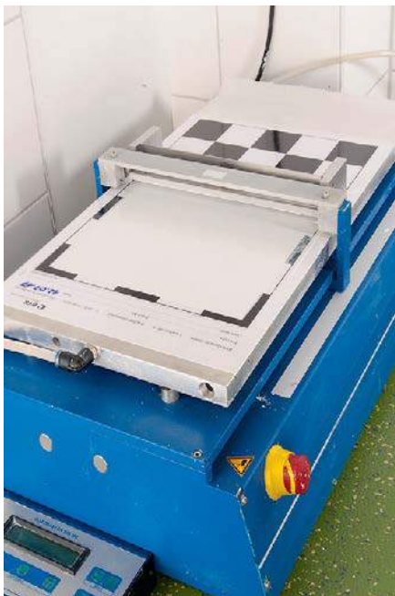
Deckkraftmessung. Ein spezielles Gerät überzieht schwarz-weiß-karierte Folie gleichmäßig mit Farbe.
