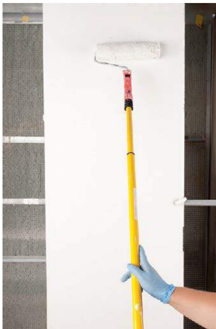
Streichen. Fünf Prüfer testen auf Gipskartonplatten, wie sich die Farben mit der Rolle verarbeiten lassen.
