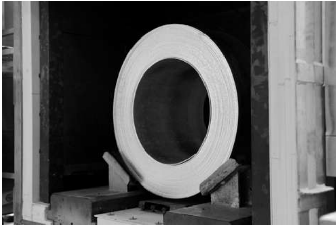
Abbildung 4.5 Geöffnete Kammer des Coilglühofens mit eingesetztem Gießwalsbandcoil
