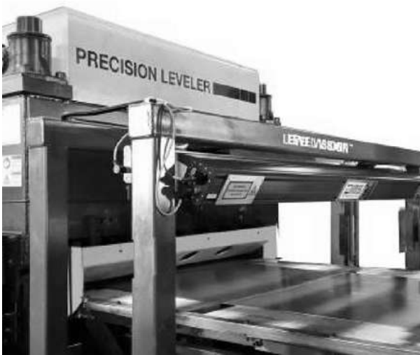
Abbildung 13.6 Installationsbeispiel Planheitsmessung und -Regelung (Leveller der Fa. Andritz Herr-Voss Stamco)
