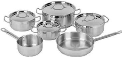
Abbildung 6.15 Kochgeschirr für induktives Kochen mit ferritischem Edelstahlkern und Kupferwärmeleitschichten, umgeben von korrosionsbeständigem 18/10-Edelstahl
