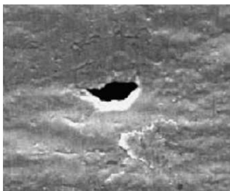
Abbildung 13.5 Pinhole in Aluminiumfolie, ca. \varnothing 25 \mu\text{m}
