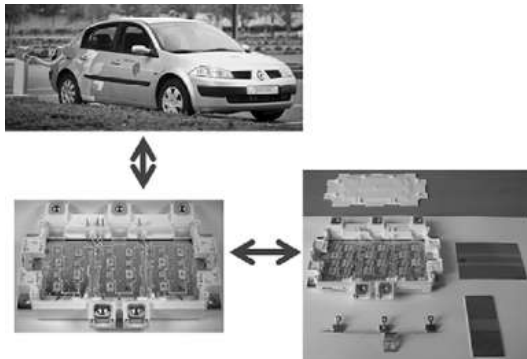
Abbildung 6.8 Halbzeuge, Stanzteile und einbaufertige Steuergehäuse der Leistungsschaltelektronik für die Ladesteuerung eines Elektrofahrzeuges mit lokal unterschiedlichen Banddicken bei Signal- und Leistungsleitungen
