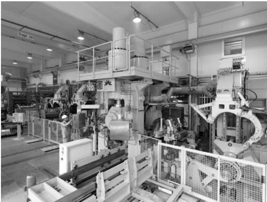
Abbildung 4.1 Gesamtansicht der Pilotanlage für Magnesiumband am Institut für Metallformung der TU Bergakademie Freiberg (vorn Quarto-Reversiergerüst mit Reversierhaspelanlage, linker Bildrand Gießwolzgerüst)
