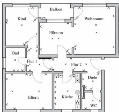
Elektro-Installationsplan einer Wohnung
