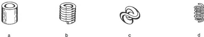
Abb. 167 a-d. Füllkörper-Formen. a) Glasring (Raschig-Ringe); b) Wendeln; c) Sattelförmig; d) Spirale
