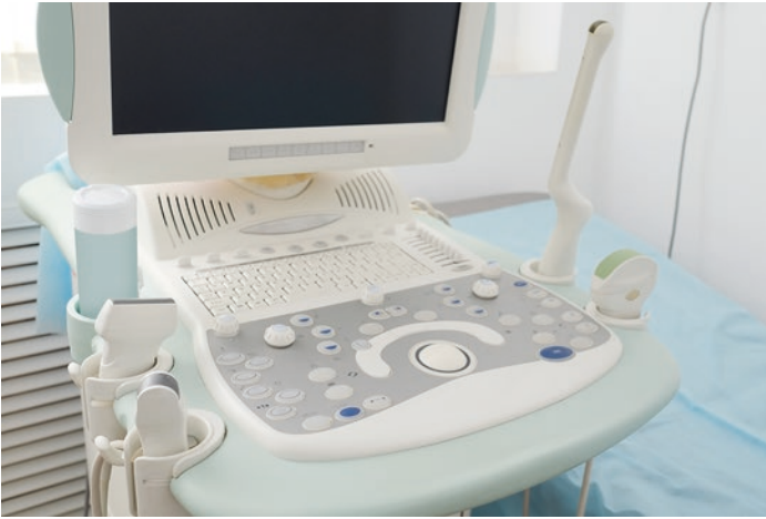
■ Abb. 2.1 Ultraschallgerät. Stabförmiger Schallkopf für den Scheidenumschall und Schallkopf für Bauchuntersuchungen (rechts), zwei kleinere, hochfrequente Schallköpfe (links), Behälter für das Ultraschallgel (hinten links) (© Dmitry Vereshchagin/Fotolia)
