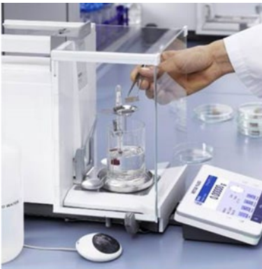
■ Abb. 3.8 Mettler Präzisionswaage mit einem Set zur Dichtebestimmung. (Mit freundlicher Genehmigung von Mettler Toledo, Greifensee, Schweiz)
