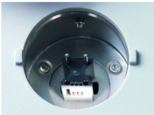
Abb. 8.5 Halterung für drei Schmelzpunktröhrchen in der Mitte und zwei Siedepunktröhrchen aussen. (Mit freundlicher Genehmigung durch Büchi Labortechnik AG, Flawil, Schweiz)
