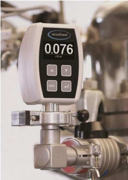
■ Abb. 9.7 Vakuummessgerät VACUU·VIEW extended mit kombiniertem Pirani- und Keramikmembransensor. (Mit freundlicher Genehmigung von VACUUBRAND GMBH + CO KG, Wertheim, Deutschland)
