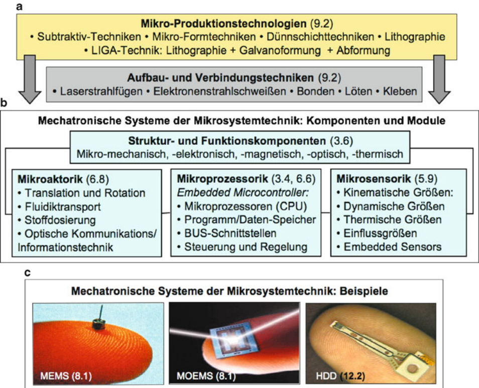
Abb. 10.3 Mechatronik in der Mikrosystemtechnik: die grundlegenden Module ( b ) und Technologien ( a )
