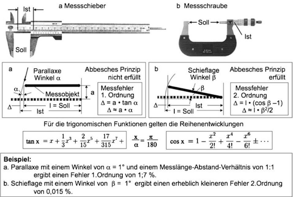
Abb. 5.25 Längenmesstechnik und das Abbe'sche Komparatorprinzip
