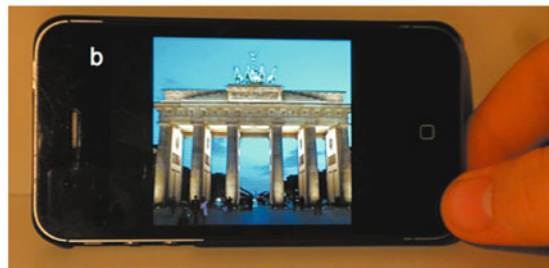
Abb. 5.44 Ein kapazitiver Positions-Mikrosensor steuert die Bildlageautomatik in Smartphones
