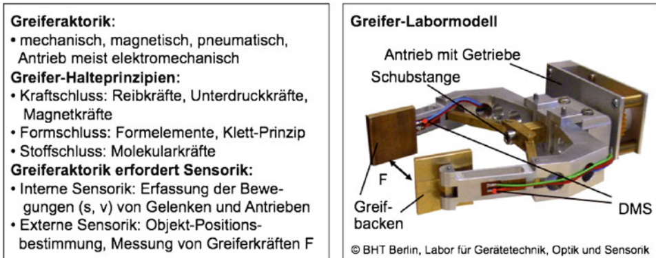
Abb. 8.13 Kennzeichen der Roboter-Greifertechnik und ein Greifer-Labormodell
