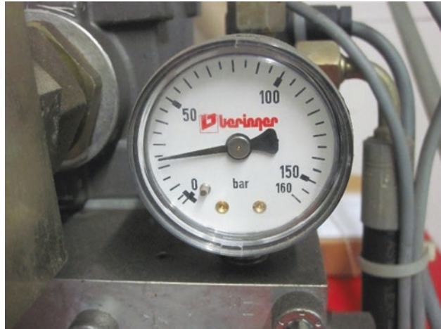
Abb. 4.39 Manometer am Regelblock (Quelle: Autor)
