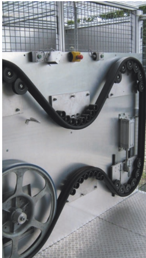
Abb. 19.24 Testeinrichtung für Handläufe (Quelle: Boettcher Systems, Gelsdorf)
