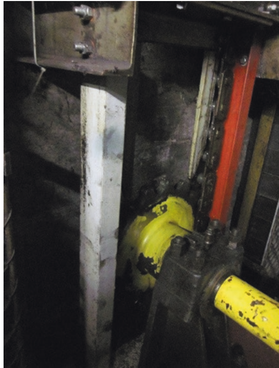
Abb. 4.49 Zahnrad auf Antriebswelle mit aufgelegter Stützkette (Quelle: Autor)
