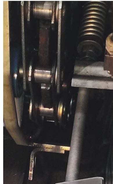
Abb. 19.4 Stufenkette im eingebauten Zustand (Quelle: Autor)
