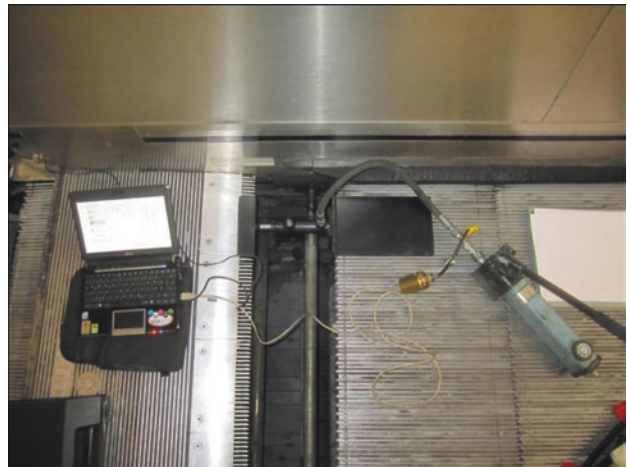
Abb 24.2 Testgerät im Einsatz an einer Kammplatte (Quelle: Henning GmbH, Schwelm)
