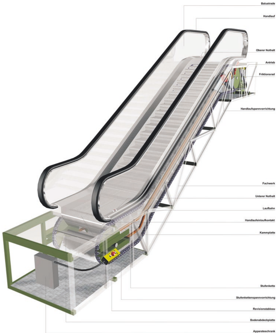
Abb. 18.3 Aufbau einer Fahrtrepppe (Quelle: Schindler Aufzüge und Fahrtreppen GmbH, Berlin)
