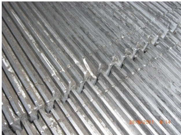
Abb. 23.5 abgebrochener Steg auf einer Fahrtreppenstufe (Quelle: Autor)
