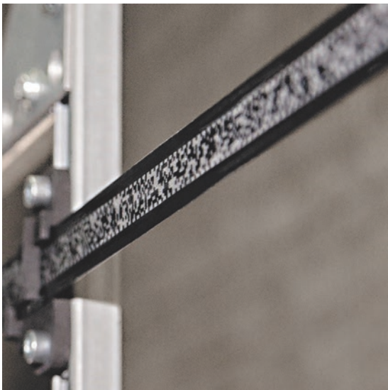
Abb. 4.14 Prinzip der EnDra Technologie (Quelle: Wachendorff Automation, Geisenheim)
