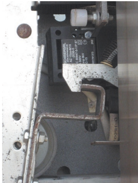
Abb. 4.81 Hakenriegel einer Teleskopschiebetüre (Ausführung Herstellerabhängig) (Quelle: Autor)
