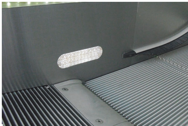
Abb. 19.2 Stufenbandbeleuchtung (Quelle: GEYSSEL Fahrtreppen, Köln)
