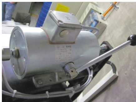
Abb. 4.112 Entlüftungseinrichtung mit Hebel (Quelle: Autor)
