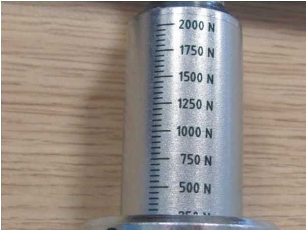
Abb 24.3 Skala zum Ablesen der Schubkraft (Quelle: Henning GmbH, Schwelm)
