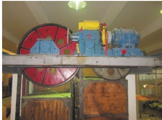
Abb. 5.14 Antrieb mit Umlenkrad (Quelle: TECHNOSEUM (Landesmuseum für Technik und Arbeit), Mannheim)
