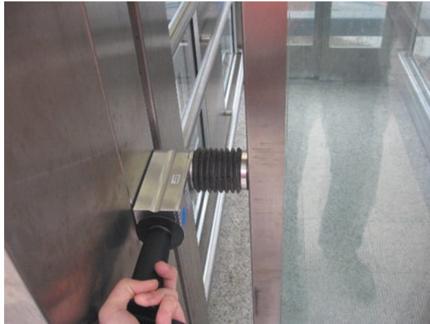
Abb. 7.3 Elektronische Türschließkraftmessung (Quelle: Autor)
