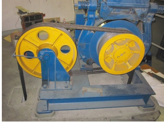
Abb. 4.27 Gleichstromantrieb mit doppelter Umschlingung (Quelle: Autor)
