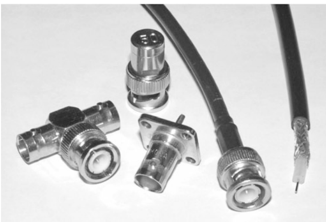
Abbildung 1.7 Koaxialkabel und -stecker. In der Mitte ein „50 Ω-Abschlusswiderstand“
