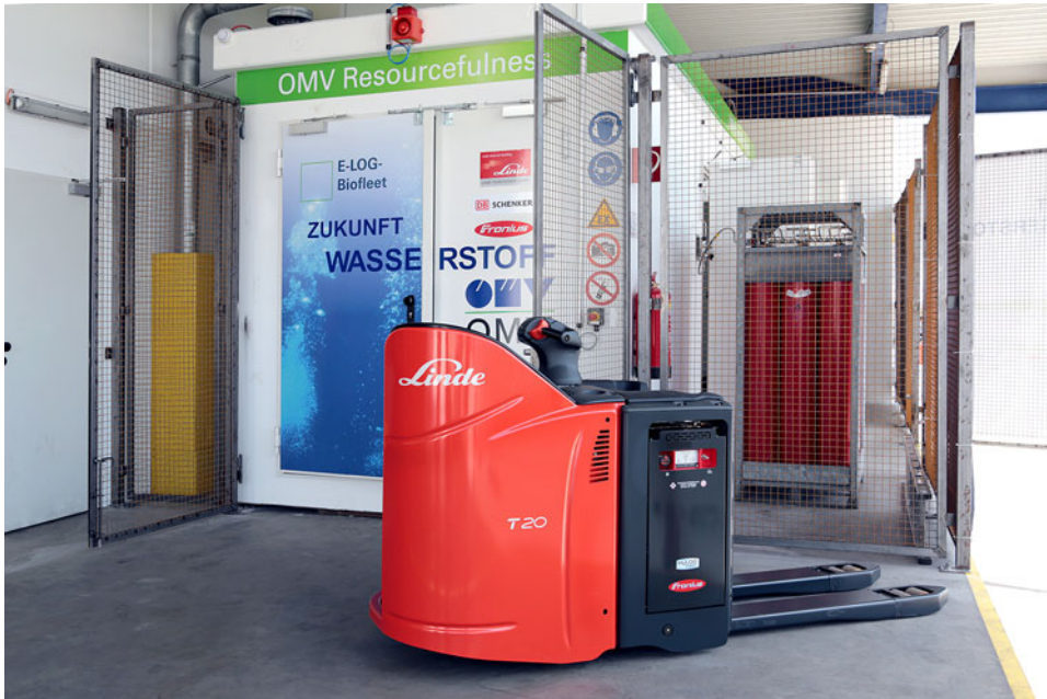
Abb. 6.40 Flurförderfahrzeug mit Brennstoffzellen Range Extender. (Quelle: Linde Fördertechnik, Fronius [119])
