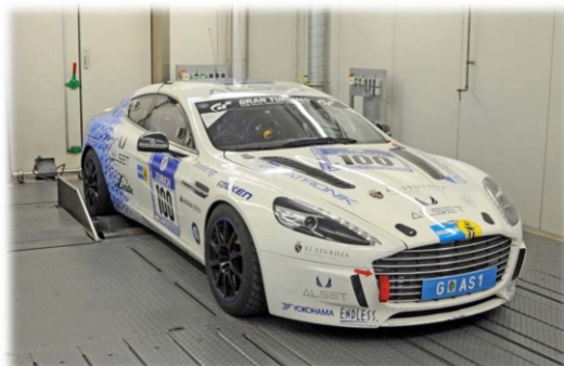
Rennfahrzeug mit bivalentem Antrieb (Wasserstoff/Benzin) und Turboaufladung
