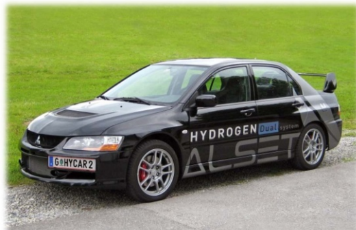
Fahrzeug mit bivalentem Antrieb (Wasserstoff/Benzin) und Abgasturbolader
