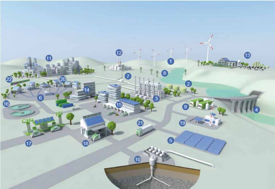
Abb. 1.21 Zukünftiges Energiesystem – WIVA P&G. Energiebereitstellung: 1 Windkraftwerk, 2 Biogasanlage, 3 Gaskraftwerk, 4 Wasserkraftwerk, 5 PV-Kraftwerk; Energieverteilung und -speicherung: 6 Regionales Gasnetz mit kommunalem Speicher, 7 Überregionales Gasnetz, 8 Stromnetz, 9 Zentrale Elektrolyse-/Methanisierungsanlage, 10 Wasserstoff-/Erdgasspeicher; Energienutzung: 11 Smart City und Zero-Emission öffentlicher Verkehr, 12 Grüne Industrieprozesse, 13 Energieautonome Landwirtschaft und Kleinbetriebe, 14 Smart Buildings, 15 Grüne Intralogistik, 16 Kläranlagen, 17 Wasserstoff-/Gas-/Elektrotankstelle, 18 Energieautonomes Einfamilienhaus, 19 Energieautonome Remote-Station, 20 Smart Village, 21 Zero-Emission Schwerverkehr, 22 Zero-Emission Schienenverkehr. (Quelle: Energieinstitut an der JKU Linz)
