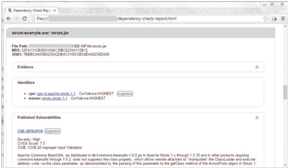
Abb. 4.13 Exemplarischer Bericht des OWASP Dependency Checks
