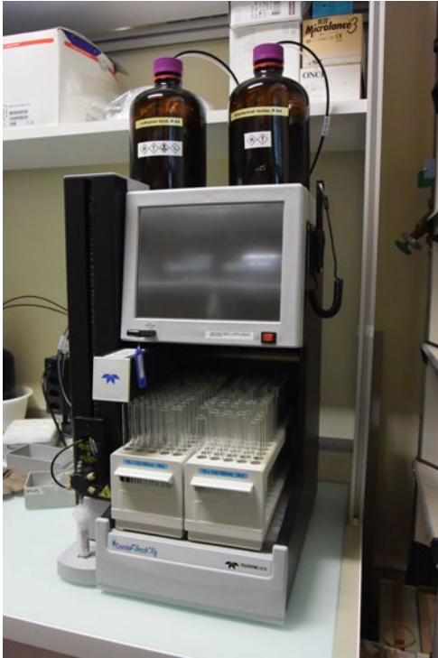
■ Abb. 17.6 Ein Beispiel für die instrumentelle Flash Chromatographie CombiFlash® Rf 50. (Foto aprentas)
