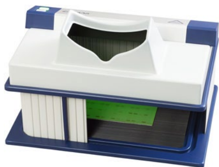
■ Abb. 16.9 UV-Betrachtungsgerät. (Quelle: ► www.camag.com ) (Mit freundlicher Genehmigung von CAMAG, Muttenz, Schweiz)
