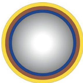
Abb. 19.8 WCOT Säulen sind ein Beispiel für Verteilungschromatographie an einer flüssigen stationären Phase. (Mit freundlicher Genehmigung von MACHEREY-NAGEL GmbH & Co. KG, Dueren, Deutschland)
