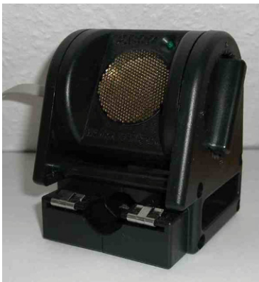
Abb. 5.14 Bewegungssensor EA-2 der Firma Casio
