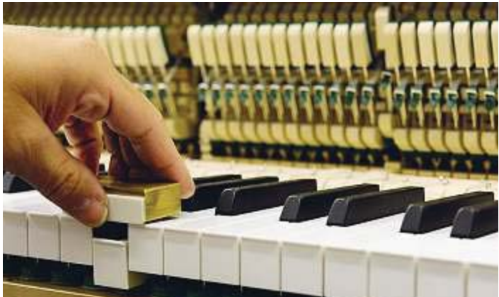
Diffizil einzurichten: die Tastenhöhe am Klavier Foto: dpa
