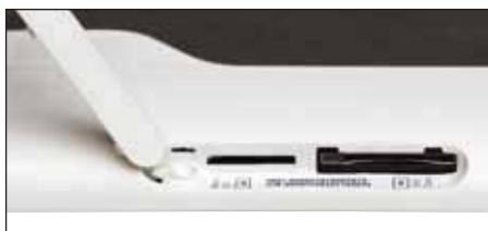
Die Slots für Sim- und microSD-Karte befinden sich sicher unter einem Deckel
