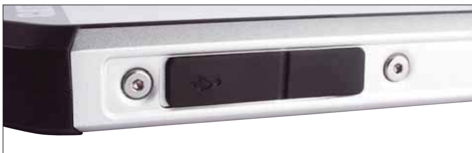
Der USB-Anschluss zum Laden und Synchronisieren ist ebenfalls mit einer Kappe vor Staub und Wasser geschützt
