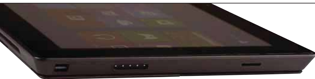
Displaybuchse, Ladeanschluss und microSD-Schacht finden sich an der abgeschrägten Kante des Surface
