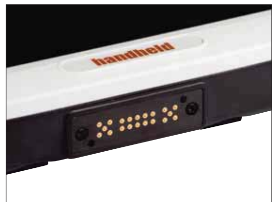
Die zentrale Kontaktstelle bietet schnellen Kontakt für Steuerungsanlagen und Ähnliches
