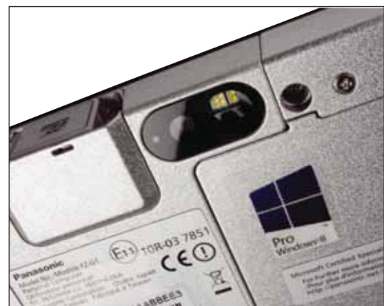
Die Rückseitenkamera verfügt immerhin über eine Auflösung von drei Megapixeln und eine Blitz-LED
