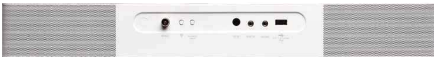
Auf der Rückseite gibt es neben dem Aux-Eingang für analoge Quellen sogar eine Kopfhörerbuchse
