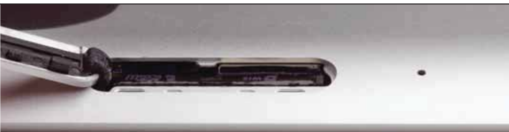
Das Fach für Sim- und SD-Karte ist nur mit Spezialwerkzeug zu öffnen, einer Büroklammer beispielsweise
