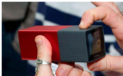
Lytro-Lichtfeldkamera in Aktion: Das Äußere der Lytro entspricht nicht dem klassischen Fotoapparat, sondern eher dem eines Kaleidoskops.
