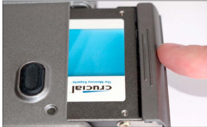
Die neue SSD samt angeschraubter Blende wird ganz einfach in den Festplattenschacht geschoben.
