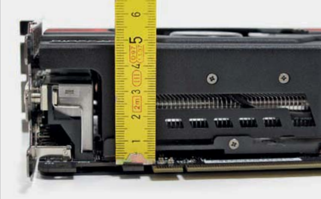
Asus HD 7970 Direct Cu II: Rund 4,9 Zentimeter breit (effektiv Triple-Slot)
