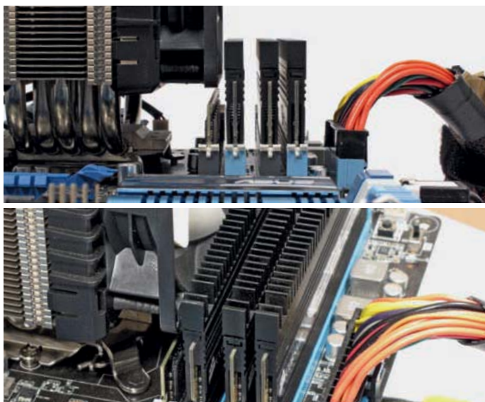
Falls der CPU-Kühler über die RAM-Slots ragt, kann es nötig sein, die Heatspreader zu entfernen – oder gleich Speichermodule ohne Kühlbleche zu kaufen.
