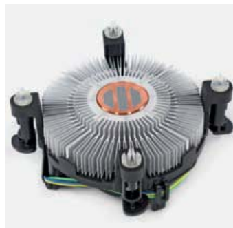
Intels Sandy-Bridge-Portfolium verfügt entweder über den Aluminium-Boxed (alle Pentiums, Celerons sowie die 45/-35-Watt-CPU) oder über das Modell mit Kupfer-Kern.
