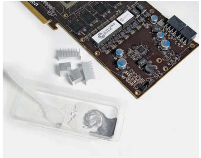
Das Mischen des Arctic-Zweikomponentenklebers, das Befestigen der Wandler-Kühlerchen und das anschließende fünfstündige (!) Aushärten ist sehr zeitaufwendig.
