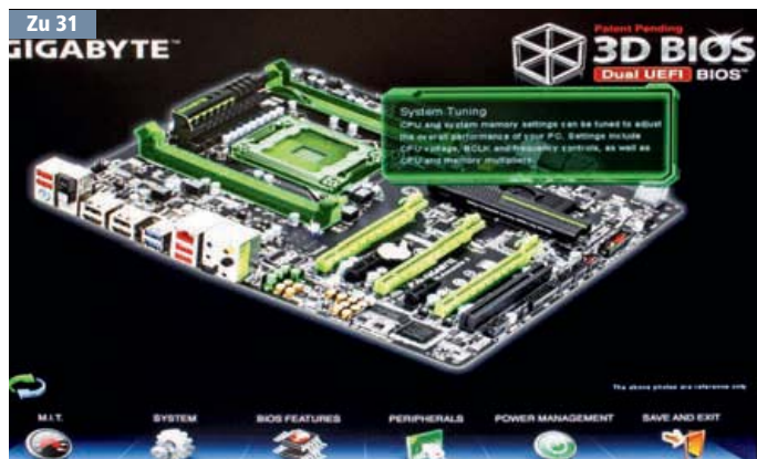
Bei seinen Sockel-2011-Boards bietet Gigabyte erstmals UEFI statt BIOS. Das abgebildete Menü ist aber unnötig kompliziert – mit „F1“ gelangen Sie zur besseren Übersicht.
