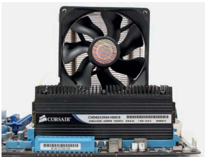
Bei vielen Turm-CPU-Kühlern liegen die Kühlrippen der Speichermodule direkt im Luftstrom – die Temperatur der Speicherchips kann dadurch sinken.
