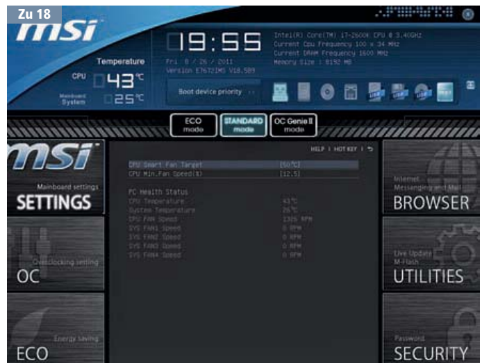
Zu 18 Bei vielen Asrock- oder MSI-Boards muss die Lüftersteuerung manuell aktiviert werden. Die abgebildeten Werte haben sich im Praxiseinsatz bewährt.
