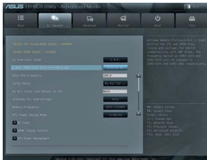
Falls Ihr RAM XMP unterstützt, können Sie bei den meisten Boards mit Intel-Sockel die richtigen Einstellungen per Profil automatisch laden.
