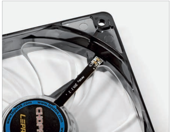
Der Leuchteffekt der Chopper wird durch ein mit LEDs bestücktes Ärmchen erzeugt, das mit dem Rotor dreht. Der Lüfter bleibt mit maximal 900 U/min sehr leise.
