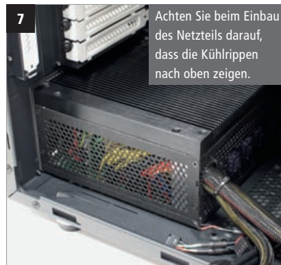
Im nächsten Schritt sollten Sie das Kabelmanagement vorbereiten. Achten Sie darauf, die Kabel an der richtigen Stelle durch die Öffnungen zu führen. Durch die gezielte Verkabelung wird der Luftstrom optimiert.
