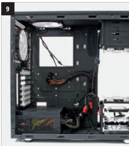
Bevor das Mainboard ins Gehäuse gesetzt wird, müssen Sie noch die I/O-Blende, die Gehäuselüfter und die Abstandshalter montieren.
