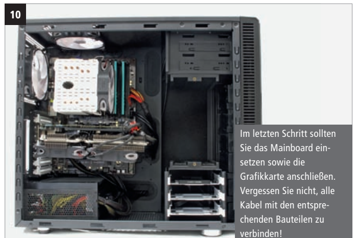
Die Festplatte sollte in einem Festplattenkäfig verschraubt werden.
