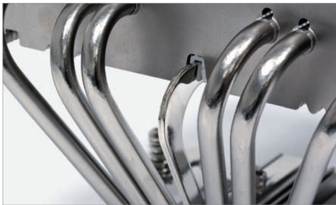
Dieser Bügel (Mitte) verhindert beim NH-C14 das Verbiegen der Heatpipes durch das eigene Gewicht. Dies ist vorteilhaft, wenn der Rechner oft transportiert werden soll.
