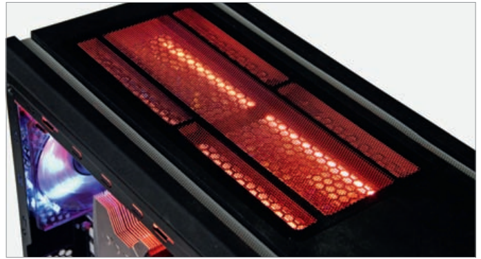
Unter dem Gehäusedeckel sitzen zwei rote 30-cm-Kathoden zur indirekten Beleuchtung. Neben dem Innenraum wird auch noch die Umgebung etwas angestrahlt.
