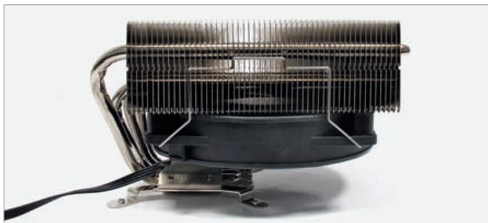
Durch das Versetzen des Lüfters unter den Kühlkörper lassen sich bei vielen Top-Flow-Modellen noch einige Zentimeter bei der Höhe einsparen.
