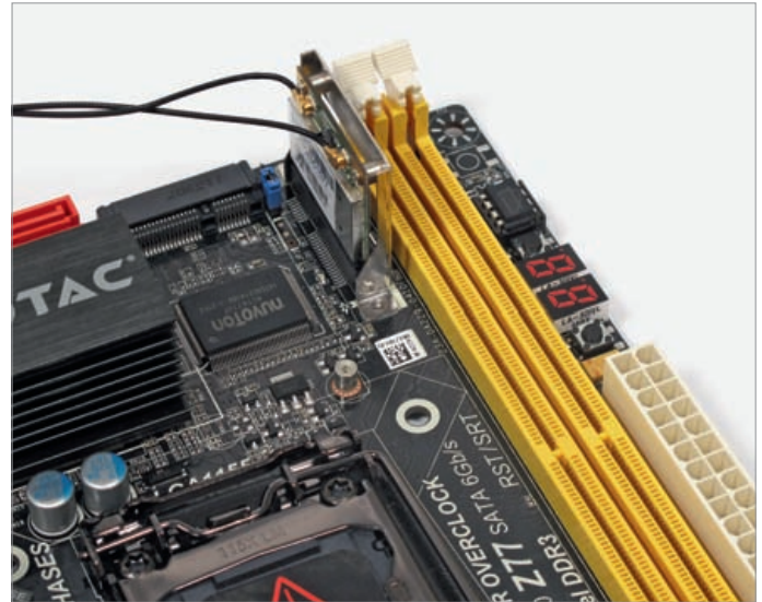
Bei dem Zotac Z77-ITX Wifi können Sie eine MSATA-SSD einbauen. Zudem lässt sich die WLAN-Karte im Mini-PCI-E-Slot bei Bedarf tauschen.
