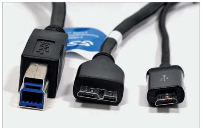
Links die beiden Stecker, die unser Testfeld verwendet: USB 3.0 Typ B und USB 3.0 Typ Micro-B. Rechts ein herkömmlicher Micro-USB-Stecker zum Vergleich.
