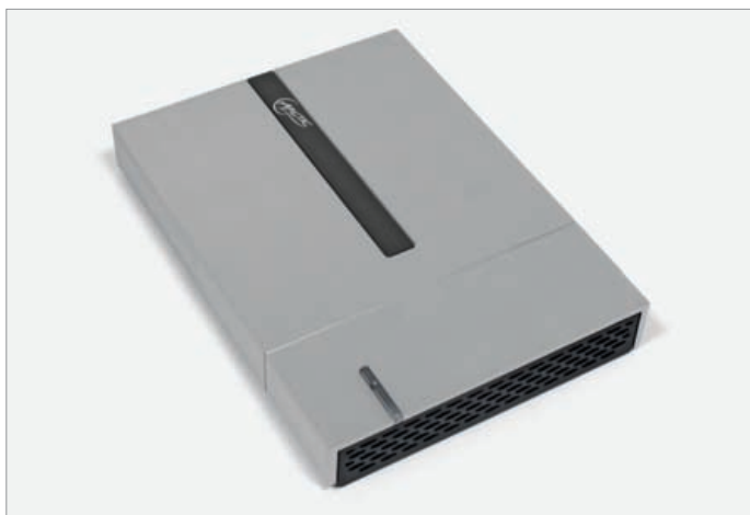
Bei Mini-Komplett-PCs gibt es sehr kompakte, abgestimmte Systeme wie den neuen MC101 von Arctic mit einer Größe von nur 3,5 x 22,5 x 17 cm und AMDs Trinity-APU.
