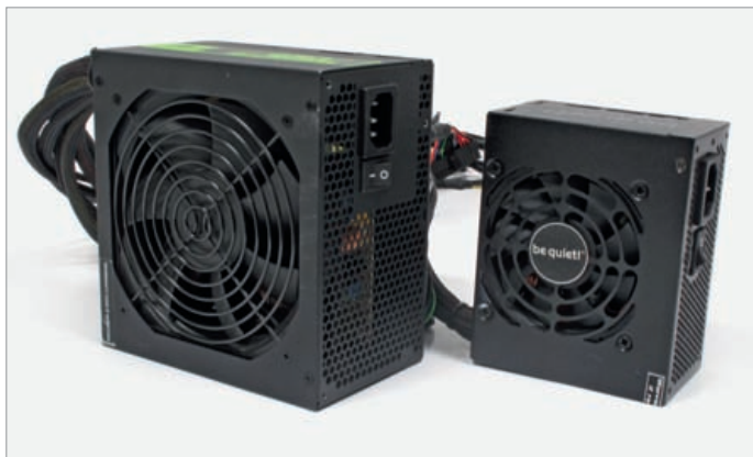
In manche Mini-Gehäuse passt nur ein kompaktes SFX-Netzteil. Solche Netzteile sind etwas teurer als ATX-Modell und haben natürlich einen kleineren Lüfter.
