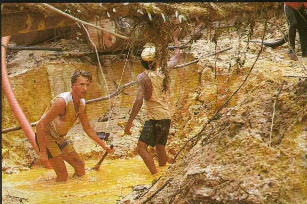
Der goldstaubhaltige Schlamm wird abgesaugt.
