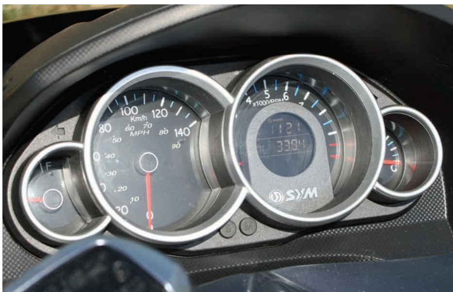
Optisch gelungen präsentieren sich die analogen Rundinstrumente des Cockpits. Die eigensinnig angeordneten digitalen Anzeigen für Kilometerstand und Uhrzeit sind dagegen bei Sonne schlecht ablesbar.
