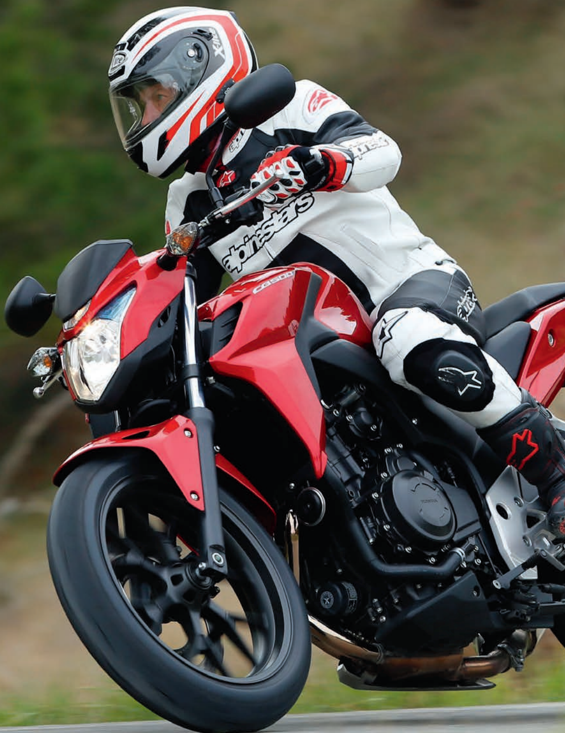
Eine Wave-Scheibe vorne und ein serienmäßiges ABS sorgen für ordentliche Verzögerung.
