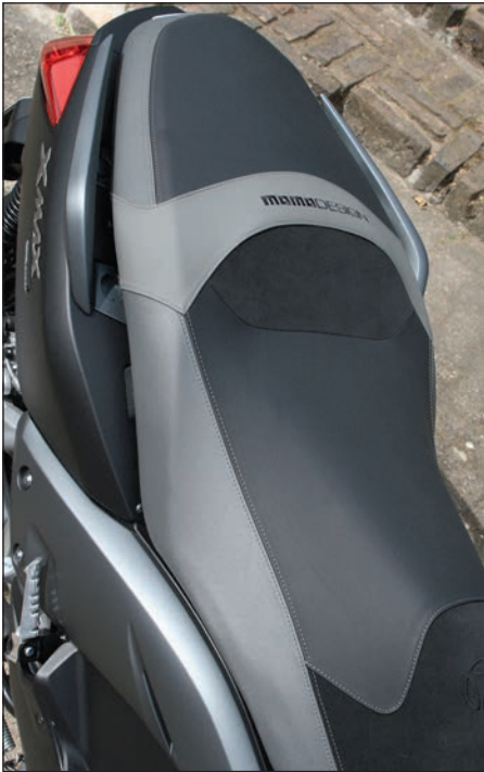
Ergonomie des Besonderen: Auf der speziellen Sitzbank genießt der untere Rücken einen guten Halt, die Alu-Auflagen auf den vorderen Ablagen sind dagegen eine rein optische Verbesserung.
