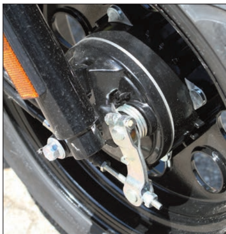
Spurmaßnahmen: kein rechter Spiegel und kein E-Starter (rechts), Trommelbremse vorne (unten).
