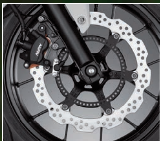
Eine Wave-Scheibe vorne und ein serienmäßiges ABS sorgen für ordentliche Verzögerung.
