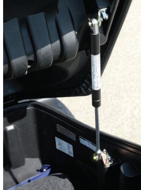
Nach Betätigung des Sitzbanköffners hält eine Gasdruckfeder das Abteil offen. Das erleichtert das Beladen des Stauraums erheblich.
