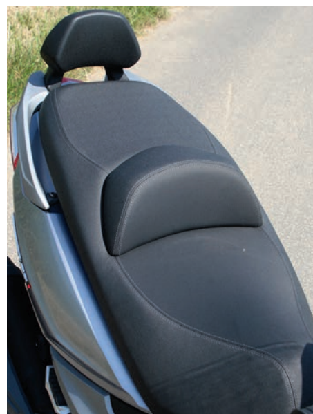
Großzügig bemessen ist die Fläche der gestuften Sitzbank mit Lendenwirbelstütze und Sissybar.
