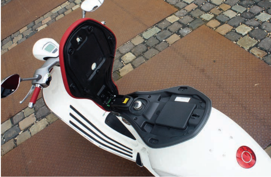
Die aufklappbare Sitzbank gibt den Weg frei zum Tank und einer kleinen Ablage fürs Bordwerkzeug.
