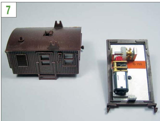
7 Reparaturen sind nie völlig auszuschließen, deshalb sollten Kranhaus und Kranhausboden auf keinen Fall dauerhaft verklebt werden.
