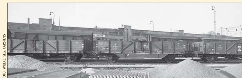
Die Bundesbahn verstärkte in den 50er-Jahren einige Ommr 32 mittels angeschweißter Blechträger; Stuttgart Hauptgüterbahnhof 1963.
