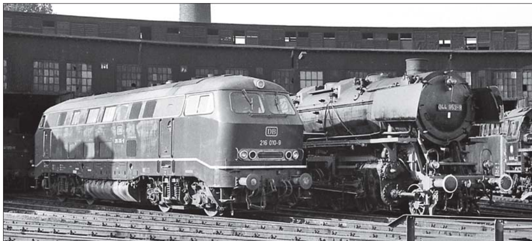
Treffen der Generationen im Bw Gelsenkirchen-Bismarck am 12. Oktober 1975: 216 010, die letzte Vorserienmaschine, die bereits das spätere Serien-Antlitz erhielt, und 044 953. 216 010 ist auch gut am Hüftknick und der typischen Vorserien-Tankform zu erkennen.
