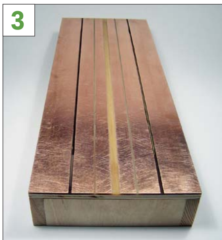
Die Längstrennung der kupferkaschierten Hartpapierplatte sollte geschwärzt werden.
