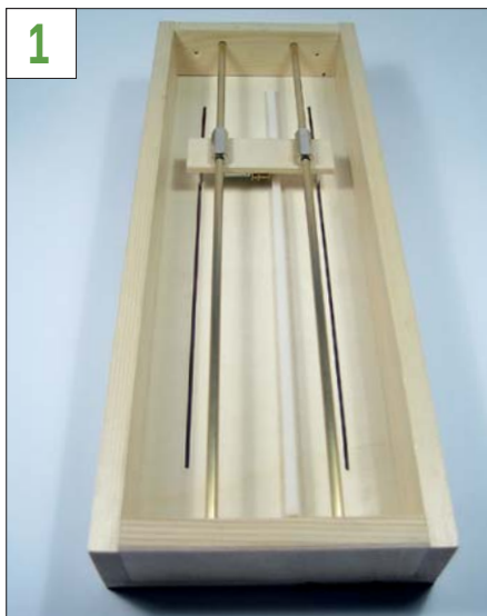
Der Blick unter die Grundplatte zeigt die Mechanik samt Schlitten und Führungen.
