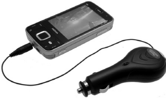
Bild 9.4 Ausziehbare Kabel sind praktischer als Spiralkabel
