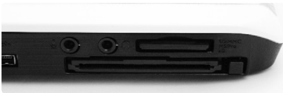
Bild 2.5 Slots für Speicherkarten (oben), Erweiterungskarten (unten)
