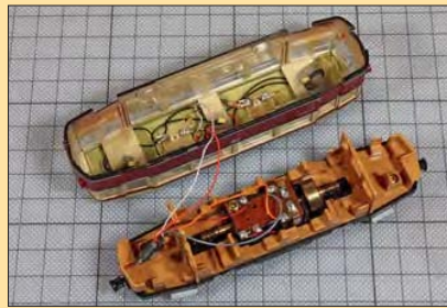
Über einen Digitaldecoder ist die Beleuchtung des Fahrzeuges steuerbar. Hierzu sind keine größeren Umbauten erforderlich ...
