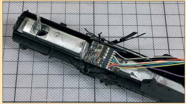
Der Freiraum ist so anzulegen, dass der Decoder Platz findet. Am Rand empfiehlt sich auch Raum für die Kabelführung zu schaffen.
