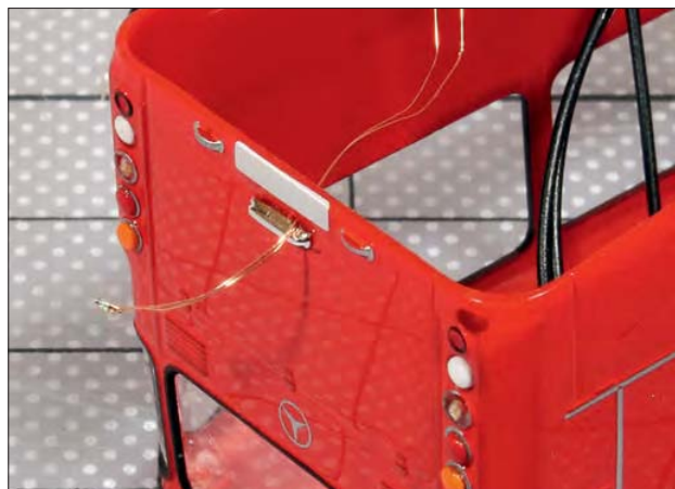
Mit winzigen SMD-LEDs wurden Nummernschildbeleuchtung und Rücklichter des Linienbusses versehen.
