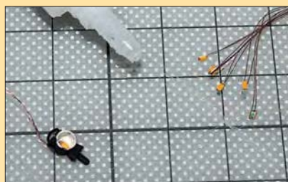
Nach dem weißen Anstrich des Innenraumes wurden LEDs und Kabel eingeklebt.
