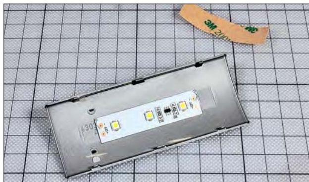
Die Lokalbahnwagen von Roco besitzen unterm Dach werksseitige Kontakte für Licht.
