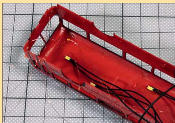
Mit winzigen SMD-LEDs wurden Nummernschildbeleuchtung und Rücklichter des Linienbusses versehen.
