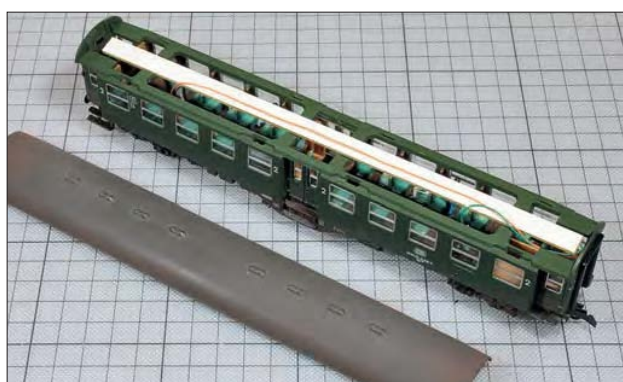
Im Falle des Umbauwagens von Roco wurde die LED-Leiste auf den Wagenkasten unterhalb des Daches geklebt.
