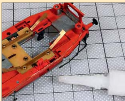
Mit Sekundenkleber werden die dünnen Litzen unter dem Umlauf festgeklebt.
