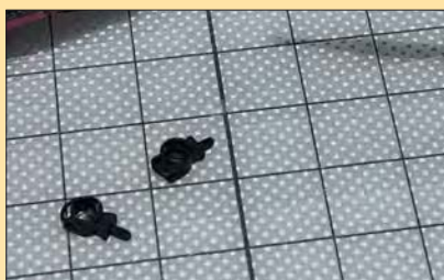
Die Laternen-Attrappen wurden ausgefräst, um die LEDs aufnehmen zu können.
