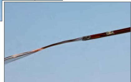
Flexible, teils selbstklebende LED-Bänder können an gebogene Körper geklebt werden. Es sind sehr kleine Bänder erhältlich aber auch größere mit unterschiedlichen Abständen zwischen den LEDs.
