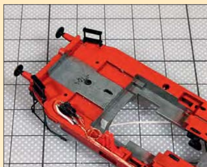
Eine kleine Steckverbindung unter dem Umlauf dient zur Demontage der Lok.
