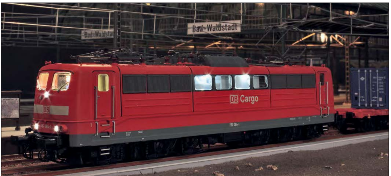
Neben der Beleuchtung des Maschinenraums (unten) sind bei der 151 von ESU zusätzliche Blitzeffekte im Maschinenraum installiert, die das Schaltwerk und den Hauptschalter parallel zum Sound mit Licht animieren.
