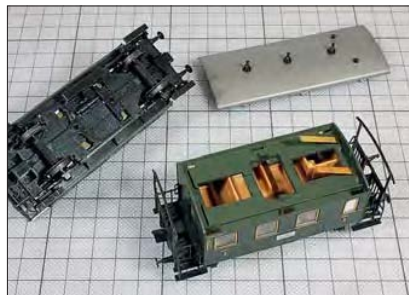
Die Lokalbahnwagen von Roco besitzen unterm Dach werksseitige Kontakte für Licht.
