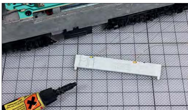
An die Imitation der Maschinenraumeinrichtung wurden zwei winzige, gelbe LEDs zur Beleuchtung geklebt. Die Kupferlitzen wurden durch Bohrungen auf die Rückseite geführt.
