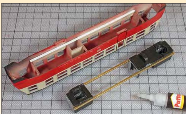
Eine Bemo V52 diente als Fahrwerk für den HSB-Triebwagen, wozu der Drehgestellabstand vergrößert werden musste. Dazu wurden die Enden des Rahmens an Messingprofile geklebt.
