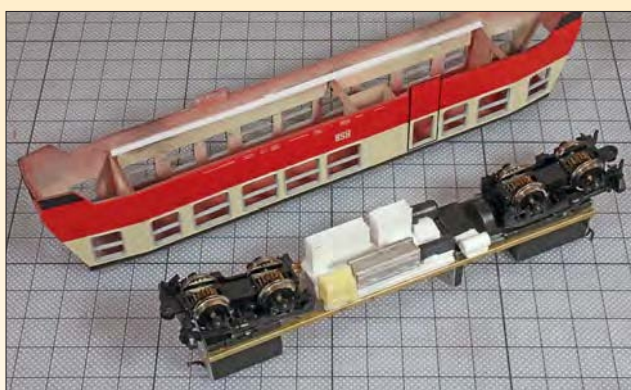
Antriebsattrappen oder Batteriekästen unter dem Wagenkasten wurden von unten nachgebildet. Hierfür wurden Kunststoffstücke und Teile aus der Bastelkiste verwendet.
