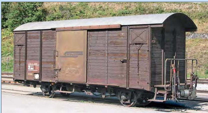
Der Gbv-k 5551 der RhB, hier im Sommer 2003 in Bergün aufgenommen, stammt aus der gleichen Serie wie der von BEMO zum Vorbild gewählte 5599. In dieser Form mit Stahlprofilaufbau besteht er seit 1982, andere Wagen der Serie wurden jedoch schon ab 1949 so umgebaut.
