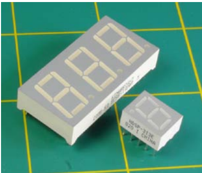
Abbildung 4-7. Sieben-Segment-Anzeigen sind die einfachste Möglichkeit, einen numerischen Ausgang darzustellen und können von einigen CMOS-Chips direkt angesteuert werden. Bei fertigen Geräten sitzen sie meist hinter transparenten roten Kunststoffscheiben.
