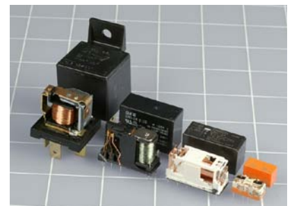
Abbildung 2-57. Vier verschiedene 12-Volt-Relais mit und ohne Gehäuse. Das Automobil-Relais (ganz links) ist das einfachste und leicht zu verstehen, weil es ohne große Rücksicht auf die Gehäusegröße gebaut wurde. Kleinere Relais sind raffinierter aufgebaut, komplexer und schwieriger zu verstehen. In der Regel (aber nicht immer) kann ein kleines Relais weniger Strom schalten als ein größeres.
