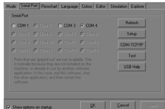
Abbildung 5-124. Noch ein Screenshot der Einstellungen zeigt die zweite wichtige vorzunehmende Auswahl: Du musst den COM-Port auswählen, den das Installationsprogramm auf deinem PC angelegt hat.
