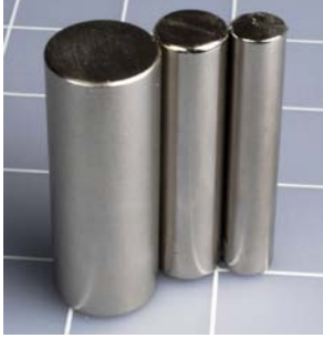
Abbildung 5-17. Drei Neodymmagneten mit 6, 12 und 18 mm Durchmesser. Ich wollte sie für das Foto in Abständen nebeneinander stellen, aber das ließen sie nicht mit sich machen.
