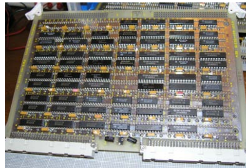
Abbildung 4-65. Der Bastler Bill Buzbee hat sich einen Webserver gebaut, der nur aus Logikchips der 7400er-Serie besteht, von denen der älteste 1969 hergestellt wurde. Der Webserver ist online unter http://magic-1.org zu finden, wo man entsprechende Bilder und Details seines Aufbaus sehen kann. Das Foto, das Bill geschossen hat, zeigt nur eine der Platinen dieses bemerkenswerten Projekts.
