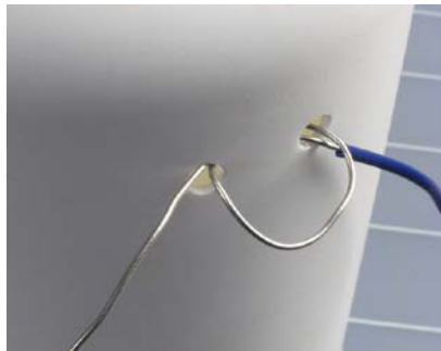
Abbildung 5-60. Das blanke Ende des Drahtes wird an den Löchern befestigt, die in die Flasche gebohrt wurden.
