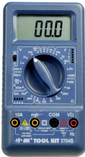
Abbildung 1-5. Wie du am Grad der Abnutzung erkennen kannst, ist dies mein bevorzugtes Multimeter. Es hat alle benötigten Grundfunktionen und kann auch Kapazität messen (der F-Bereich steht für Farad). Es ist außerdem zum Testen von Transistoren geeignet. Der Messbereich muss manuell eingestellt werden.
