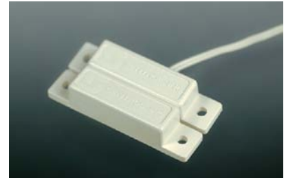
Abbildung 3-70. Bei diesem einfachen Alarmschalter enthält das untere Modul einen Magneten, der einen Reedschalter im oberen Modul öffnet und schließt.
