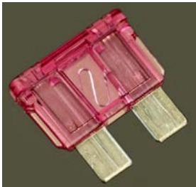
Abbildung 1-12. Eine 3-Ampere-Sicherung, wie sie in Autos gebraucht wird, hier größer abgebildet, als sie tatsächlich ist.
