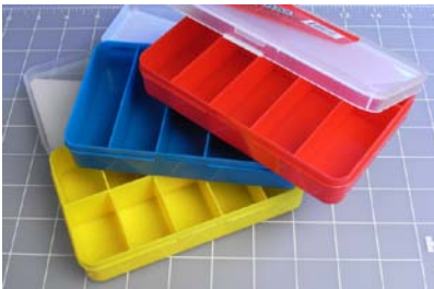
Abbildung 5-5. Für Bauteile wie Widerstände, Kondensatoren und Halbleiter eignen sich solche Boxen ideal. Man kann sie stapeln oder in Regalen aufbewahren und sie an der Kante beschriften. Hartnäckige Etiketten des Herstellers lassen sich nach dem Erhitzen mit einer Heißluftpistole problemlos abziehen.
