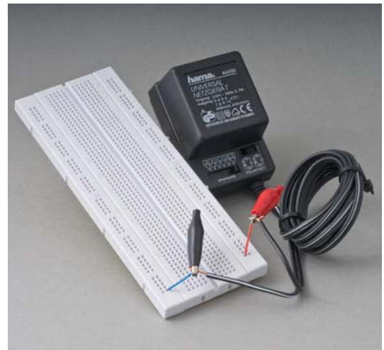
Abbildung 2-75. Wenn dein Steckbrett keine Schraubanschlüsse hat, stecke zwei kurze Drahtbrücken hinein, die du mittels Krokodilklemmen mit den Litzen des Netzteils verbindest.
