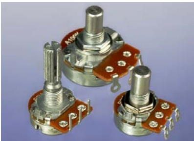
Abbildung 1-13. Potentiometer gibt es in verschiedenen Formen und Größen, mit verschiedenen Schaftlängen für verschiedene Drehknöpfe. Für unsere Zwecke ist die Bauart egal, aber die größeren Modelle sind einfacher zu handhaben.
