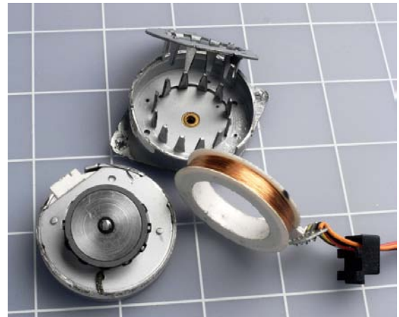
Abbildung 5-111. Wenn man das Gehäuse eines Schrittmotors öffnet, sieht es in etwa so aus. Links der Rotor des Motors, um den ein magnetisiertes Band herumläuft und der noch an der Unterseite des Gehäuses befestigt ist. Auf der rechten Seite siehst du die obere geöffnete Gehäusenhälfte, aus der die Spule entnommen wurde. (Die Windungen, die du sehen kannst, sind eigentlich zwei Spulen, die in unterschiedliche Richtungen gewickelt wurden.) Die Spitzen sind die Magnetkerne, die die Kraft auf den Rotor ausüben.
