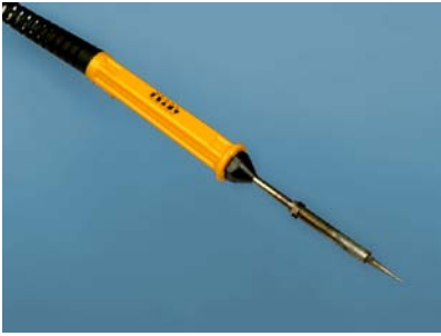
Abbildung 3-1. Dieser FeinlötKolben hat eine geringe Leistung. Daher kannst du ihn gefahrlos auch für empfindliche Bauteile benutzen. Die dünne Spitze hilft dabei, die Hitze an die richtige Stelle zu leiten
