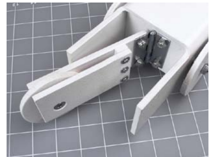
Abbildung 5-92. Eine Nahaufnahme des klappbaren Hinterrads, das sich frei drehen und mit minimaler Reibung von der einen Seite zur anderen klappen kann.
