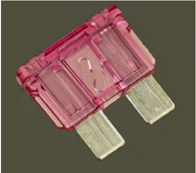
Abbildung 1-37. Dieselbe Sicherung, nachdem sie durch den elektrischen Strom geschmolzen ist.
