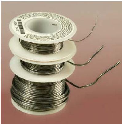
Abbildung 3-20. Rollen von Lötzinn in verschiedenen Dicken.
