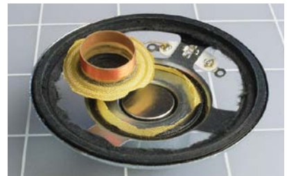
Abbildung 5-24. Die Spinne der Membran wurde herausgezogen. Du siehst die Spule aus Kupferdraht, die genau in die kreisförmige Vertiefung zwischen den zwei Magneten an der Unterseite des Lautsprechers passt.
