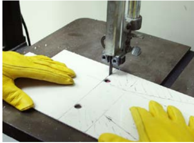
Abbildung 5-74. Eine Bandsäge ist das ideale Werkzeug, um komplexe Formen aus ABS-Kunststoff auszuschneiden. Man bekommt sie auch gebraucht für weniger als 150 Euro.
