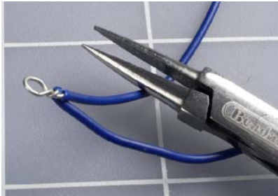
Abbildung 5-59. Jedes freigelegte Drahtstück wird mit einer Zange zu einer Öse gedreht.
