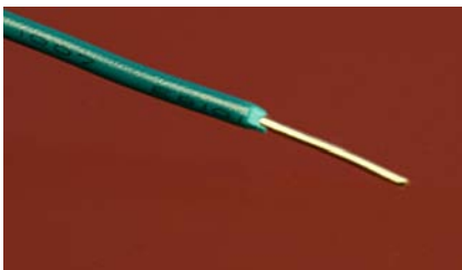
Abbildung 2-7. Starrer Draht mit 0,5 oder 0,6 mm Innendurchmesser eignet sich für fast alle Experimente in diesem Kapitel.
