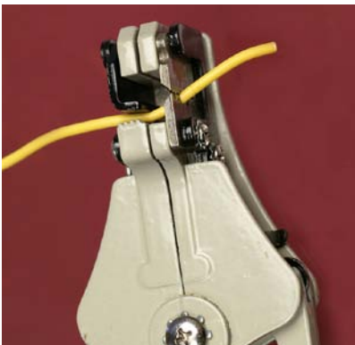
Abbildung 2-19. Wenn du bei einer automatischen Abisolierzange den Griff zusammendrückst, halten die Backen links den Draht fest und die scharfe Einkerbung rechts drückt sich in die Isolierung. Wenn du fester drückst, öffnet sich die Zange und zieht die Isolierung vom Draht ab.
