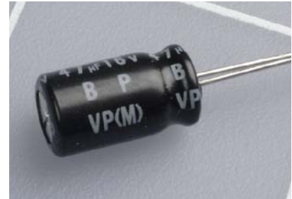
Abbildung 5-34. Ein bipolarer Elektrolytkondensator, auch als ungepolter Kondensator bezeichnet, sieht genau so aus wie ein Elko, weist aber den Aufdruck »NP« oder »BP« auf.
