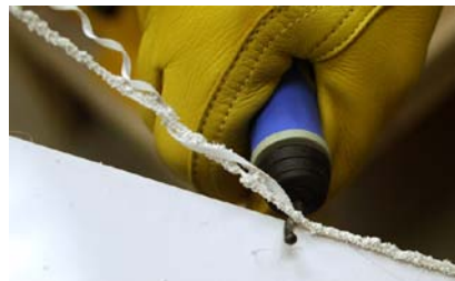
Abbildung 5-78. Ein Entgratwerkzeug bereinigt und schrägt die Kanten von Kunststoff mit einigen schnellen Zügen ab.
