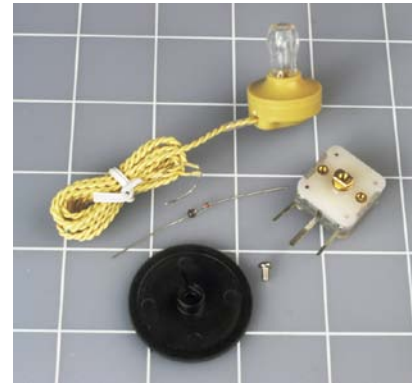
Abbildung 5-56. Du musst nur noch Draht und eine Spule hinzufügen: Mehr brauchst du nicht, um Mittelwellenradio zu empfangen. Die schwarze Scheibe wird auf den Drehkondensator (rechts) geschraubt und dient als Sendereinstellung. (Der Kondensator ist ein optionales Zusatzteil.) Eine Germaniumdiode (Mitte) sorgt für die Gleichrichtung des Signals. Der Ohrhörer (oben) hat eine hohe Impedanz und erzeugt kaum hörbare Töne.
