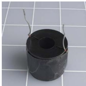
Abbildung 5-42. Welche exotischen Bauteile finden wir wohl in diesem hochwertigen Audio-Baustein, der in einem Subwoofer die hohen Frequenzen blockiert?
