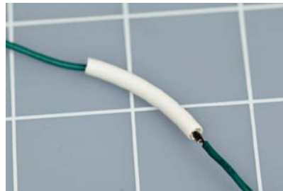
Abbildung 3-48. Schiebe den Schrumpfschlauch über die Lötstelle.
