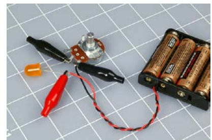
Abbildung 1-51. Die LED auf diesem Bild ist erloschen, weil ich das Potentiometer ein wenig zu weit aufgedreht habe.
