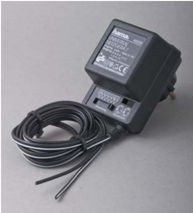
Abbildung 2-50. Dann entferne die Isolierung von den Drähten und kürze einen davon etwas mehr, damit sie sich nicht berühren können. Markiere den positiven Draht mit einem roten Filzstift.
