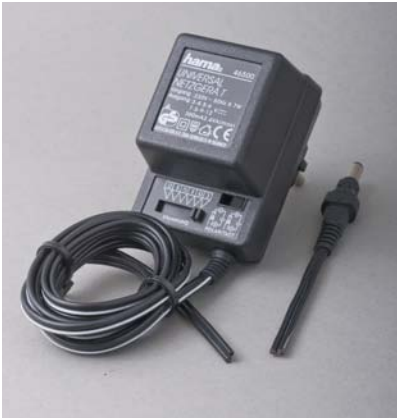
Abbildung 2-49. Vorbereitung des Universalnetzteils. Schneide erst einmal den kleinen Stecker ab und wirf ihn weg.
