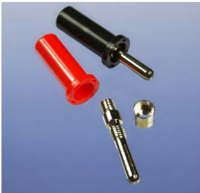
Abbildung 3-7. Um deine eigenen Klemmleitungen zu machen, befestige zuerst einen Bananenstecker an einem Draht, indem du den Draht durch die Hülle in das Loch an der Seite des Steckers führst.
