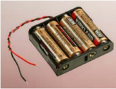
Abbildung 1-10. Batteriehalter für vier Mignonzellen in Reihe, liefert 6 Volt Spannung.
