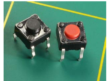
Abbildung 4-9. Ein Drucktaster hat einen spürbaren Druckpunkt, den man beim Drücken mit dem Finger spürt. Es sind fast immer einpolige Taster, die auf Platinen mit dem genormten Lochabstand von 1/10-Zoll passen.
