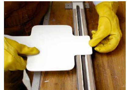
Abbildung 5-82. ABS lässt sich sauber und exakt biegen, wenn man den Kunststoff auf einen Bieger legt, der aus einem elektrischen Heizelement besteht.
