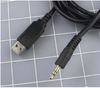
Abbildung 5-121. Das USB-Kabel für den PICAXE endet in einem 3,5-mm-Klinkenstecker. Diesen solltest du nicht in ein Audiogerät einstecken. Er stellt eine serielle Verbindung mit einem Computer her, so dass Programmcode in den Chip geladen werden kann.
