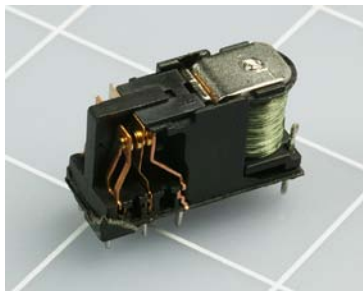
Abbildung 2-54. Wenn du sehr, sehr vorsichtig bist, sollte das Relais noch funktionieren, nachdem du es geöffnet hast.
