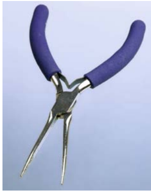
Abbildung 1-2. Eine Zange mit längeren Backen vereinfacht die Arbeit in Umgebungen, in denen nur sehr wenig Platz zur Verfügung steht.
