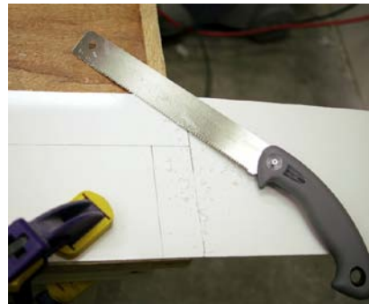
Abbildung 5-76. Diese Japansäge sägt auf Zug und nicht auf Druck. Wenn man damit Übung hat, kann man sehr genaue Schnitte hinbekommen. Weil ABS so weich ist, wird nur minimale Muskelkraft benötigt.
