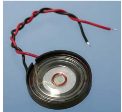
Abbildung 2-16. Dieser Mini-Lautsprecher hat einen Durchmesser von etwa einem Zoll (rund 2,5 \text{ cm} ) und kann für die Audioausgabe von Transistorschaltungen verwendet werden.
