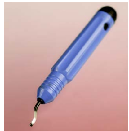
Abbildung 3-16. Diese clevere kleine Klinge mit einer runden Sicherheitskugel am Ende entgratet raue Sägekanten mit einem einzigen Zug und kann Löcher vergrößern, die nur fast groß genug sind.
