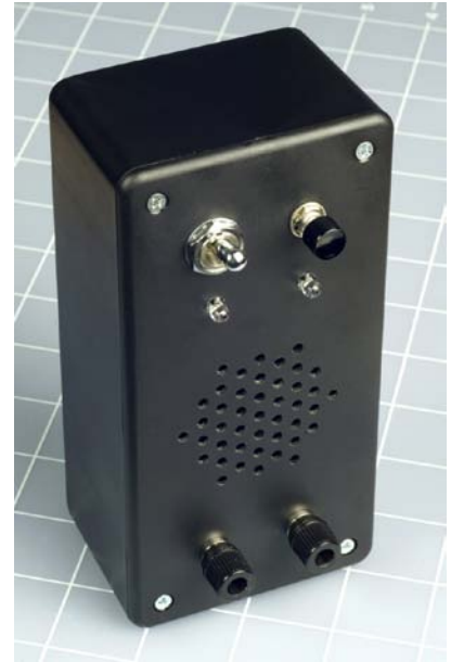
Abbildung 3-99. Die fertige Alarmanlage in ihrem Gehäuse.
