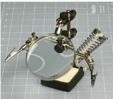
Abbildung 3-3. Die helfende Hand hat zwei Krokodilklemmen, die dein Werkstück festhalten. Die Metallspirale ist ein sicherer Platz, um einen heißen LötKolben abzulegen. Am Schwamm kannst du die Lötspitze abwischen.
