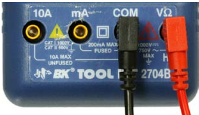
Abbildung 1-20. Um Widerstand und Spannung zu messen, steckt man das schwarze Kabel in die »COM«-Buchse und das rote Kabel in die Volt-Buchse. Fast alle Messgeräte verfügen über eine Extrabuchse für das rote Kabel für die Messung von hohen Stromstärken in Ampere, aber darum kümmern wir uns später.
