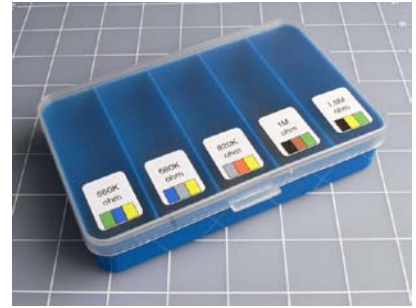
Abbildung 5-6. Damit Widerstände nicht versehentlich im falschen Fach landen, drucke den Farbcode auf jedes Etikett.
