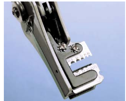
Abbildung 2-5. Diese automatische Abisolierzange kann mit nur einer Hand bedient werden, eignet sich aber nicht besonders für dünne Drähte. Sie sind in Deutschland nicht sonderlich verbreitet. Siehe Seite 44.
