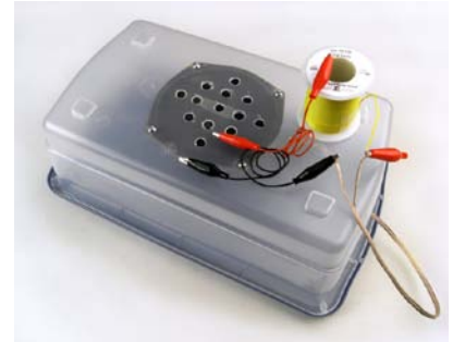
Abbildung 5-40. Die roten und schwarzen Krokodilklemmen, die auf der Box liegen, werden an den Ausgang des Verstärkerchips angeschlossen. Das rote Kabel leitet das Signal auf dem Weg zum Lautsprecher durch eine Spule aus Schaltdraht. Achte darauf, wie sich der Klang verändert, wenn du die Spule überbrückst.
