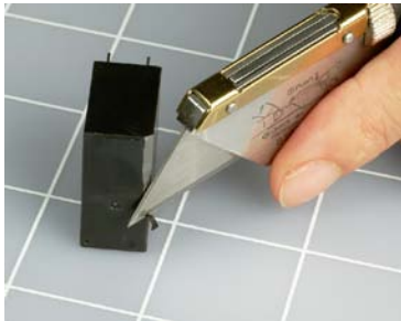
Abbildung 2-52. Um in ein vergossenes Relais hineinzuschauen, schäle die Kanten an der Oberseite des Kunststoffgehäuses mit einem Cuttermesser ab, bis du einen kleinen Spalt hast.
