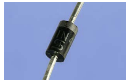
Abbildung 3-30. Diese 1N4001-Diode ist ungefähr 6 mm lang und kann bis zu 50 Volt aushalten.
