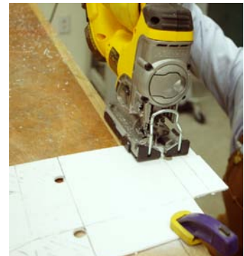
Abbildung 5-77. Diese Stichsäge kann in einem sehr langsamen Modus betrieben werden. Dadurch kann man in Kunststoff sehr genau arbeiten.
