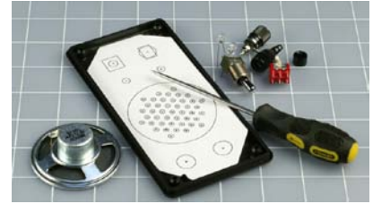
Abbildung 3-92. Der Ausdruck für die Anordnung der Schalter, LEDs und anderen Teile wurde auf der Innenseite des Gehäuses befestigt. Eine Ahle wird durch das Papier gedrückt, um das Zentrum jedes Lochs, das in den Deckel gebohrt wird, zu markieren.
