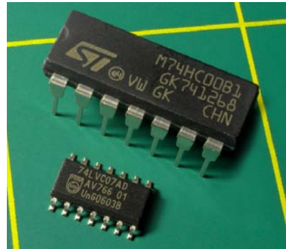
Abbildung 4-3. Der DIP-Chip hat an der Unterseite Pins, die einen Abstand von 0,1 Zoll (2,54 mm) haben, was genau in Steckbretter oder Lochrasterplatinen passt. Er kann ohne besonderes Werkzeug eingelötet werden. Der Chip zur Oberflächenmontage (SMD) hat ein SOIC-Gehäuse (»small-outline integrated circuit«) mit Lötflächen, die 0,05 Zoll Abstand haben. Andere SMD-Chips haben Abstände von 0,025 Zoll oder noch weniger (diese Größen werden oft in Millimeter angegeben). SMD-Chips sind hauptsächlich für die automatische Montage ausgelegt und sind von Hand nur schwer zu benutzen. In diesem Foto haben die gelben Linien einen Abstand von einem Zoll, um das Verhältnis zu verdeutlichen.
