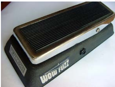
Abbildung 5-50. Dieses Wow-Fuzz-Pedal der Firma Vox war eines der ersten Bodeneffektgeräte, die ganz bewusst die Art von Verzerrung nutzten, die Tontechniker jahrzehntelang versuchen loszuwerden.
