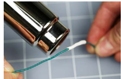
Abbildung 3-50. Füge Hitze hinzu, bis der Schlauch zusammenschrumpft und die Lötstelle fest umschließt.
