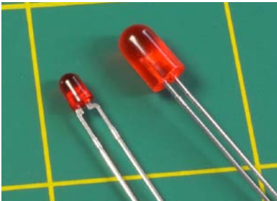
Abbildung 4-6. Ein Logikchip der HC-Serie kann an jedem Pin nur 4 mA liefern. Das ist zu wenig, um eine normale 5-mm-LED (rechts) zu betreiben, die einen Durchlassstrom von 20 mA hat. Kleine Low-Current-LEDs (links) brauchen mit einem geeigneten Vorwiderstand minimal 1 mA und sind ideal für Testschaltungen, in denen du Ausgangssignale einfach sichtbar machen willst.
