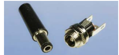
Abbildung 3-28. Die rechts abgebildete Buchse kann in ein Gehäuse montiert werden, um über den links abgebildeten Stecker Strom zu bekommen.
