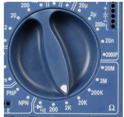
Abbildung 1-25. Um Ohm zu messen, stelle die Drehscheibe auf das Omega-Zeichen. Auf einem Multimeter mit Autorange-Funktion kannst du die »Range«-Taste wiederholt drücken, um verschiedene Widerstandsbereiche anzuzeigen, oder du hältst einfach die Messspitzen an einen Widerstand und wartest darauf, dass das Gerät automatisch einen Bereich wählt. Bei einem manuellen Multimeter musst du erst den Bereich mit dem Drehregler wählen. (Um den Hautwiderstand zu messen, solltest du es auf 100 k \Omega oder höher stellen). Wenn du keinen sinnvollen Wert erhältst, versuche einen anderen Messbereich.
