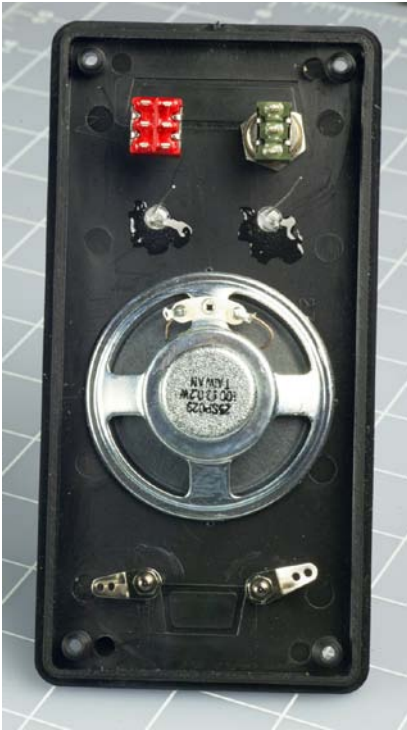
Abbildung 3-94. Die Bauteile des Schaltfelds wurden in das Gehäuse eingebaut (Ansicht von der Innenseite). Der Lautsprecher wurde an seinen Platz geklebt. Der restliche Klebstoff wurde auf die LEDs gestrichen. Der Ein-/Ausschalter ist oben rechts, der zweipolige Taster oben links. Die Polklemmen, die die Verbindung zum Verbund der Magnetschalter herstellen, sind ganz unten.
