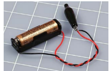
Abbildung 1-32. Das Kurzschließen einer Alkaline-Batterie ist ungefährlich, wenn du dich genau an die Anleitung hältst. Auch dann wird die Batterie aber so heiß, dass man sie nicht mehr anfassen kann. Versuche das nie mit einem Akku.
