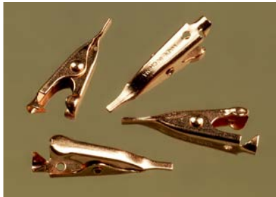
Abbildung 3-22. Diese kleinen Klammern absorbieren Hitze und schützen so die Bauteile beim Verlöten.
