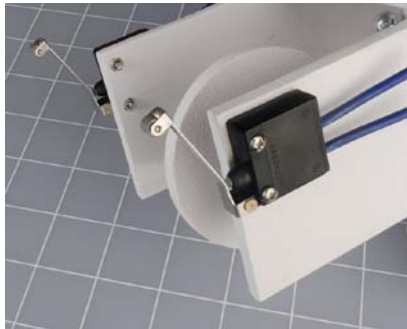
Abbildung 5-94. Auf jeder Seite des Wagens ist ein Mikroschalter mit Metallhebel befestigt, der jedes Hindernis erkennen kann.
