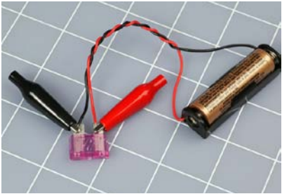
Abbildung 1-35. Sobald du beide Drähte anschließt, schmilzt das kleine S-förmige Teil fast sofort.
