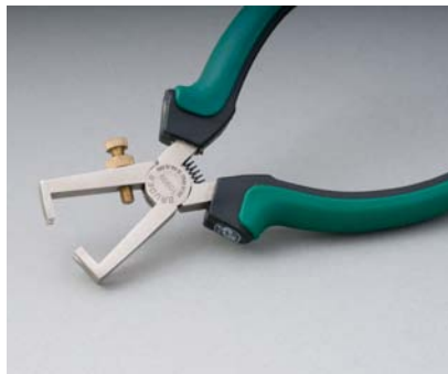
Abbildung 2-4. Bei dieser Abisolierzange legst du ein Stück isolierten Draht in das Loch mit der passenden Größe zwischen die Backen, drückst den Griff zusammen und ziehst das Stück Isolierung ab. Siehe Seite 45.
