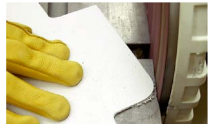
Abbildung 5-79. Ein Band- oder Tellerschleifgerät ist bei der Arbeit mit ABS-Kunststoff das ideale Werkzeug, um Ecken abzurunden.
