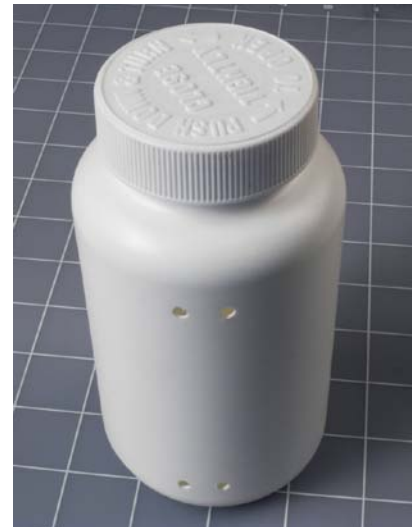
Abbildung 5-57. Eine große, leere Plastikflasche eignet sich ideal als Kern für die Spule eines Detektorradios. Die Löcher dienen der Befestigung des herumgewickelten Drahtes.
