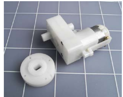
Abbildung 5-72. Für den kleinen Roboterwagen habe ich diesen 5-Volt-Motor gefunden, dem eine Scheibe beilag, die auf seine Achse passt. Das Set hat weniger als 10 Euro gekostet.
