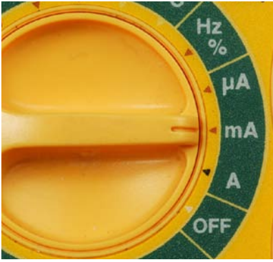
Abbildung 1-58. Bei jedem Multimeter wird die eingebaute Sicherung durchbrennen, wenn du damit eine zu große Stromstärke misst. In unserer Schaltung besteht das Risiko nicht, wenn das Potentiometer im mittleren Bereich bleibt. Stelle »mA« (Milliampere) ein und vergiss nicht, dass die angezeigte Zahl ein Tausendstel eines Amperes bedeutet.
