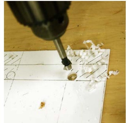
Abbildung 5-81. Wenn du an jeder Stelle, an der sich zwei Biegungen kreuzen, ein Loch bohrst, verringerst du die Gefahr, dass der Kunststoff Risse bekommt.
