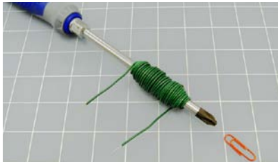
Abbildung 5-8. Jeder, der irgendwie als Kind dieses einfachste aller Experimente des Elektromagnetismus verpasst hat, sollte es einfach deshalb ausprobieren, um mit eigenen Augen zu sehen, dass eine einzelne Batterie eine Büroklammer bewegen kann.
