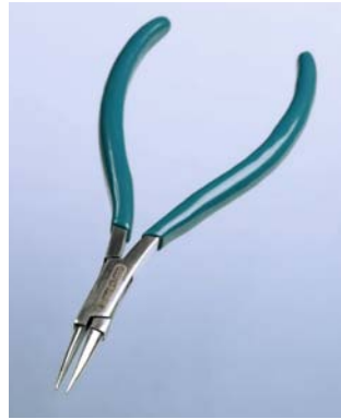
Abbildung 1-3. Spitzzangen sind bei der Schmuckherstellung beliebt, eignen sich aber auch dazu, winzige Bauteile festzuhalten.
