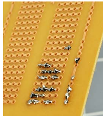
Abbildung 3-85. Nach dem Löten werden die Drähte gekürzt und die Lötstellen unter die Lupe genommen. Danach kommen die nächsten zwei oder drei Bauteile an die Reihe und immer so weiter.
