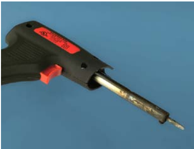
Abbildung 3-2. Dieser LötKolben mit mehr Leistung liefert die zusätzliche Hitze, die für dickere Drähte oder größere Bauteile gebraucht wird. Die Verfärbungen entstehen schnell durch den alltäglichen Gebrauch, haben aber keine Auswirkungen auf die Eigenschaften des LötKolbens, solange die Spitze sauber ist.
