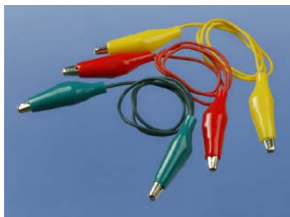
Abbildung 2-10. Verbindungskabel, auch Messleitungen genannt, bestehen aus Kabeln mit fest angebrachten Krokodilklemmen. Das ist ein weiterer kleiner Luxus, der Elektronik als Hobby stressfreier machen kann.
