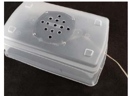
Abbildung 5-37. Bohre einige große Löcher in den Boden der Box und schraube den Lautsprecher fest. Das Kabel wird durch ein Loch herausgeführt. Setze den Deckel auf, dann hast du alles für nicht-ganz-Hifi-Sound.
