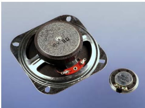
Abbildung 2-111. Der 2N2222-Transistor ist in der Lage, einen 3-Zoll-Lautsprecher zu betreiben, der sehr viel besser als ein 1-Zoll-Lautsprecher klingt.
