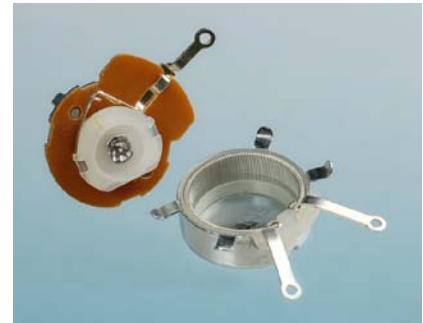
Abbildung 1-48. Um das Potentiometer zu öffnen, biege zunächst die vier kleinen Metallzungen nach außen. (In Abbildung 1-47 kannst du sie links und rechts heraus-schauen sehen.) Im Inneren befindet sich eine Drahtspule, die um ein Kunststoffband gewickelt ist, und ein Federkontakt, der den Strom von jeder Position auf der Spule ab- oder dorthin hinleitet, wenn man an der Achse dreht.
