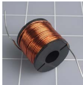
Abbildung 5-43. Nach der Entfernung des schwarzen Klebebands kommt eine Kupferspule zum Vorschein.
