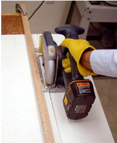
Abbildung 5-75. Eine Handkreissäge, die an einer geraden Schiene entlanggeführt wird, ist zum Schneiden von Kunststoff viel sicherer als eine Tischsäge und erzeugt dabei vergleichbare Ergebnisse.
