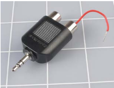
Abbildung 5-39. Um das Kopfhörersignal eines Musik-Players abzugreifen, kannst du solch einen Adapter benutzen, wenn du kein passendes Kabel und keine lötbare Klinkenbuchse hast. Dazu steckst du ein Stück Draht in eine der Buchsen. Mit Krokodilklemmen kannst du dann das Signal und die Masse (von der Außenseite der Buchse) an die Schaltung auf deinem Steckbrett anschließen. Weil wir nur einen Lautsprecher benutzen, wird der Verstärker nur mit einem der Stereoaufgänge verbunden, den anderen lassen wir einfach weg.
