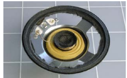
Abbildung 5-23. Die Membran wurde entfernt.
