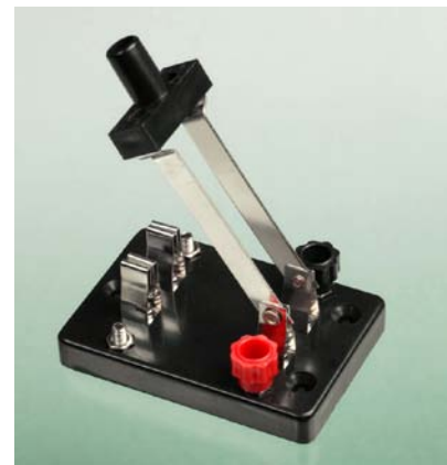
Abbildung 2-26. Ein zweipoliger Schalter schließt zwei unabhängige Ein-/Aus-Verbindungen.
