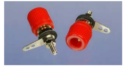
Abbildung 3-27. Diese Anschlüsse nennt man Polklemmen. Sie ermöglichen lötfreie Verbindungen mit Drähten, deren Enden abisoliert sind. Sie sind auch in anderen Farben erhältlich.
