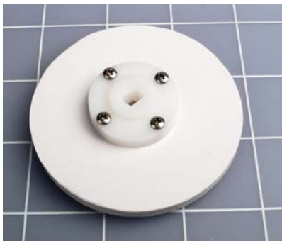
Abbildung 5-90. Ein Rad mit 8 mm Durchmesser wird an die Scheibe geschraubt, die auf die Achse des Motors passt.
