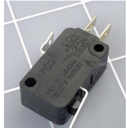
Abbildung 5-71. Ein Mikroschalter hat einen kleinen Taster (im Bild vorne rechts), der oft durch einen beweglich gelagerten Hebel ausgelöst wird. Der Schalter reagiert schon auf sehr leichten Druck, kann aber relativ hohe Ströme aushalten.
