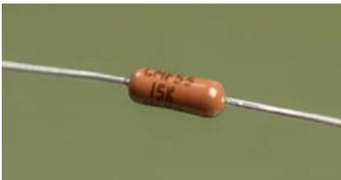
Abbildung 1-41. Bei einigen modernen Widerständen sind die Werte auch direkt aufgedruckt. Man kann sie zum Teil nur mit einer Lupe lesen. Dieser 15-k \Omega -Widerstand ist nur einen Zentimeter lang.
