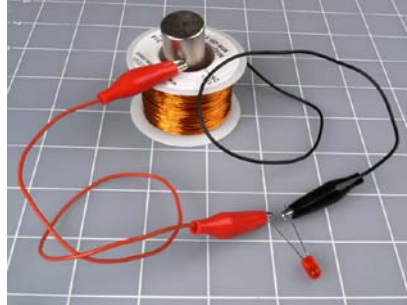
Abbildung 5-18. Indem man einen Magneten schnell durch das Zentrum einer Spule auf- und abbewegt, kann man genug Leistung erzeugen, um eine LED kurz blinken zu lassen.
