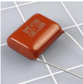
Abbildung 5-41. Es gibt auch unpolarisierter Kondensatoren, die nicht elektrolitisch sind, wie zum Beispiel dieser hochwertige Polyesterfilm-Kondensator. Sie sind aber sehr viel teurer und in Wertebereichen von 10 \mu\text{F} schwer zu finden.
