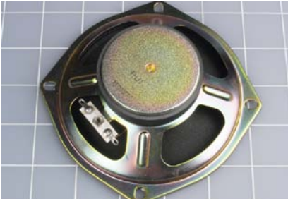
Abbildung 5-32. Um die Wirkung von Klangfiltern mit Spulen und Kondensatoren auch hören zu können, brauchst du einen Lautsprecher, der tiefere Frequenzen wiedergeben kann. Er sollte nicht kleiner sein als 12 cm.
