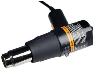
Abbildung 3-9. Die Heißluftpistole wird wie ein sehr starker Haartrockner benutzt. Sie gibt Hitze ab und mittels Schrumpfschlauch wird dann eine festsitzende Isolierung um den blanken Draht erzeugt.
