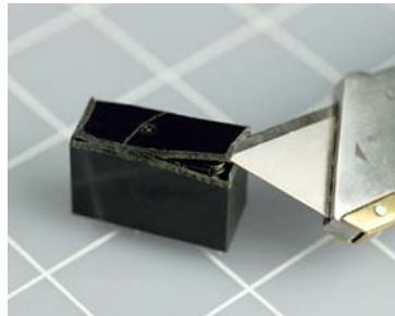
Abbildung 2-53. Stecke deine Messerklinge hinein, um den Deckel aufzubrechen, und wiederhole den Vorgang mit den Seiten.
