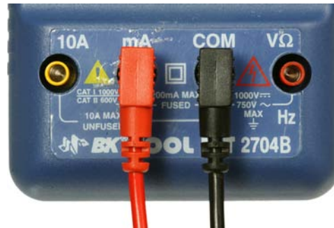
Abbildung 1-61. Bei einem manuellen Multimeter wie diesem hier musst du eventuell den roten Anschluss in eine andere Buchse stecken, um Milliampere zu messen. Bei den meisten modernen Geräten ist das aber nur nötig, wenn du sehr große Stromstärken messen willst.
