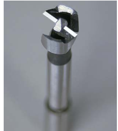
Abbildung 5-80. Ein Forstnerbohrer erzeugt saubere, genaue Löcher. Ein normaler größerer Bohrer bleibt in ABS-Plastik hängen und richtet ein Chaos an.
