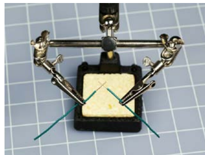
Abbildung 3-31. Die helfende Hand hält hier zwei Drähte, deren blanke Enden sich berühren. Die Lupe ist weggedreht, damit sie nicht im Weg ist.
