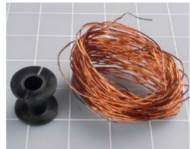
Abbildung 5-44. Die Spule der Frequenzweiche besteht aus einer Kunststoffrolle und Draht, sonst nichts.
