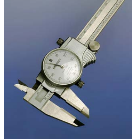
Abbildung 3-19. Es gibt digitale Messsschieber (die automatisch zwischen Einheiten umrechnen können) und Messsschieber in analoger Form wie im Bild gezeigt (nie wieder Probleme mit leeren Batterien).
