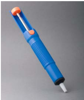
Abbildung 3-10. Um eine Lötstelle zu entfernen, kannst du das Lötzinn erhitzen, bis es flüssig ist, und dann mit so einer Entlötsaugpumpe aufsaugen.
