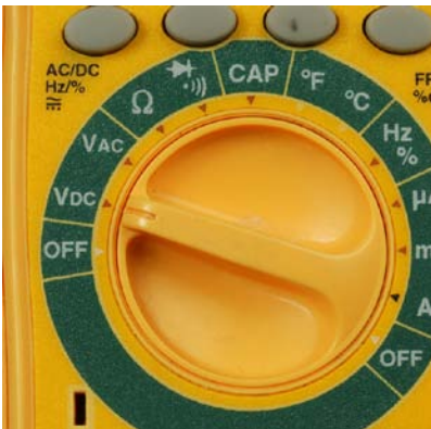
Abbildung 1-54. Bei jedem Multimeter misst man Gleichspannung etwas anders. Beim manuellen Gerät (oben) muss man den Schalter auf »DC« (Gleichstrom) stellen und dann die höchste zu messende Spannung einstellen: In diesem Fall ist 20 ausgewählt (da 2 zu wenig wäre). Bei dem Autorange-Messgerät stellt man den Schalter einfach auf »V« und das Multimeter findet den Messbereich selbst heraus.
