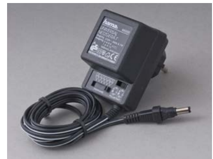
Abbildung 2-1. Dieses Steckernetzteil liefert eine Gleichspannung zwischen 3 und 12 Volt und ist ideal für Elektronikprojekte.
