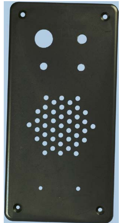
Abbildung 3-93. Die Außenseite der Frontplatte nach dem Bohren. Mit einem kleinen Handbohrer kann man gute Ergebnisse erzielen, wenn die Löcher gut markiert waren.
