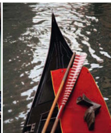
Riemen und Forcola. GUT ZU WISSEN: Seeleute und Wassersportler sprechen von ‚Riemen‘ statt ‚Ruder‘. Der Ausdruck Ruder gilt unter ihnen als laienhaft und gibt den Sprecher als ‚Landratte‘ zu erkennen.
