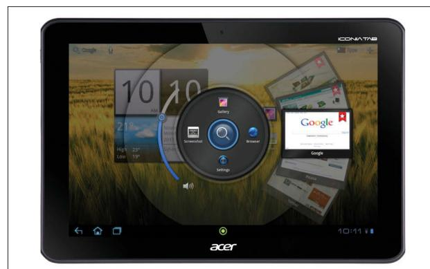
Ring-UI: Acer's Userinterface lässt sich mit dem ringförmigen Hardwareknopf über dem Acer-Schriftzug am unteren Gehäuserand aufrufen.
