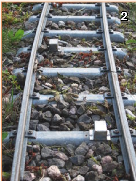
Praktische Ausführung der vergossenen Reedkontakte
